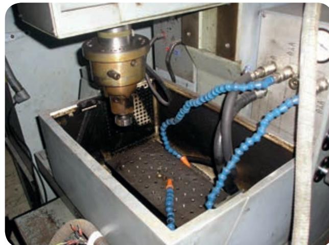
نمونه‌ای از ماشین CNC EDM
