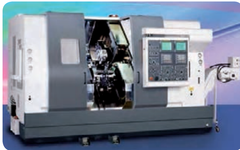
دستگاه تراش CNC با کنترل زیمنس
