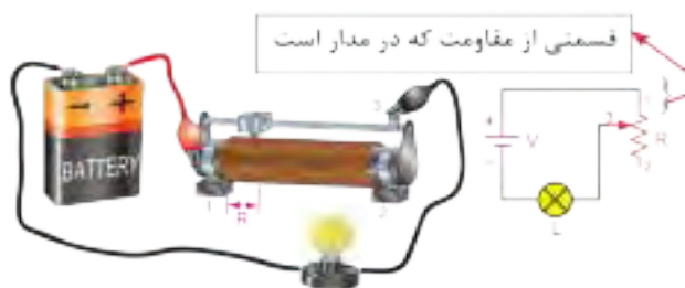
الف - مقاومت رئوستا کم و لامپ پرنور است.
