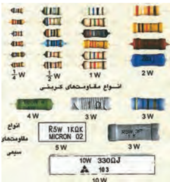
شکل ۱۷-۶- استانداردهای توان در مقاومت ها
