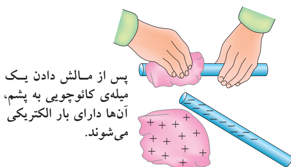
شکل ۱۸-۳- الکتریسیته مالشی (اثر تریبو الکتریک)
