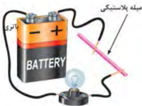
شکل ۲-۶- عدم انتقال الکترون ها در یک میله پلاستیکی
