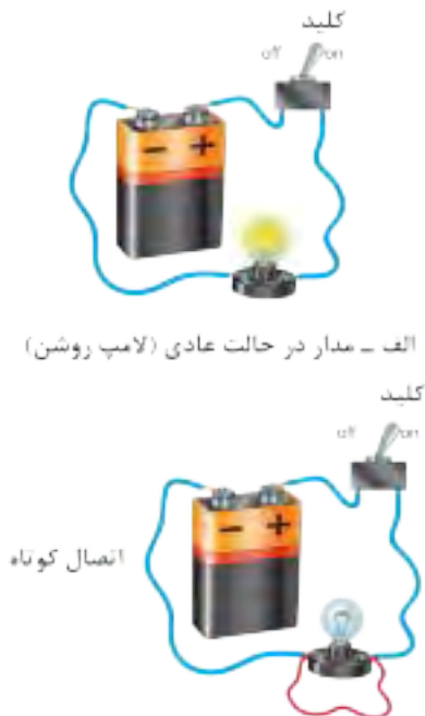
ب - مدار در حالت اتصال کوتاه (لامپ خاموش) عبور جریان بسیار زیاد است. شکل ۴-۲۱
