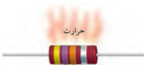
شکل ۳-۶۴- مقاومت اهمی (R)
