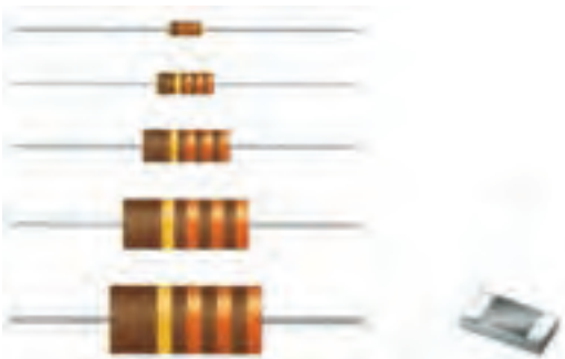
الف) مقاومت لایه کربن ب) مقاومت لایه فلز
