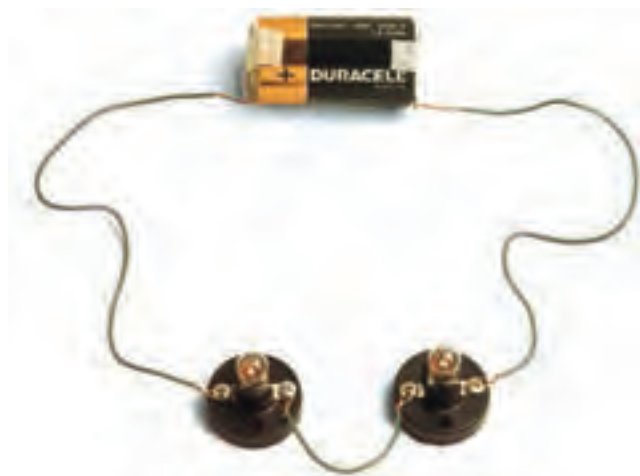
شکل ۵-۳- مدار واقعی دو لامپ به صورت سری
