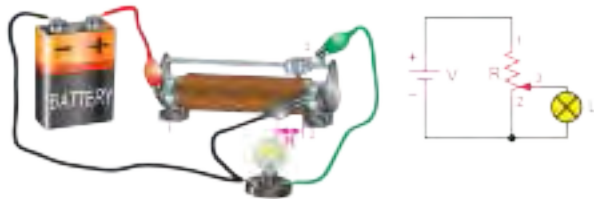
ب - مقاومت پتانسیومتر کم و نور لامپ کم
