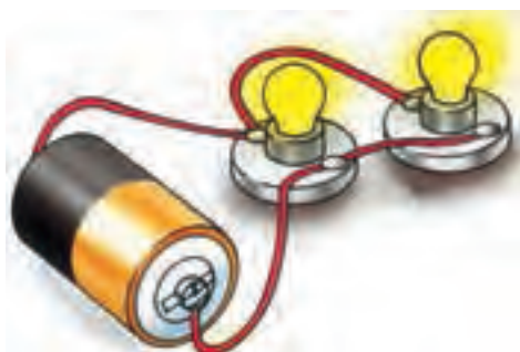
شکل ۵-۶۳ - اتصال دو لامپ به صورت موازی
