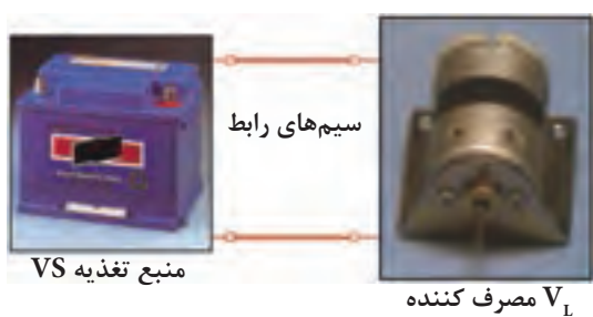
شکل ۵-۹۶ افت ولتاژ بین مولد و مصرف کننده
