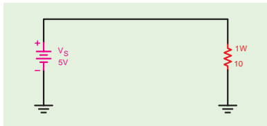
شکل ۶-۱۶- بررسی جریان مصرف کننده براساس توان مجاز
