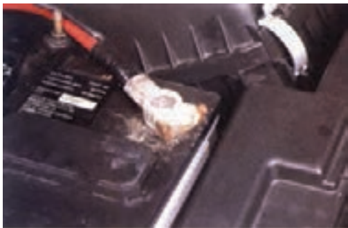
شکل (۲-۸۱) سولفاته شدن بست باتری
