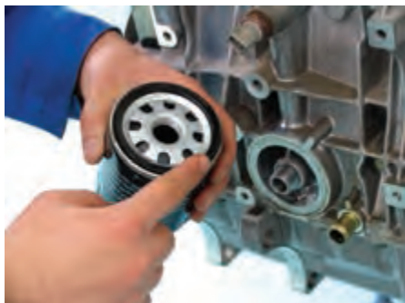
شکل (۲-۵۳) کنترل دندانان و واشر لاستیکی فیلتر
