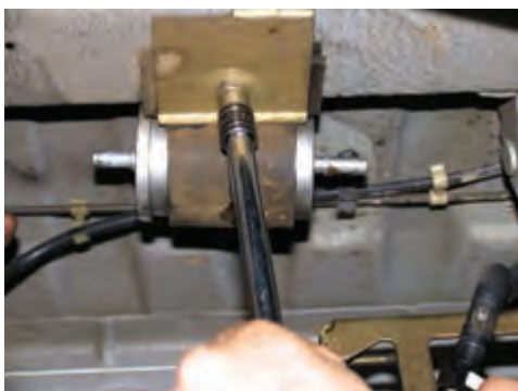
شکل (۲-۶۸) نصب فیلتر جدید
