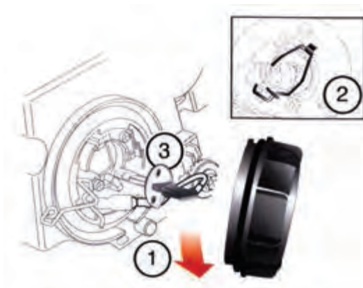
شکل (۲-۹۴) تعویض لامپ چراغ جلو نور بالا
