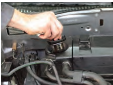
شکل (۴۵- ۲) بازکردن در قالباق موتور
