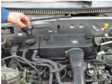
شکل (۲-۵۰) بازکردن درب قالباق موتور
