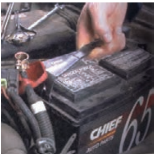
شکل (۲-۸۳) خارج کردن باتری
