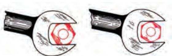
شکل ۱-۳) استفاده‌ی اصولی از ابزار
