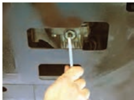
شکل (۲-۷۰) پیچ تخلیه ی روغن جعبه دنده
