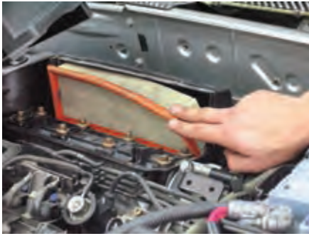
شکل (۲-۶۴) پیاده کردن فیلتر هوا
