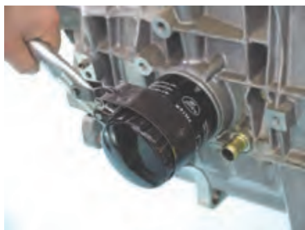
شکل (۴۸- ۲) بازکردن فیلتر با ابزار مخصوص
