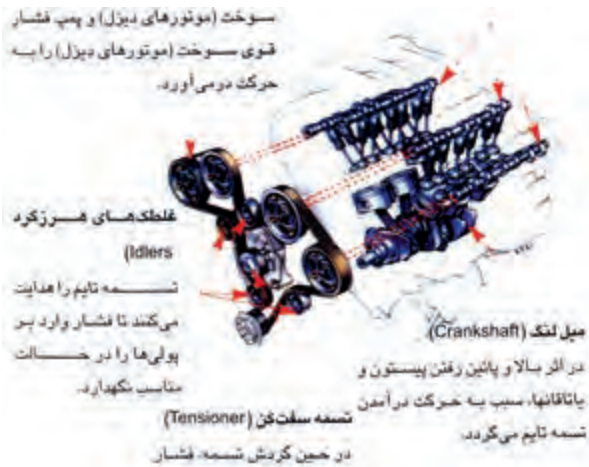
شکل (۱۳-۲ الف) تسمه تایمینگ موتور
