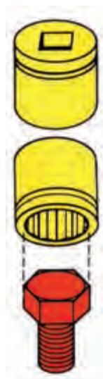
شکل (۱-۱۷) نحوه درگیری آچار بوکس
