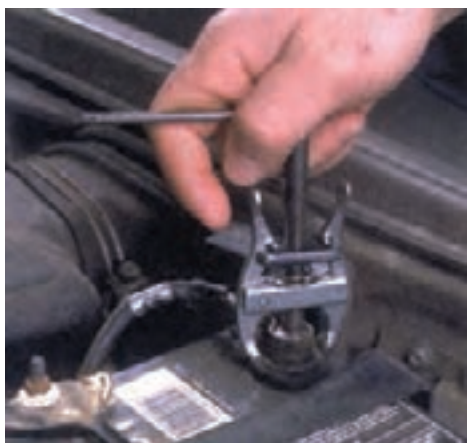
شکل (۲-۸۲) باز کردن بست باتری
