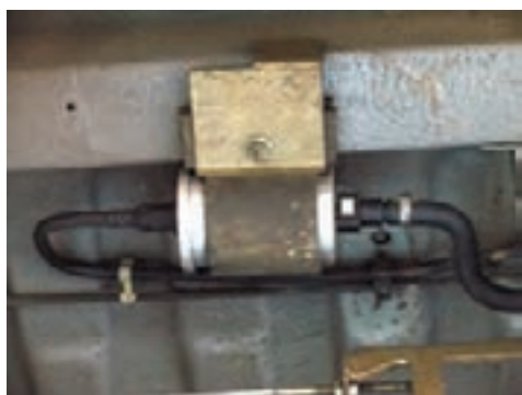
شکل (۲-۶۷) بست های دوطرف فیلتر سوخت
