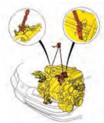
شکل (۱-۴۲) اتصالات پیاده کردن موتور از روی خودرو
