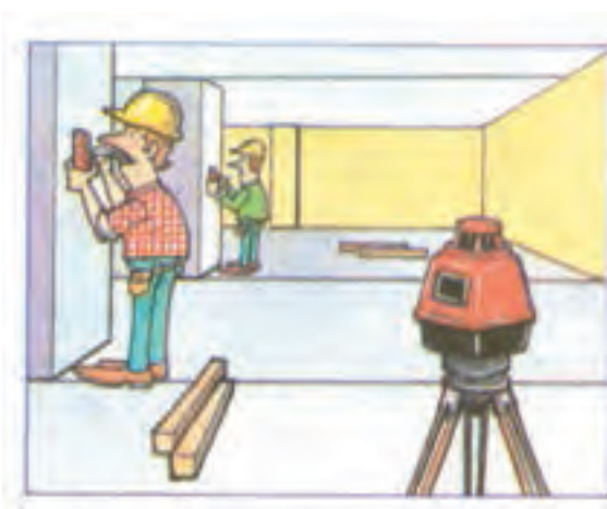
شکل ۴۸-۸ کاربرد تراز یابی «خط تراز در ساختمان»
