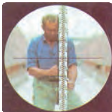
شکل ۱۴-۸ — طریقه‌ی نگاه داشتن میر
