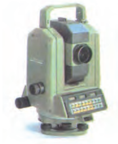
شکل ۴-۲۴- فاصله‌یاب در داخل دوربین نقشه‌برداری
