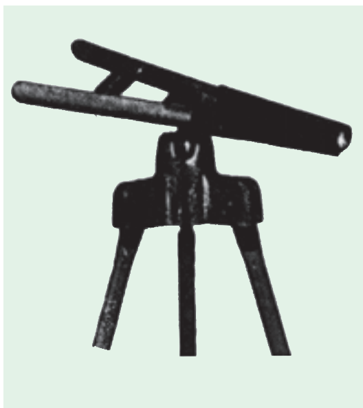
شکل ۳-۳ ژالون گیر و نحوه‌ی به کارگیری آن
