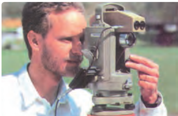
شکل ۴-۲۳- نصب فاصله‌یاب روی دوربین
