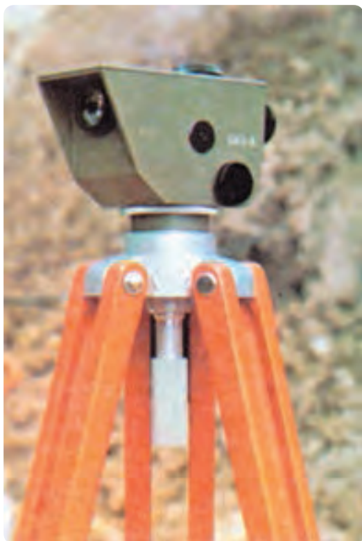
شکل ۱۰-۸- یک تراز یاب ساختمانی
