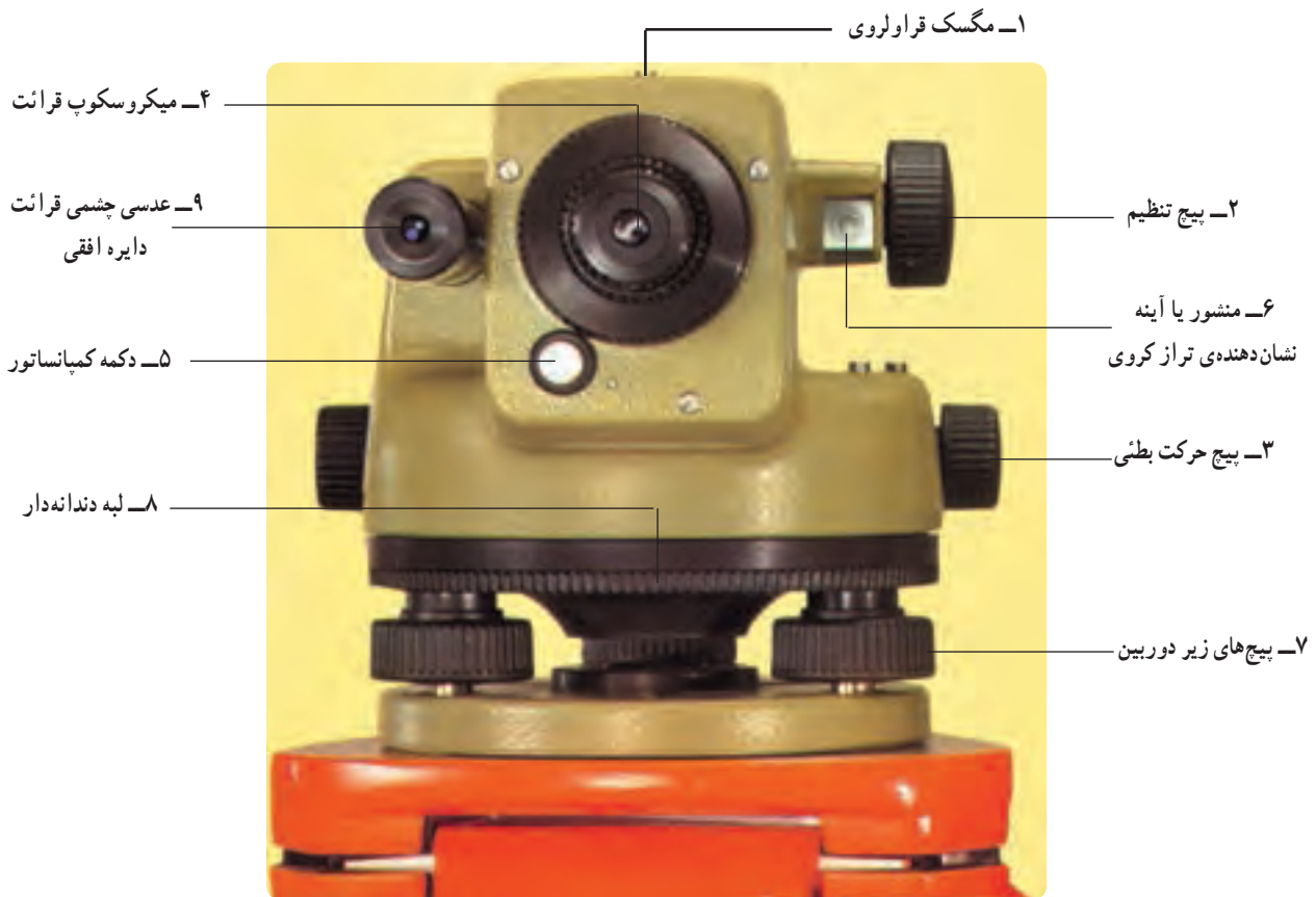
شکل ۸-۹- قسمت‌های ظاهری یک تراز یاب
