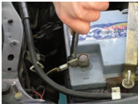
شکل ۲-۹۸ بازکردن بست اتصال ترمینال منفی باتری
