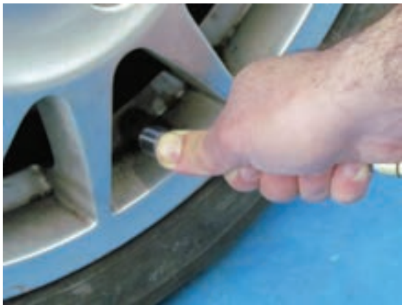
شکل ۲-۱۶۵ اتصال فشارسنج به تایر
