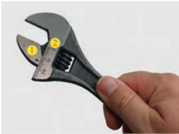
شکل ۱-۹۲ آچار فرانسه مدرج. ۱- فک متحرک، ۲- فک ثابت مدرج
