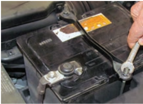
شکل ۲-۱۱۳ بستن بست نگهدارنده باتری
