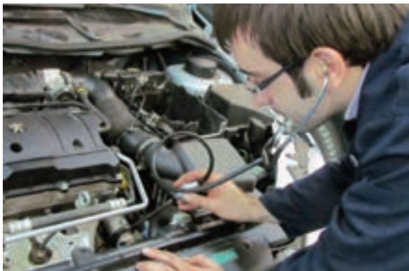
شکل ۱-۲۲۳ کاربرد گوشه تقویت صدا برای عیب‌یابی قطعه
