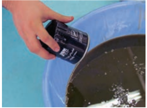
شکل ۲-۴۳ تخلیه روغن داخل فیلتر روغن
