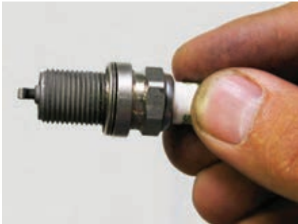
شکل ۹۳-۲ بررسی شمع پس از استفاده از دستگاه شمع پاک‌کن
