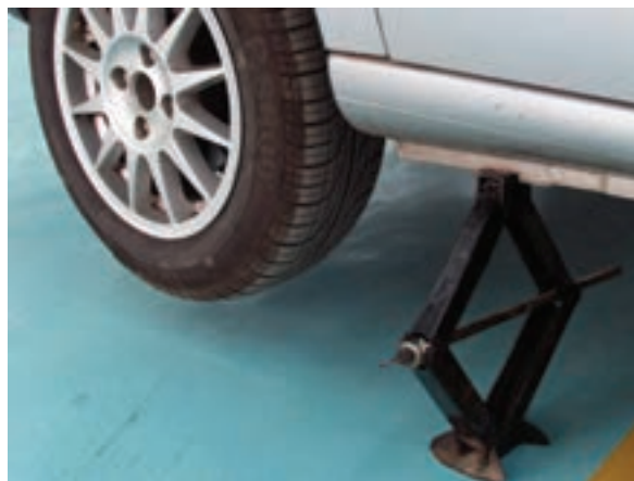
شکل ۱-۲۰۸ یک نوع جک مکانیکی (خاص خودرو)
