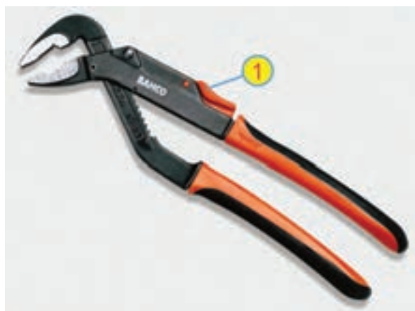
شکل ۱-۱۳۷ انبر کلاغی ضامن‌دار. دکمه ضامن شماره ۱ حرکت فک متحرک را کنترل می‌کند.
