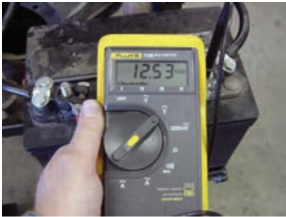
شکل ۲۶۶-۱ کاربرد مولتی متر برای تعیین شدت جریان باتری ۱۲ ولتی خودرو
