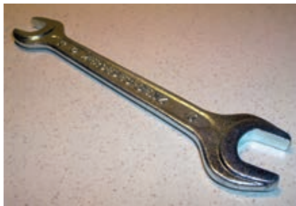
شکل ۱-۴ آچار تخت دوسر تخت میلی‌متر با ضخامت دهانه بیشتر
