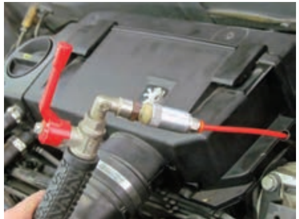
شکل ۲-۳۵ بازکردن شیر اصلی و دستگاه ساکشن
