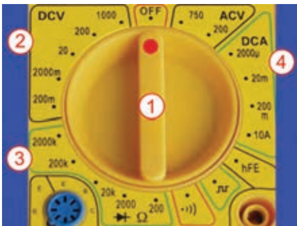
شکل ۲۶۸-۱ حوزه های کاری مولتی متر ۱. سلکتور یا کلید انتخاب حوزه کاری ۲. حوزه کاری اندازه گیری ولتاژ جریان مستقیم ۳. حوزه کاری اندازه گیری مقاومت جریان DC ۴. حوزه کاری اندازه گیری شدت جریان DC
