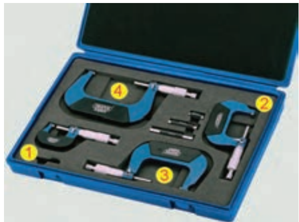
شکل ۱-۲۳۴ میکرومتر نوع میلی متری. ۱. اندازه گیر صفر تا ۲۵ ۲. اندازه گیر ۲۵ تا ۵۰. ۳. اندازه گیر ۵۰ تا ۷۵. ۴. اندازه گیر ۷۵ تا ۱۰۰
