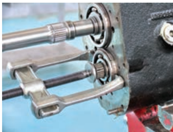
شکل ۱-۱۹۶ کاربرد پولی کش برای خارج کردن بلبرینگ روی محور جعبه دنده
