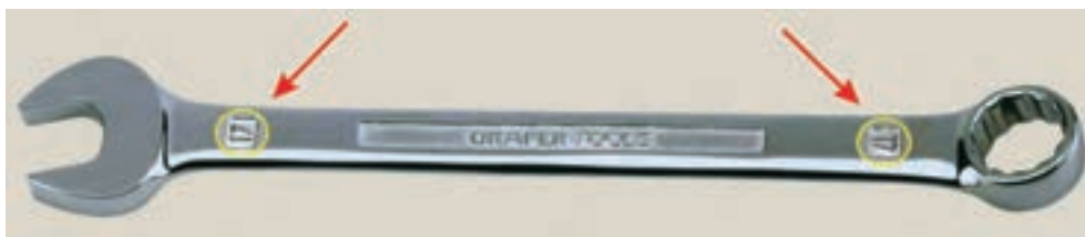
شکل ۱-۳۰ آچار ترکیبی یکسر رینگی - یکسر تخت، فلشها اندازه دهانه های آچار را نشان می دهد.
