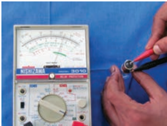
شکل ۲-۱۵۵ آزمایش لامپ چراغ خطر
