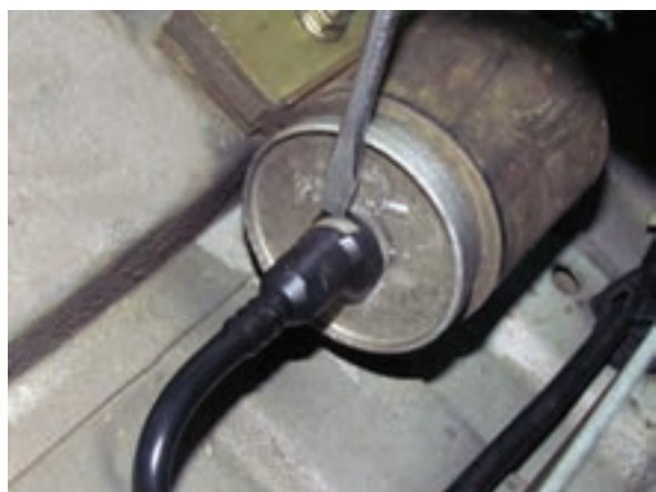
شکل ۲-۶۸ آزاد کردن ضامن شیلنگ خروجی
