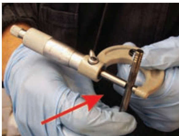
شکل ۱-۲۴۲ اندازه‌گیری قطر ساقه سوپاپ
