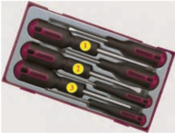
شکل ۱-۱۰۴ مجموعه پیچ‌گشتی دو و چهارسو (شماره ۱، ۲ و ۳ دارای مقطع میله شش‌گوش است)
