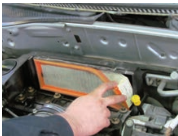
شکل ۲-۱۱ خارج کردن فیلتر هوا
