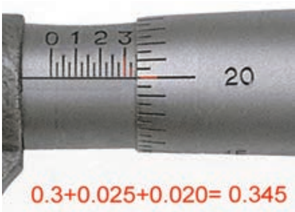
شکل ۱-۲۳۹ نحوه خواندن میکرومتر
