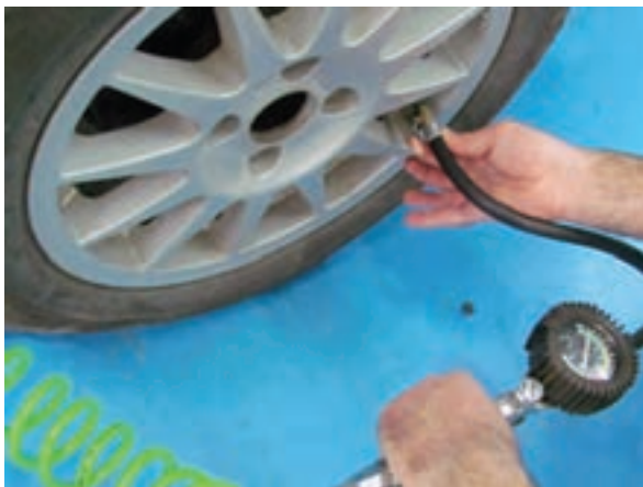
شکل ۲-۱۶۷ افزودن هوای فشرده به تایر
