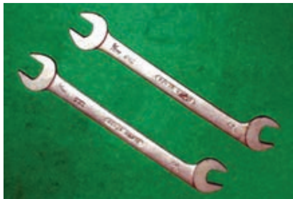
شکل ۱-۶ آچار دوسر تخت با انحراف دهانه ۳۰ درجه
