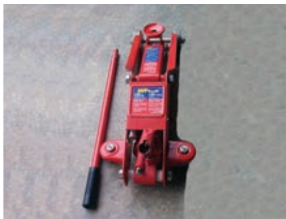
شکل ۱-۲۰۶ جک سوسماری در اندازه کوچک
