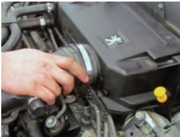
شکل ۲-۲۰ جازدن لوله مکندۀ هوا
