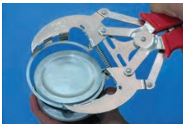
شکل ۱-۱۸۱ طرز کار رینگ بازکن
