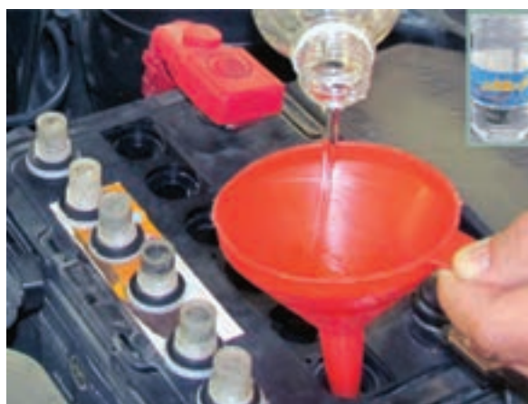
شکل ۲-۱۱۰ جبران کاهش سطح الکترولیت با آب مقطر
