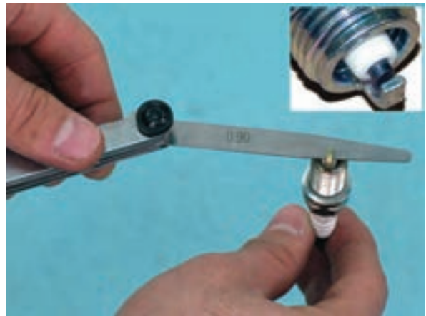
شکل ۱-۱۷۰ فیلرگیری دهانه شمع
