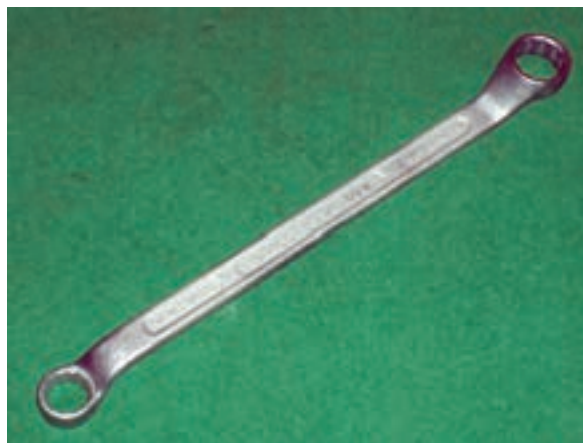
شکل ۱-۱۸ آچار رینگی سر کج برای مواضع کم عمق
