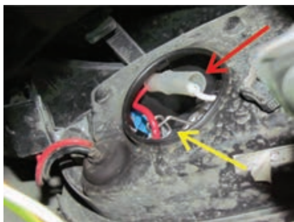
شکل ۲-۱۴۵ اتصال الکتریکی و میله فنری نگهدارنده لامپ
