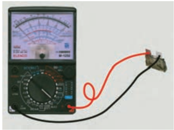
شکل ۲۶۵-۱ کاربرد مولتی متر برای آزمایش سالم بودن فیوز
