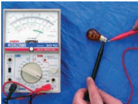
شکل ۲-۱۵۷ آزمایش لامپ چراغ راهنما
