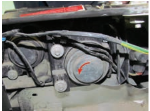
شکل ۲-۱۱۸ بازکردن قاب چراغ
