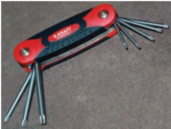
شکل ۱-۱۰۶ یک‌نوع دسته پیچ‌گشتی چندپارچه
