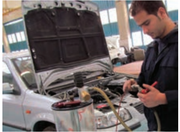
شکل ۲-۳۱ اتصال لوله رابط
