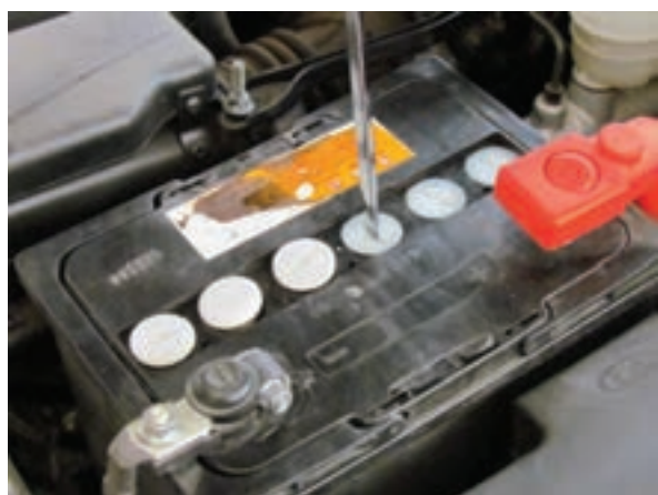
شکل ۲-۱۱۱ بستن درپوش خانه‌های باتری
