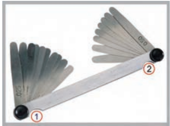
شکل ۱-۱۶۸ فیلر میلی متری - اینچی، ۱. فیلر اینچی، ۲. فیلر میلی متری
