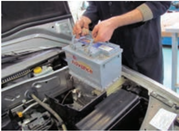
شکل ۲-۱۰۱ خارج کردن باتری از خودرو
