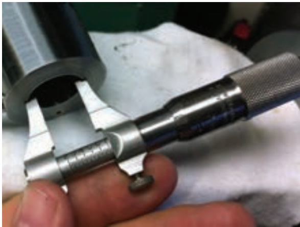
شکل ۱-۲۴۷ کاربرد میکرومتر اندازه‌گیر دهانه داخلی
