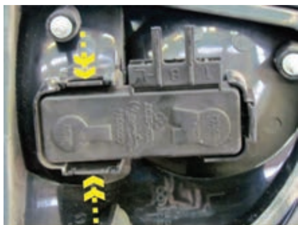
شکل ۲-۱۵۱ خارج کردن پایه لامپ‌ها
