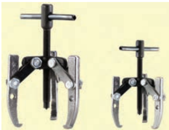
شکل ۱-۱۹۳ پولی کش سه شاخه در دو نوع اندازه
