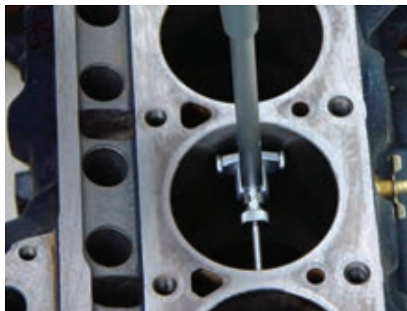
شکل ۱-۲۵۴ نحوه قرار گرفتن ساعت اندازه گیر درون سیلندر
