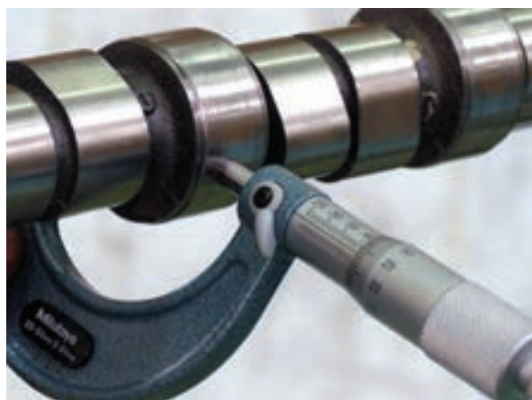
شکل ۱-۲۴۳ اندازه‌گیری قطر یاتاقان ثابت میل بادامک
