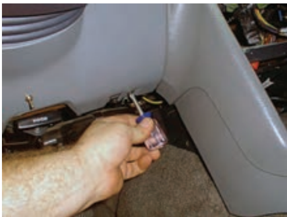
شکل ۱-۱۰۸ کاربرد آچار پیچ‌گشتی چهارسوی مشتکی
