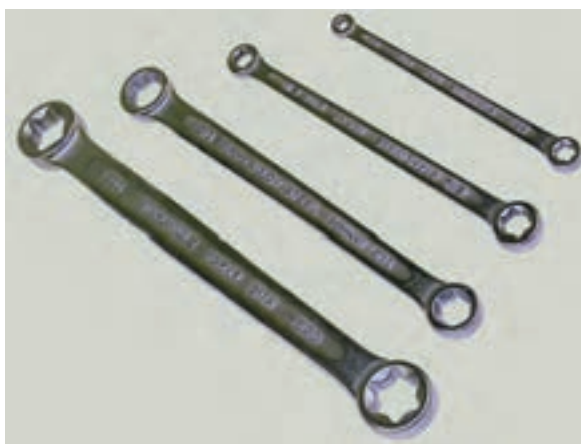
شکل ۲۲- آچار دو سر رینگ شش شیاره تخت
