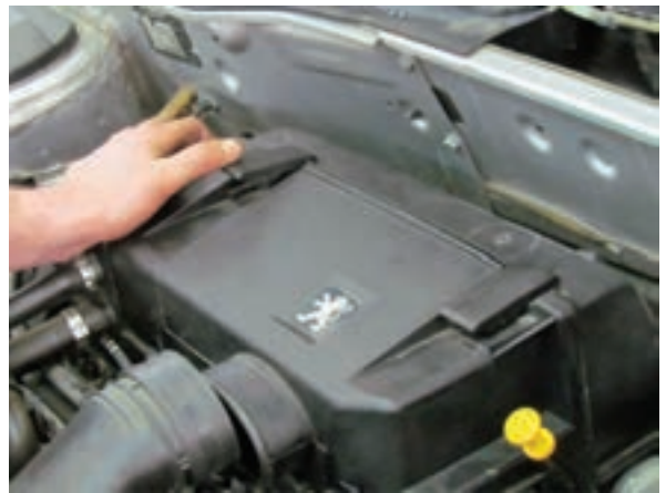
شکل ۲-۱۹ بستن بست نگهدارنده قاب
