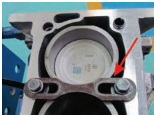
شکل ۱-۲۷۲ کاربرد بوش بند برای ثابت نگه داشتن بوش ها درون بلوکه سیلندر
