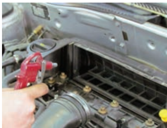
شکل ۲-۱۳ تمیز کردن گردوغبار محل نصب فیلتر هوا
