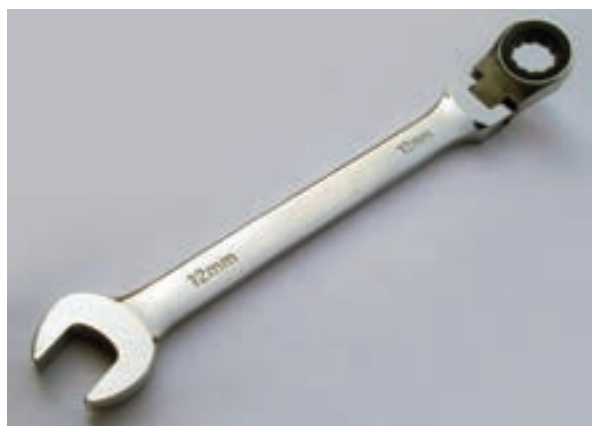
شکل ۱-۳۴ آچار ترکیبی یکسر تخت - یکسر رینگی متحرک، میزان انحراف رینگی ۱۵ درجه نسبت به محور دسته آچار است.
