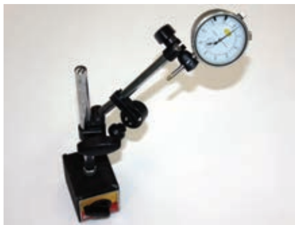
شکل ۱-۲۵۰ ساعت اندازه‌گیر با پایه و میله رابط آن
