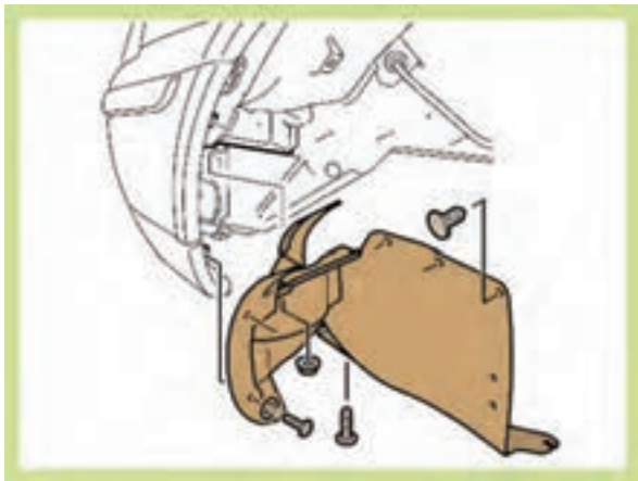
شکل ۲-۵۴ شماتیک گلگیر پلاستیکی چرخ سمت چپ
