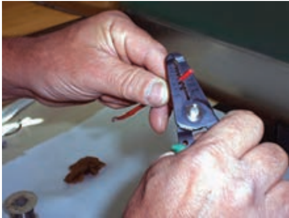
شکل ۱-۱۵۳ انبر سیم لخت کن و عملکرد آن
