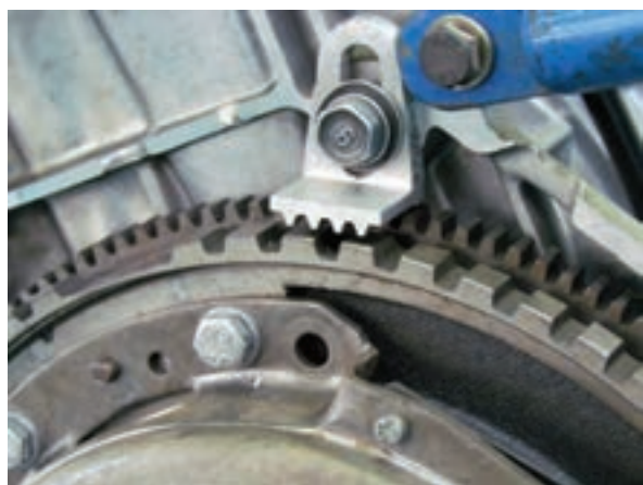
شکل ۱-۲۷۰ کاربرد قفل کن فلاپیول برای کنترل و ثابت نگه داشتن آن
