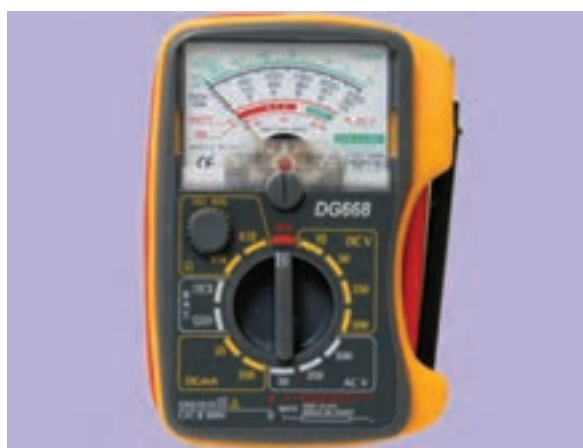
شکل ۱-۲۶۳ یک نوع مولتی متر عقربه ای (آنالوگ)
