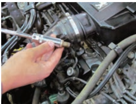
شکل ۲-۹۰ خارج کردن شمع از محل خود
