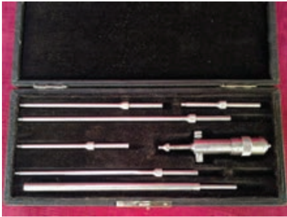
شکل ۱-۲۴۵ مجموعه میکرومتر داخل سنج
