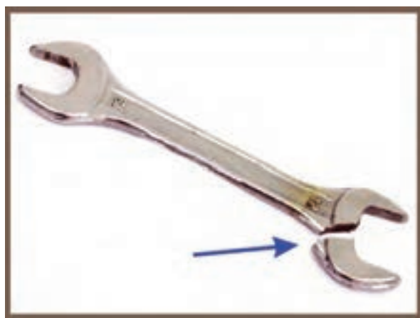
شکل ۱-۱۶ شکستن دهانه آچار در اثر نیروی بیش از حد
