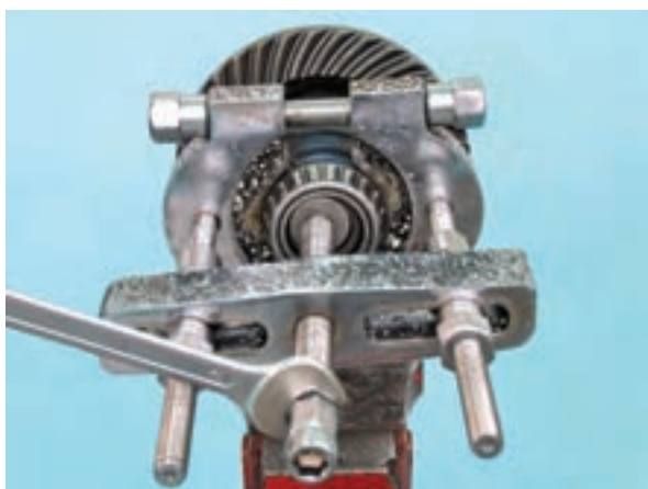
شکل ۱-۱۹۷ یک نوع بلبرینگ کش و کاربرد آن برای خارج کردن بلبرینگ
