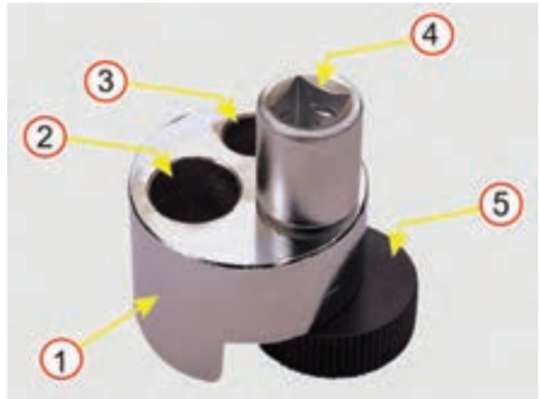
شکل ۱-۱۱۷ (الف) ابزار مخصوص باز کردن و بستن پیچ های دوسر دنده. ۱. بدنه ابزار، ۲ و ۳. محل قرار گرفتن پیچ دوسر دنده، ۴. محل اتصال دسته بوکس، ۵. قطعه خارج از مرکز دندانه دار.
