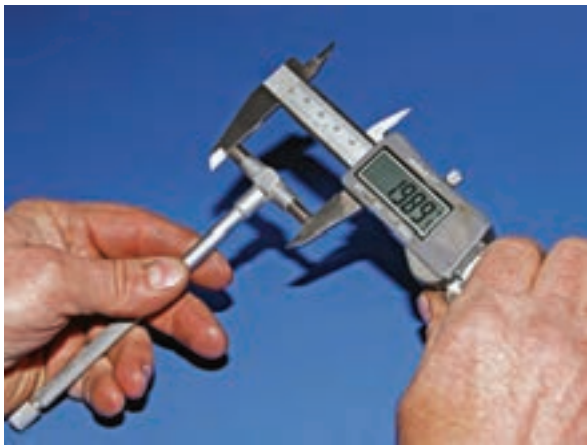
شکل ۱-۲۶۰ خواندن فاصله فک‌های اندازه‌گیر تلسکوپی
