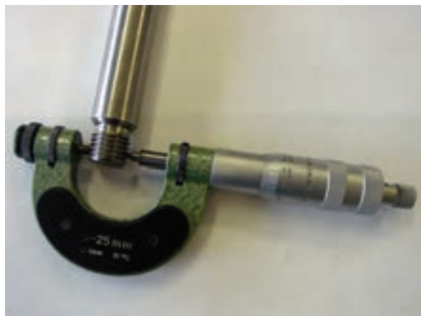
شکل ۱-۲۴۱ اندازه‌گیری شیار رزوه و پیچ
