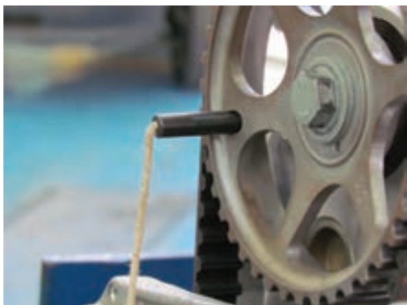
شکل ۱-۲۷۴ کاربرد پین تنظیم تایم میل بادامک
