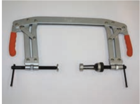
شکل ۱-۱۸۴ نوعی از فنر جمع کن سوپاپ
