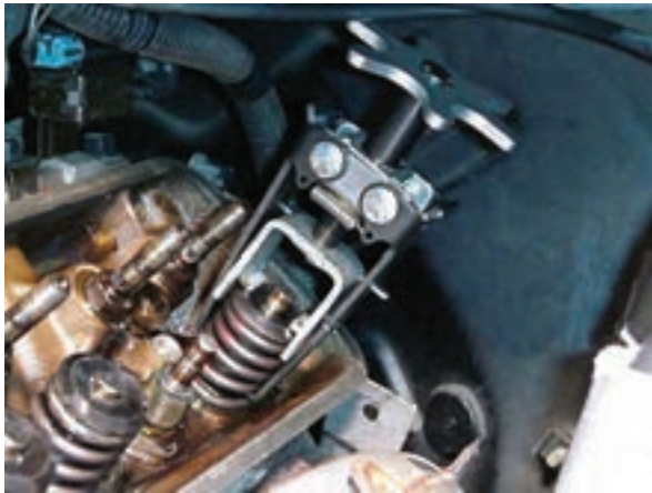
شکل ۱-۱۸۷ جمع کردن فنر سوپاپ به وسیله فنر جمع کن
