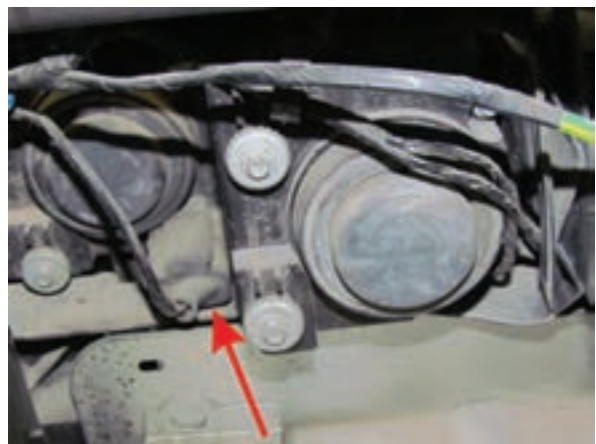
شکل ۲-۱۳۰ گردگیر روی کانکتور چراغ پارک
