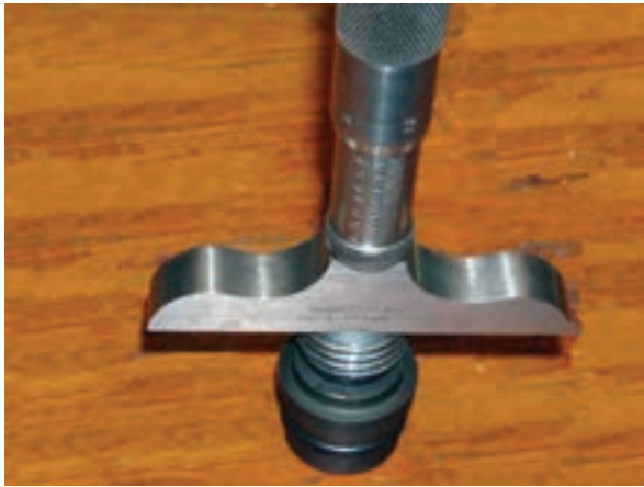
شکل ۲۵۷- کاربرد عمق‌سنج میکرومتری
