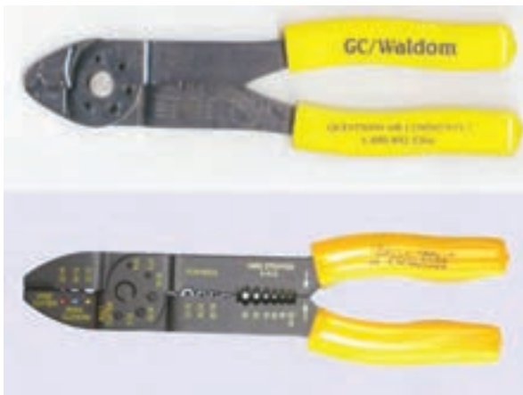
شکل ۱-۱۵۵ دو نوع انبر چند کاره سیم‌بر و سیم لخت کن
