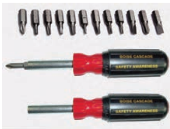
شکل ۱-۱۱۳ آچار پیچ‌گشتی قابل تعویض
