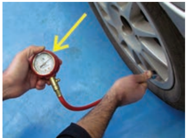
شکل ۲-۱۶۶ اندازه‌گیری فشار باد تایر
