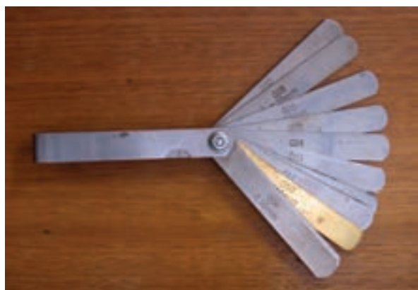
شکل ۱-۱۶۷ یک نوع فیلر میلی‌متری با تیغه‌های میلی‌متری و معادل اینچی آن.
