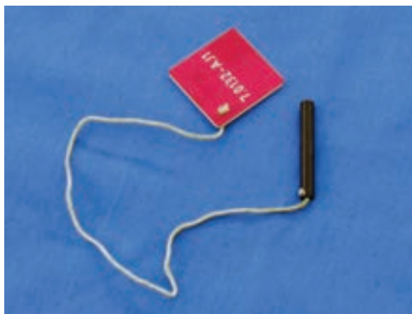
شکل ۱-۲۷۳ پین تنظیم تایم میل بادامک
