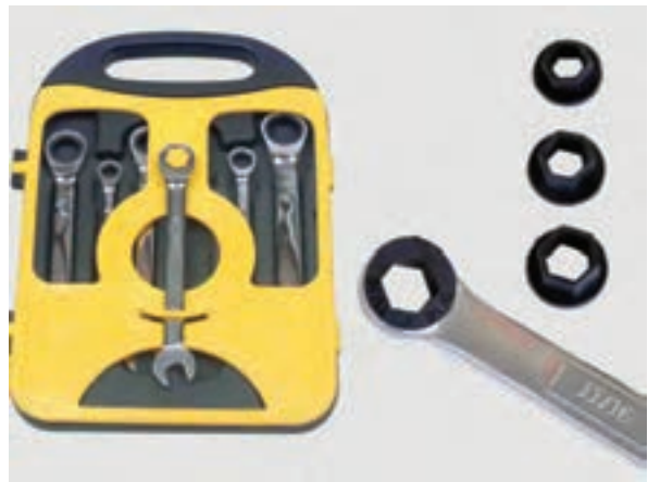
شکل ۱-۳۷ نوعی آچار ترکیبی یکسر رینگی - یکسر تخت که قسمت رینگی آن قابل تعویض است
