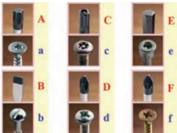
شکل ۱-۹۶ فرم آچار پیچ‌گشتی، (A-F) فرم آچار پیچ‌گشتی، (a-f) آچارخور پیچ
