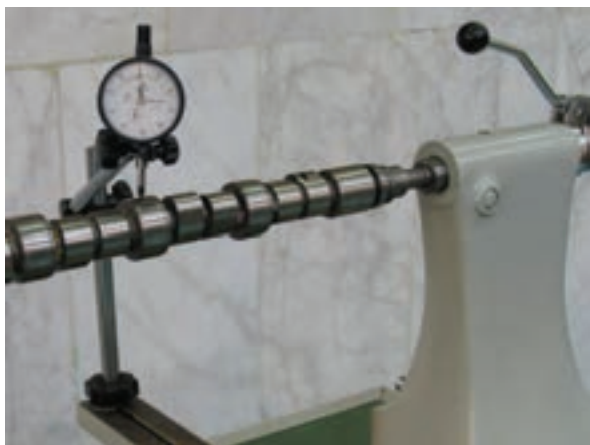
شکل ۱-۲۵۵ نحوه اندازه گیری دو پهن میل بادامک
