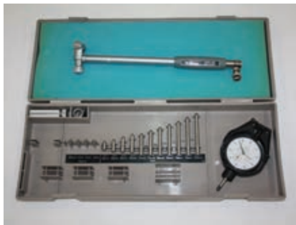
شکل ۱-۲۵۲ ساعت اندازه گیر نوع میلی متری
