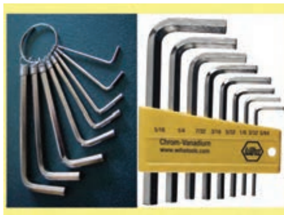
شکل ۱۸۵ یک سری ۸ تایی آچار آلن نوع میلی‌متری و نوع اینچی
