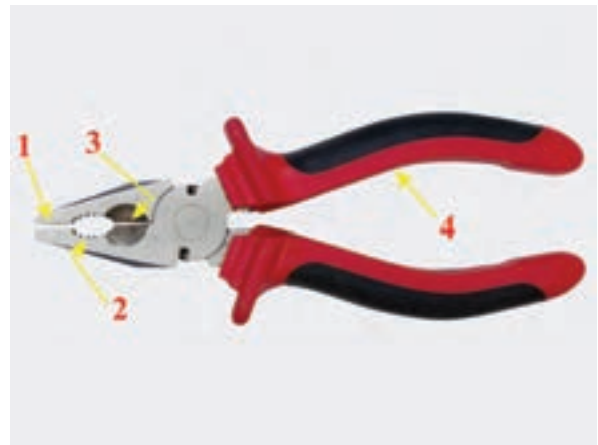
شکل ۱-۱۲۲ انبردست. (۱) فک، (۲) شکاف دندانه‌دار، (۳) تیغه قطع‌کن. (۴) دسته
