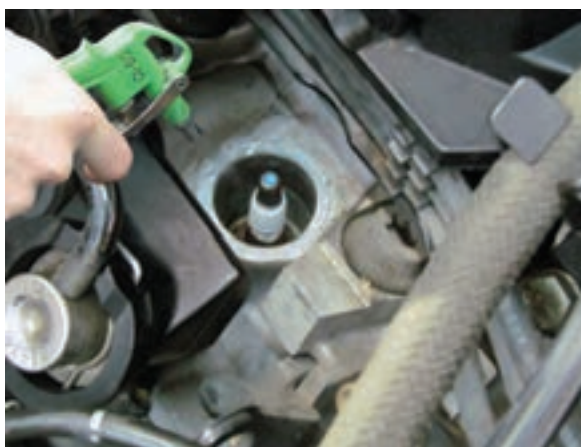
شکل ۲-۸۸ استفاده از فشار باد برای تمیز کردن اطراف شمع
