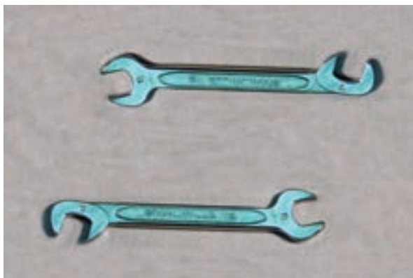
شکل ۱-۷ آچار دوسر تخت با انحراف دهانه ۶۰ درجه
