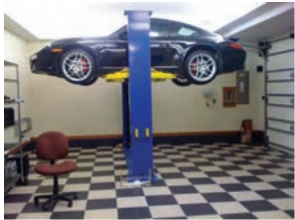
شکل ۱-۲۰۲ جک ثابت دوستونی
