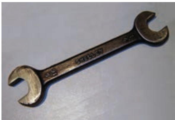
شکل ۱-۵ آچار تخت دوسر تخت اینچی با ضخامت دهانه معمولی
