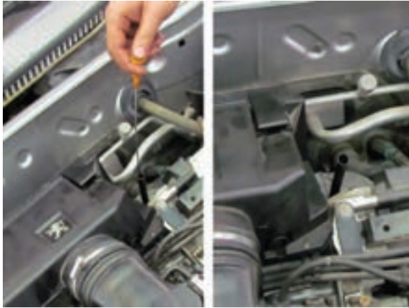
شکل ۲-۳۲ خارج کردن گیج روغن
