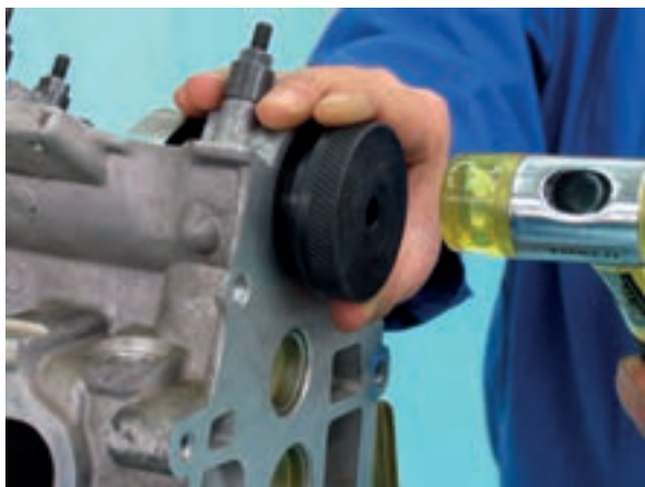
شکل ۳-۳۱۶ نصب کاسه‌نمد میل بادامک با ابزار مخصوص
