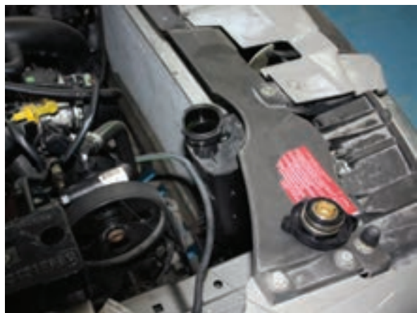
شکل ۲-۸۳ بازدید و بررسی سطح مایع خنک‌کننده
