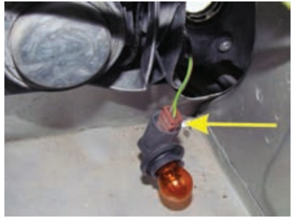
شکل ۲-۱۳۶ جداکردن کانکتور یا اتصال الکتریکی
