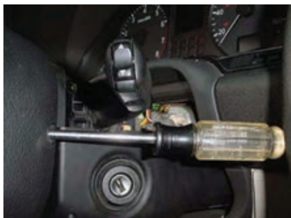
شکل ۱-۱۱۰ کاربرد آچار پیچ‌گشتی مغناطیسی
