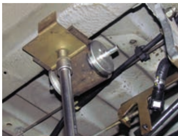
شکل ۲-۷۱ باز کردن پیچ نگهدارنده فیلتر بنزین
