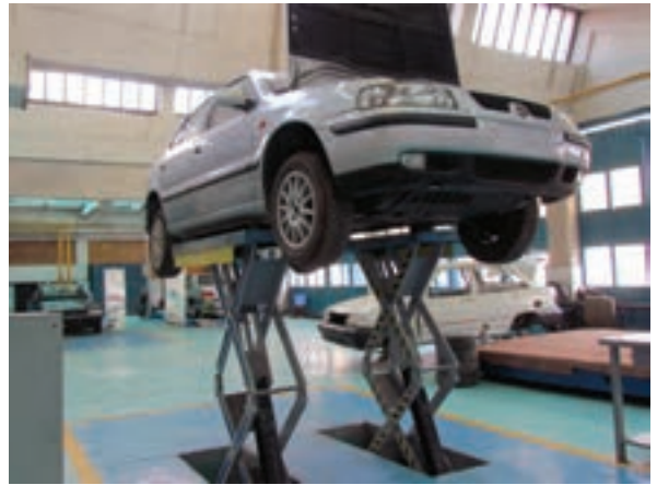
شکل ۲-۴۹ بالا بردن خودرو با جک قیچی
