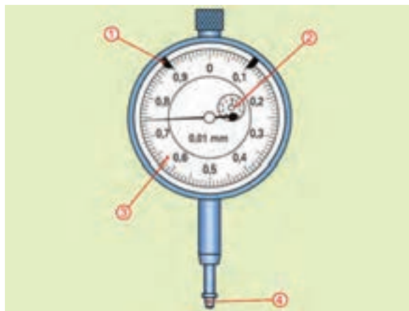
شکل ۱-۲۴۸ قسمت‌های مختلف ساعت اندازه‌گیر، ۱. شاخص‌های قابل تنظیم، ۲. نشان دهنده میلی‌متری، ۳. صفحه مدرج با تقسیمات \frac{1}{100} میلی‌متر، ۴. محور متصل به صفحه
