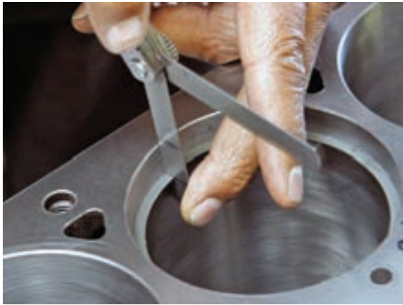
شکل ۱-۱۶۹ کاربرد فیلر برای اندازه‌گیری دهانه رینگ
