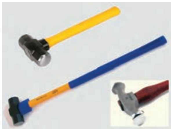
شکل ۱-۱۵۷ سه نوع چکش فلزی
