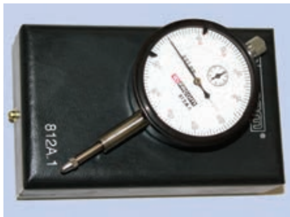
شکل ۱-۲۴۹ ساعت اندازه‌گیر نوع میلی‌متری
