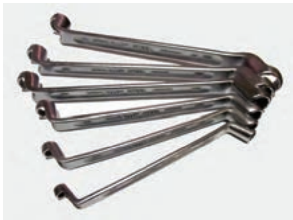
شکل ۱-۱۹ آچار رینگی سر کج برای مواضع عمیق (نوع اینچی)
