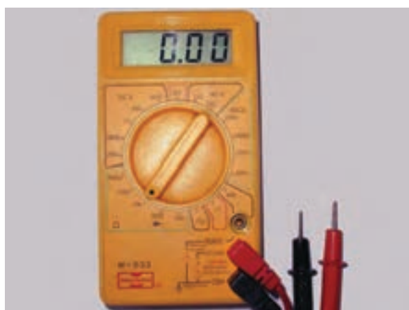
شکل ۱-۲۶۴ یک نوع مولتی متر دیجیتالی
