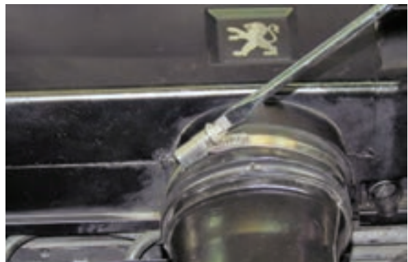
شکل ۲-۵ بازکردن بست فلزی لوله مکندۀ هوا
