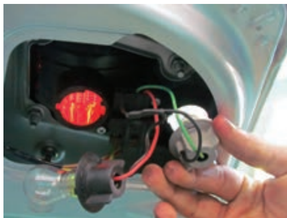
شکل ۲-۱۶۰ بیرون آوردن پایه و لامپ چراغ دنده عقب
