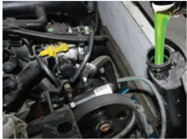
شکل ۲-۸۴ جریان کاهش مایع خنک‌کننده
