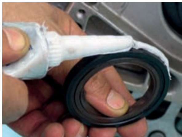
شکل ۳-۳۱۰ چسب زدن کاسه‌نمد سر میل‌لنگ
