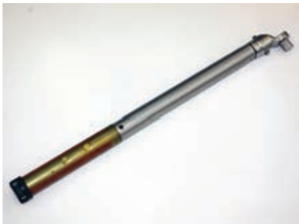
شکل ۱-۸۰ آچار درجه‌دار مکانیکی ضامن‌دار
