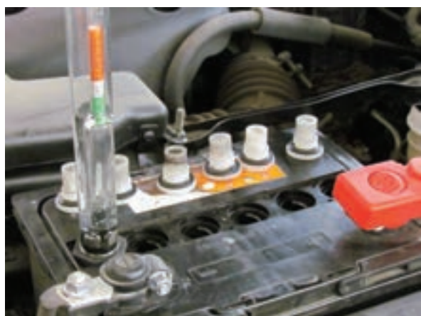
شکل ۲-۱۰۹ اندازه‌گیری چگالی الکترولیت
