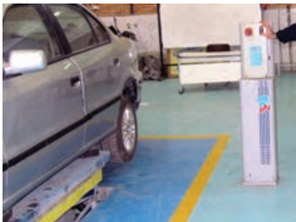
شکل ۲-۶۲ پایین آوردن جک بالا بر
