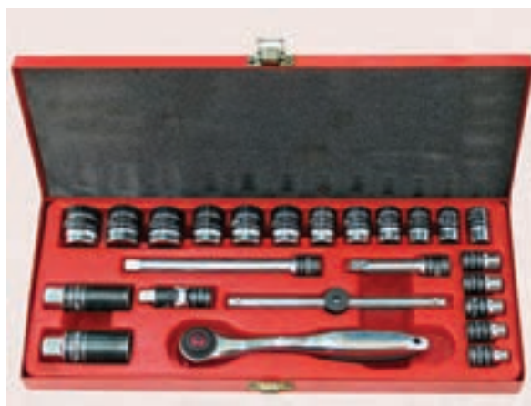
شکل ۱-۷۱ جعبه بوکس میلی متری ۲۴ پارچه
