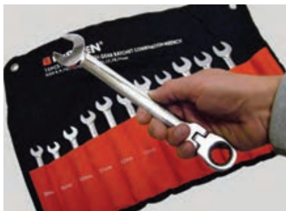
شکل ۱-۳۵ سری ۱۲ عددی آچار ترکیبی یکسر تخت - یکسر رینگی متحرک
