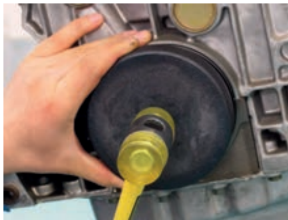
شکل ۳-۳۱۵ نصب کاسه‌نمد به وسیله ابزار مخصوص
