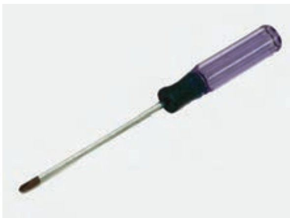
شکل ۱۰۰- آچار پیچ گشتی مخصوص پیچ های شیاردار سه گوش
