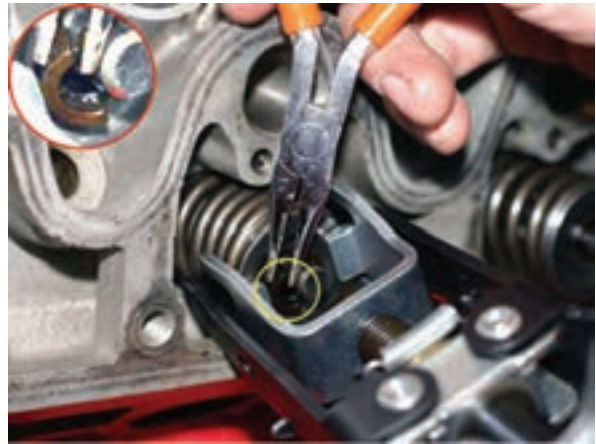
شکل ۱-۱۸۶ خارج کردن خار آزاد شده فنر سوپاپ
