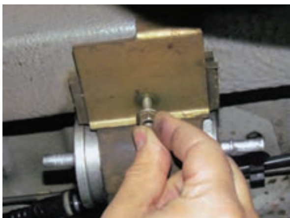
شکل ۲-۷۶ تعیین جهت صحیح قرارگرفتن فیلتر بنزین و بستن آن
