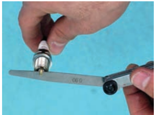
شکل ۹۴-۲ فیلرگیری شمع
