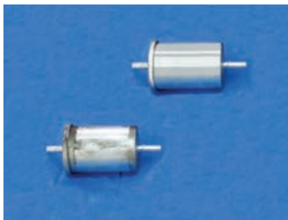
شکل ۲-۷۵ جایگزین کردن فیلتر نو
