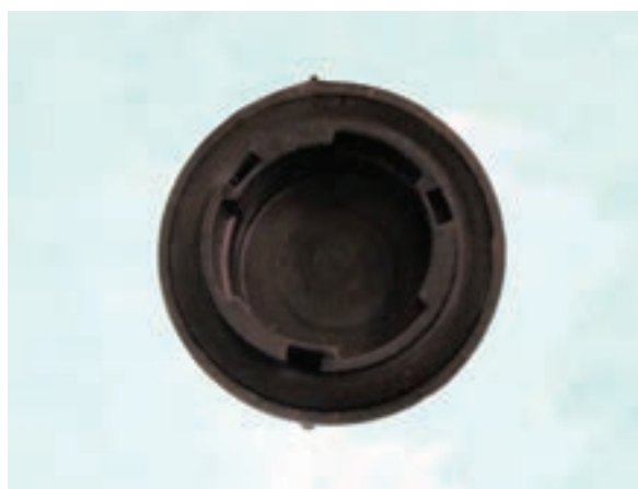
شکل ۲-۱۴۴ محل خارها در روی قاب پلاستیکی
