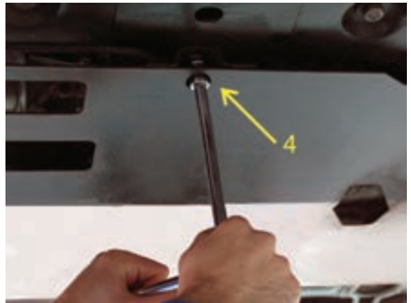
شکل ۲-۵۳ بازکردن پیچ‌های سینی زیر جعبه‌دنده
