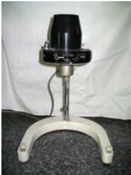
شکل ۲-۴۵- ج: وِسکومتر چرخشی (بروکفیلد) آنالوگ
