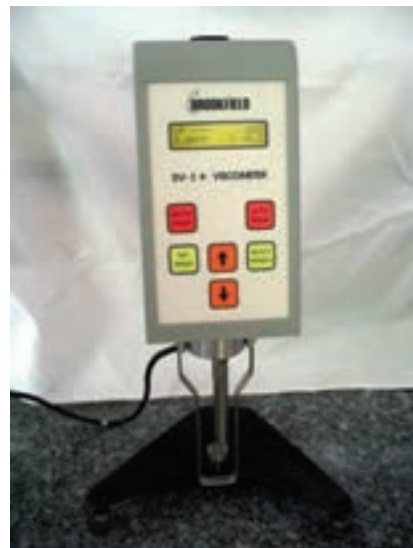
شکل ۲-۴۵- د: وِسکومتر چرخشی (بروکفیلد) دیجیتالی
