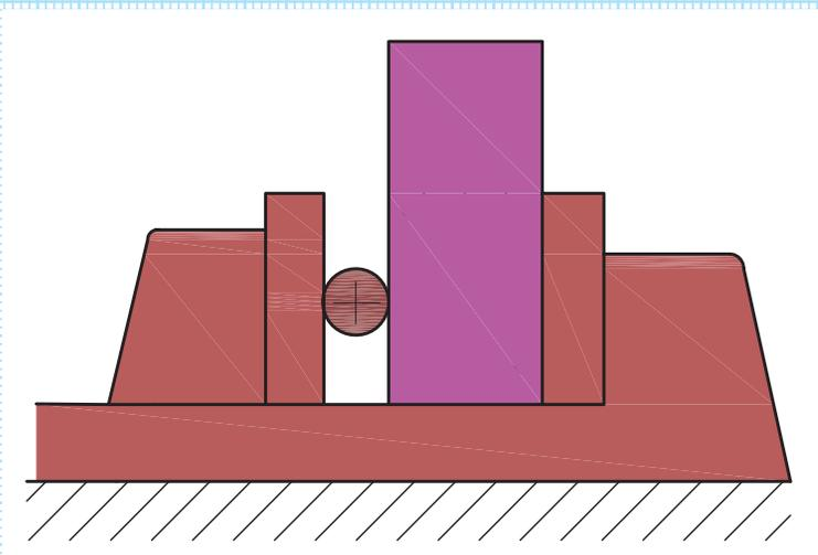
۱۴- به کمک هنرآموز محترم، قطعه‌ای را با کمک روینده بر روی دستگاه صفحه تراش ببندید و روش نصب و تنظیم قطعه به کمک روینده را به طور مختصر شرح دهید.
