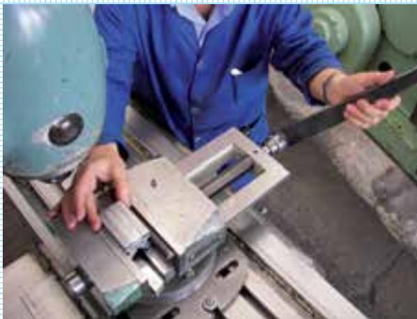
۱۵- دلیل استفاده از زیرکاری در بستن قطعه کار روی گیره چیست؟
