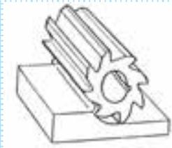
با خارج شدن دنده از کار، دنده ی دیگر مشغول براده برداری می شود.
