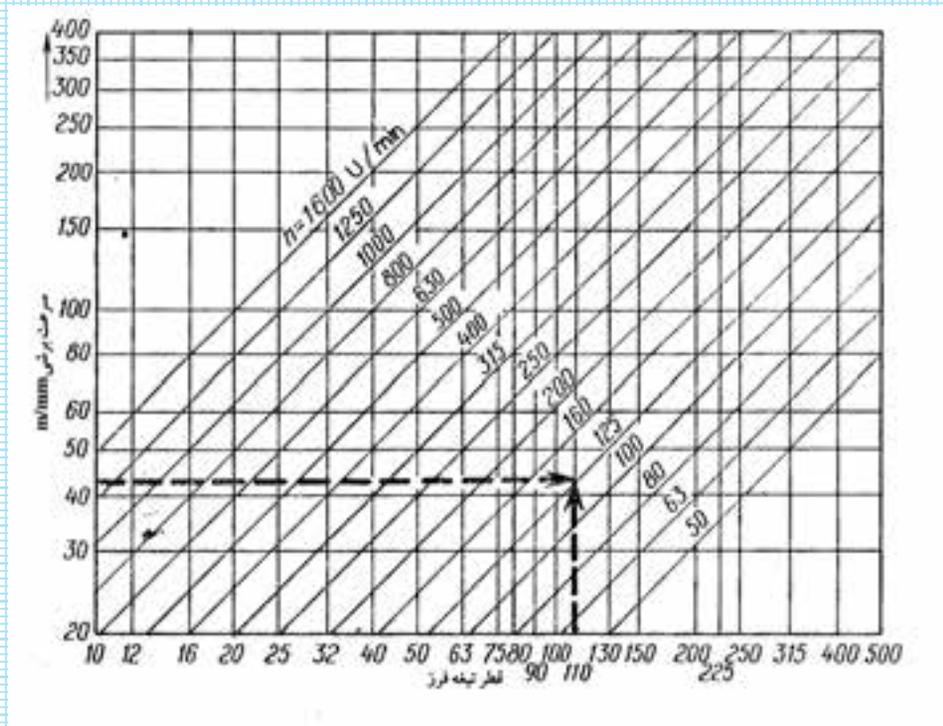
نمونه : قطر تیغه فرز ۱۱۰ میلی متر ، سرعت برش ۴۲ متر بر دقیقه ، تعداد دوران ۱۲۵ دور بر دقیقه .
