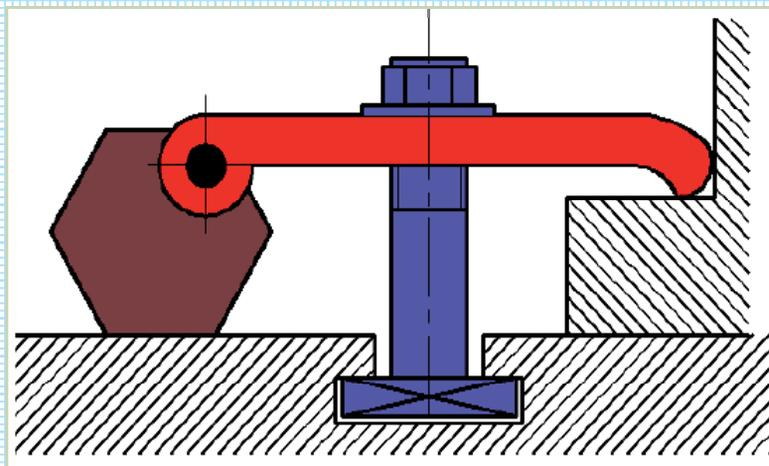
۱۸- به کمک هنرآموز یا استاد کار محترم، قطعه ای را به کمک روبنده بر روی دستگاه فرز ببندید و روش نصب و تنظیم قطعه به کمک روبنده را به طور مختصر شرح دهید.
