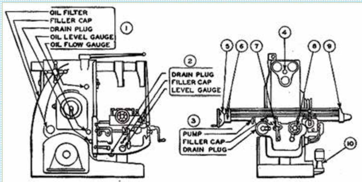
۱۹- جایگاه‌های روغن‌نما (گیج روغن) بر روی دستگاه فرز کارگاه، تعداد آن و میزان سطح روغن هرکدام را مشخص کنید.
