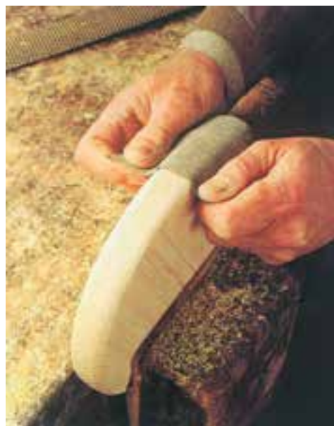
شکل ۲۶-۴ - سنباده‌کاری (روی سطوح قوس‌دار).
