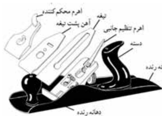
شکل ۵۱-۳- قسمت‌های مختلف رنده دو تیغ آهنی.
