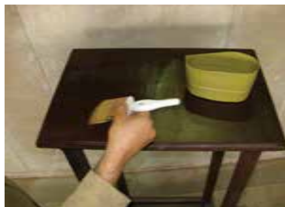
شکل ۹-۱۲- زدن سیلر با قلم‌مو روی سطح آسترفورده.
