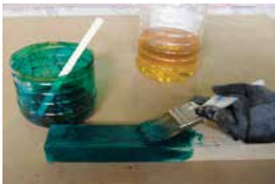
شکل ۵۱-۱۲- زدن استری روغنی سبز به سطح کار با قلم‌مو.
