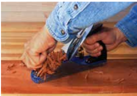
شکل ۳-۲۱- رنده‌کاری سطح چوب.
