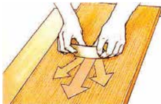
شکل ۳۵-۳- لیس‌ه‌کاری در جهت الیاف.
