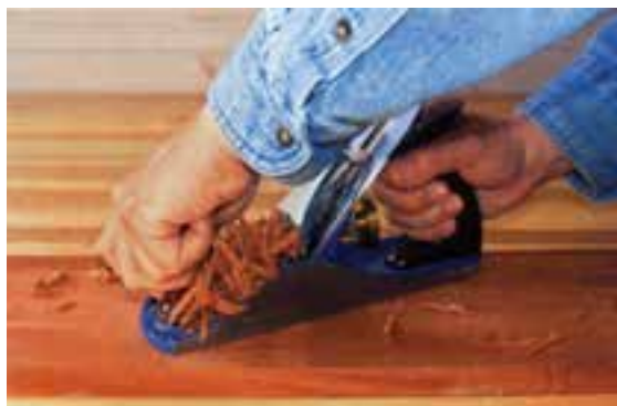
شکل ۷-۱۳- پرداخت‌کاری با رنده دستی.
