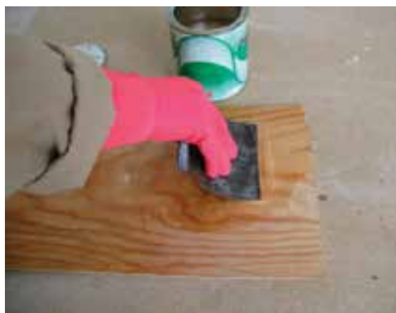
شکل ۵۹-۱۲- استفاده از لیسه برای زدن سیلر به سطح کار.
