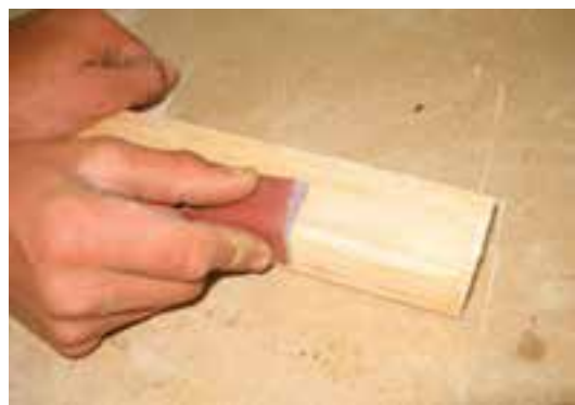
شکل ۱۷-۱۳- سنباده‌کاری روی قسمت افزا (افزوده لبه چوب نراد).
