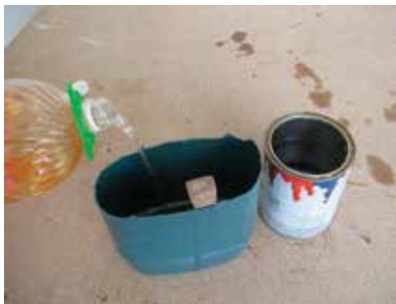
شکل ۶۶-۱۳- اضافه نمودن تینر (روغنی به روغن جلا.
