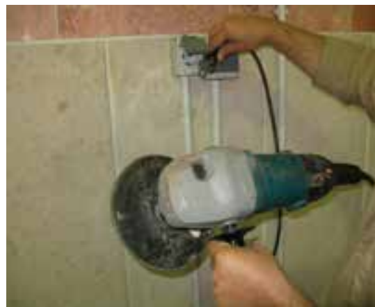
شکل ۲۰-۱۳- کشیدن دوشاخه ماشین پوست گرد از پریز.
