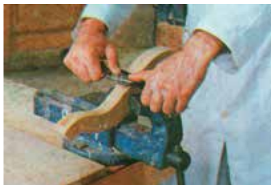
شکل ۳۴-۳۵- لیسه‌کاری پایه قوس‌دار.
