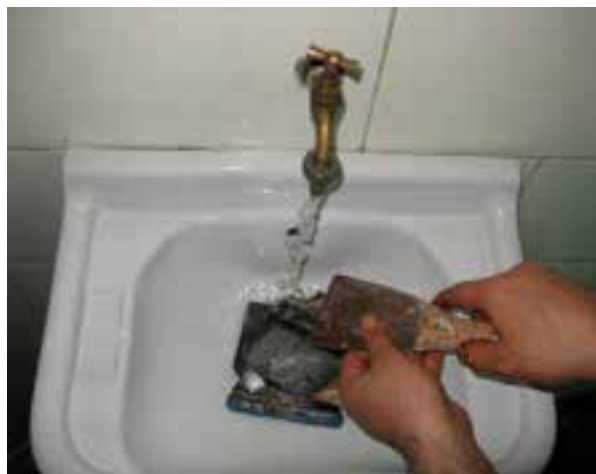
شکل ۱۷-۶- شستن و تمیز کردن لیسه و کاردک.
