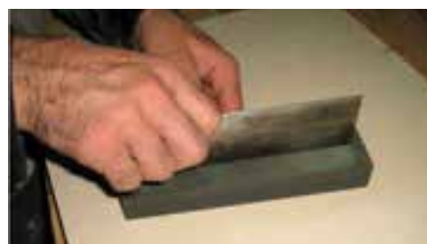
شکل ۳-۴۳ - کشیدن لیس روی سنگ نفت.
