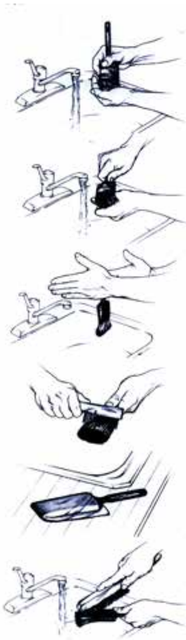
شکل ۱۴-۸- روش شستن و فشک کردن قلم موها.
