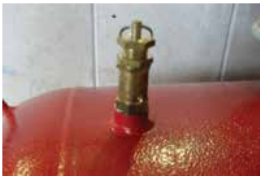
شکل ۷-۱۰- سوپاپ کمپرسور برای فروغ هوای اضافی.
