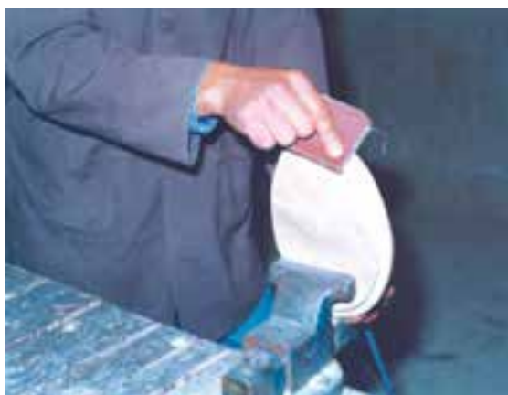
شکل ۲۲-۴- عده استفاده از چوب کمکی.
