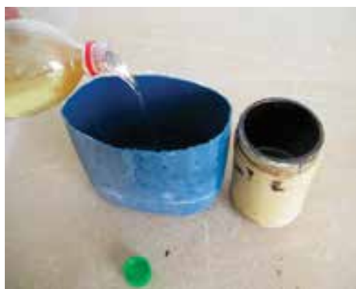
شکل ۶۳-۱۳- مل کردن آستری شاپان با نفت.
