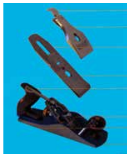
شکل ۳-۲۳ - رنده آهنی و تیغه‌های آن.
