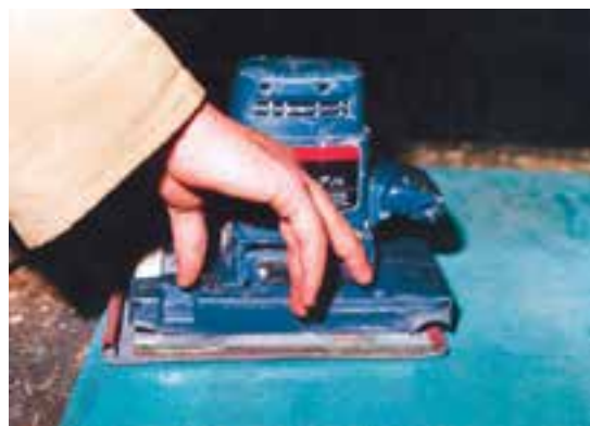
شکل ۳۷-۵- بازکردن فک‌ها به کمک گیره‌های عقب و جلو.
