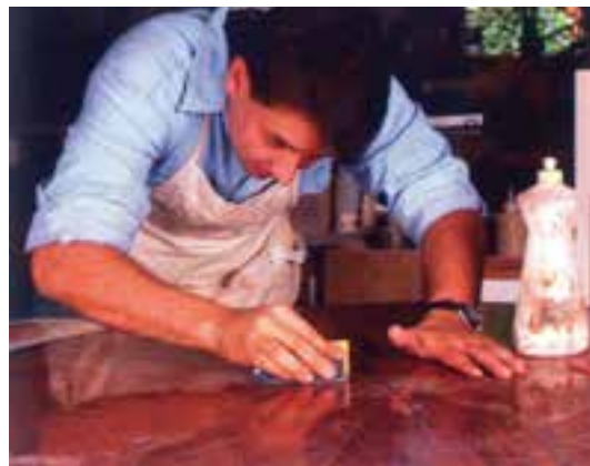
شکل ۱۲-۲۳- سنباده‌کاری سطح پلی استر فورده.
