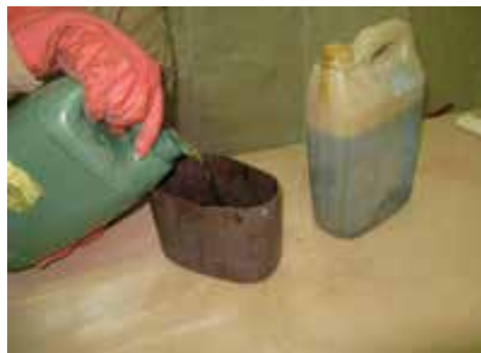
شکل ۸-۱۰- رقیق کردن روغن الیف با تینر روغنی.
