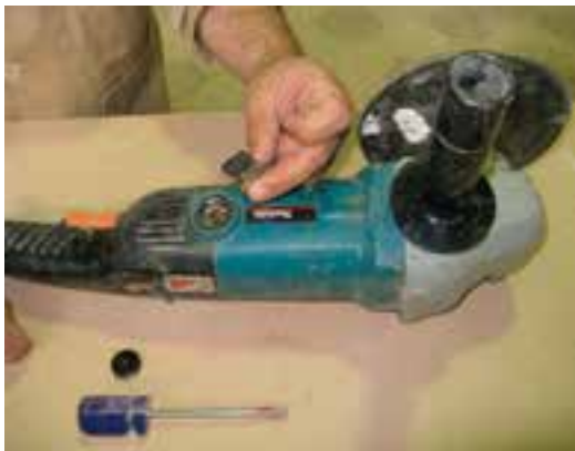
شکل ۳۵-۵- بازدید ذغال دستگاه سنباده دیسکی.
