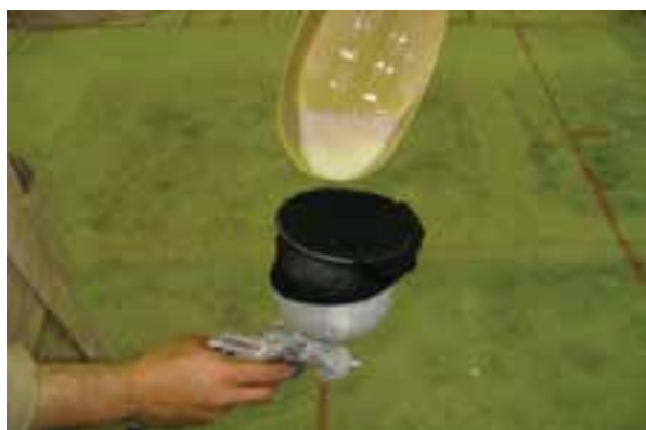
شکل ۵-۹- استفاده از هوزاب نازک به عنوان صافی.
