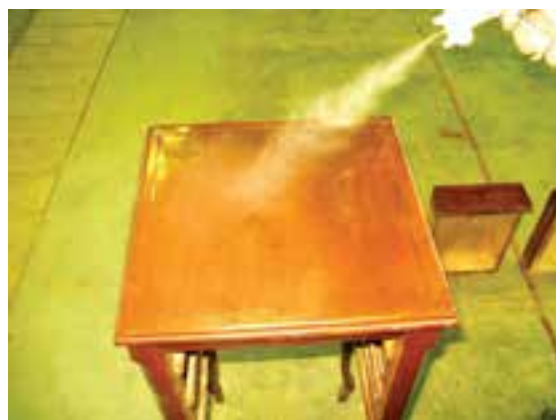
شکل ۵-۱۲- پاشیدن رنگ نیتروسولولوزی با پیستوله.
