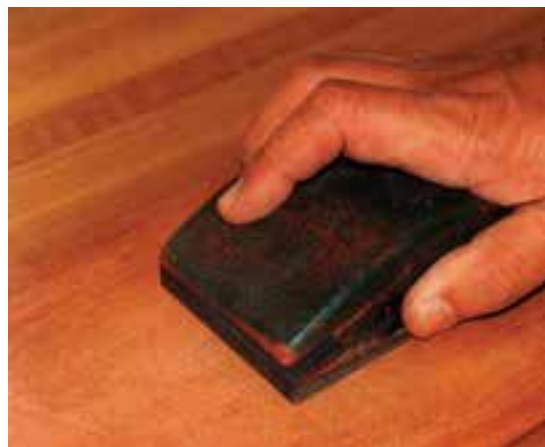
شکل ۲۰-۴- پوست آب کاری به کمک تخته پوست.
