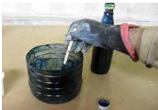
شکل ۵۳-۱۲- مل کردن آب در آستری آبی.
