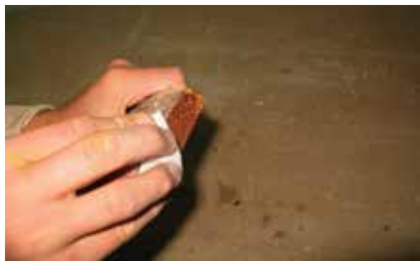
شکل ۶۴-۱۳- زدن آب به کله چوب.
