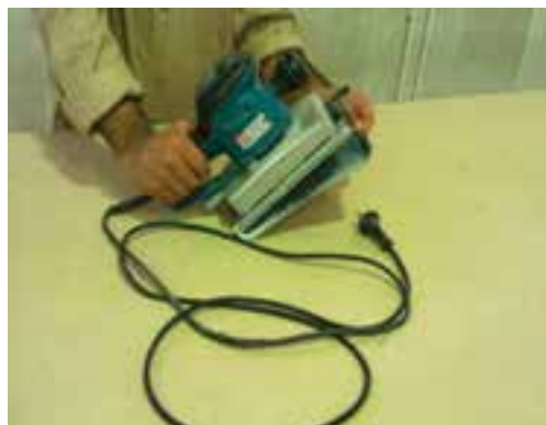
شکل ۱۸-۵- نمونه تعویض ورق سنباده لرزان.
