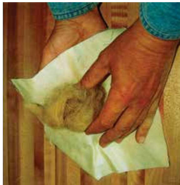
شکل ۳۴-۱۲- استفاده از پارچه و پشم برای زدن لاک و الکل به سطح کار.
