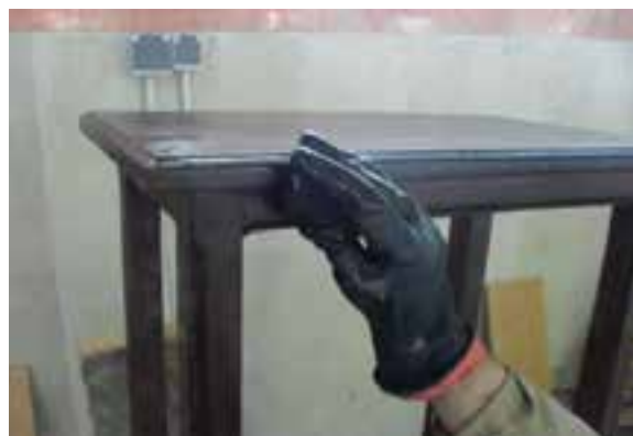
شکل ۴۹-۱۲- آسترکاری یک کار قبل از سیلرکاری.
