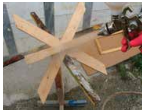
شکل ۱۴-۱۲- زدن کیلر به کار با پیستوله.
