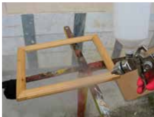
شکل ۱۸-۱۲- (زدن نیم پلی استر با پیستوله).
