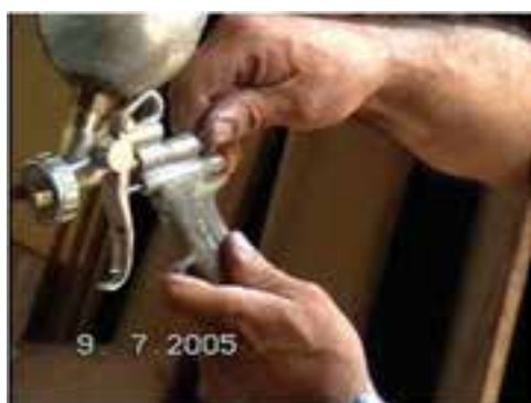
شکل ۸-۲۴- پیچ تنظیم هوا.
