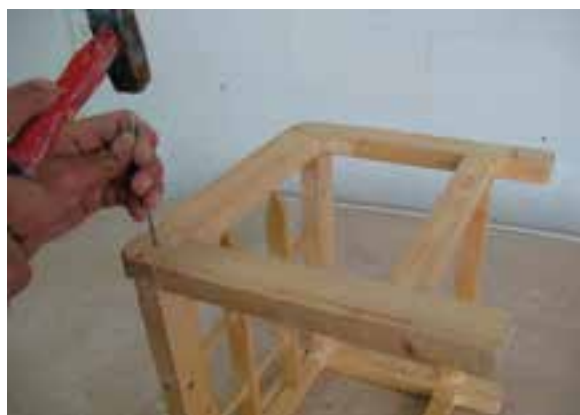
شکل ۸-۱۳- سنبه‌کاری (روی میخ‌ها).
