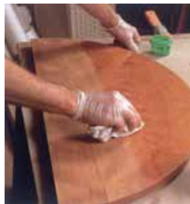
شکل ۳۸-۳۹- استفاده از پارچه نم‌دار در لیسه‌کاری.
