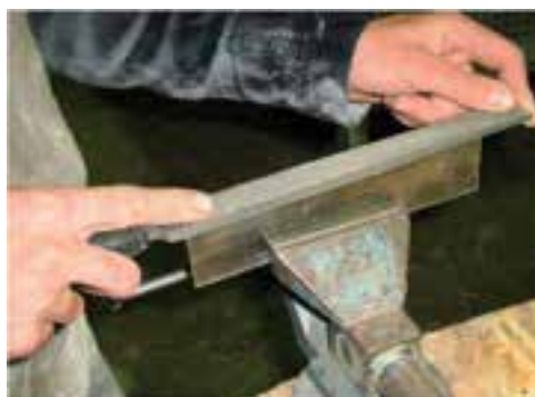
شکل ۳-۴۲ - نمونه‌ی سوهان‌کشی لیس.
