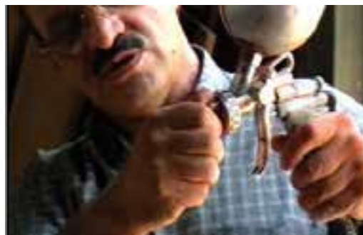
شکل ۲۵-۸- پیچ تنظیم پرده رنگ.
