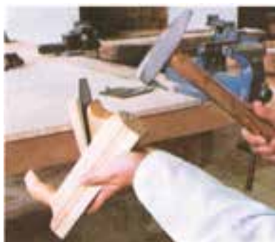
شکل ۵۵-۳- پر تیغ و کم تیغ کردن رنده چوبی.
