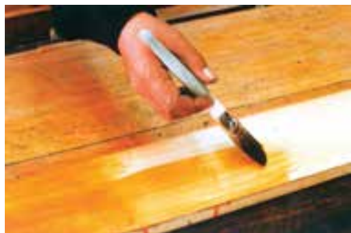
شکل ۳۴-۸- سیلرکاری در جهت الیاف.
