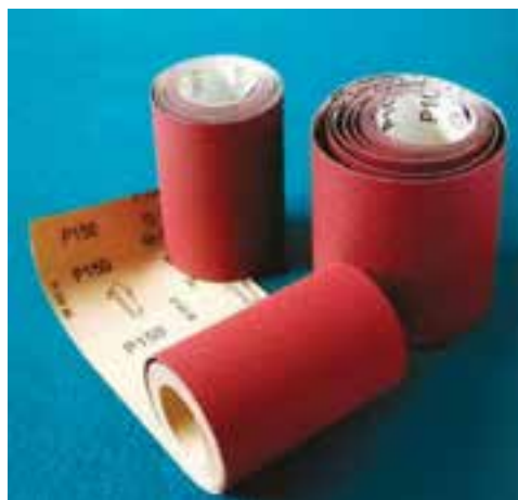
شماره سنباده رولی و گرد مورد استفاده در ماشین سنباده پوست گرد از ۴۰ تا ۱۲۰ می‌باشد که شماره ۴۰ با دانه‌های درشت‌تر برای کارهای خشن و شماره ۱۲۰ با دانه‌های ریزتر برای کارهای ظریف‌تر به کار می‌رود (شکل ۳۲-۵).
