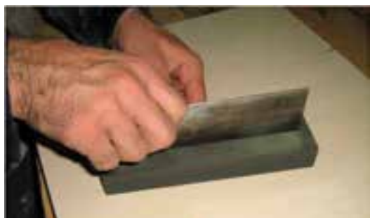
شکل ۱۱-۳- کشیدن لیسه روی سنگ نفت.
