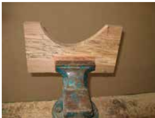
شکل ۱۴-۱۳- سنباده‌کاری یک کار قوس‌دار.
