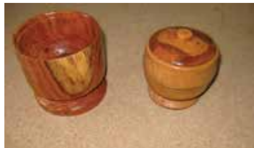
شکل ۱۲-۱- در رنگ غیرپوششی الیاف و نقش چوب، از زیر رنگ به خوبی دیده می‌شود.
