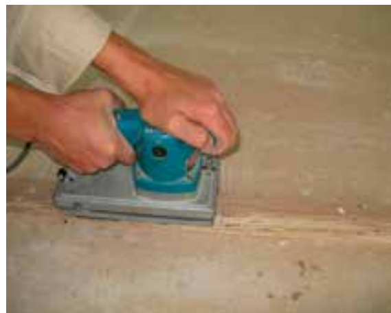
شکل ۲۷-۱۳- سنباده‌کاری یک قطعه چوب راش با ماشین سنباده لرزان.
