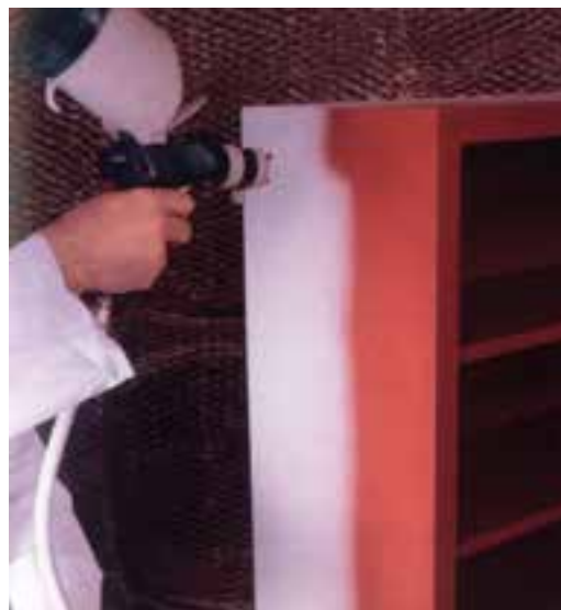
شکل ۱۱-۱۰- استفاده از پیستوله برای پاشیدن رنگ فوری به روی سطح کار.
