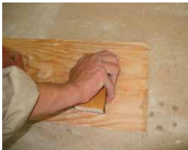
شکل ۱۵-۱۳- سنباده‌کاری در فلاف جهت الیاف.
