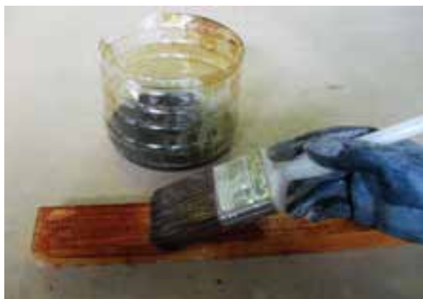
شکل ۵۲-۱۲- زدن آستری فندقى (روی سطح کار با قلم مو).
