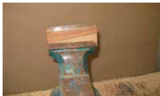
شکل ۹-۱۳- بستن لیسه و تنگ به گیره میز کار.
