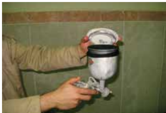
شکل ۸-۲۲- مخزن پیستوله.
