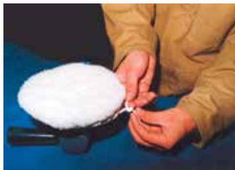
شکل ۲۴-۵- استفاده از نمد جهت پرداخت و پولیش کاری سطوح رنگ شده پلی استر.
