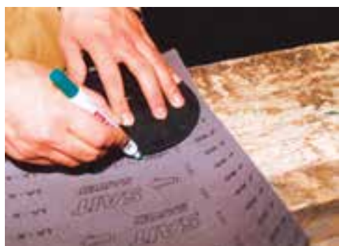
شکل ۲۶-۵- ترسیم گردی دیسک روی سنناده.
