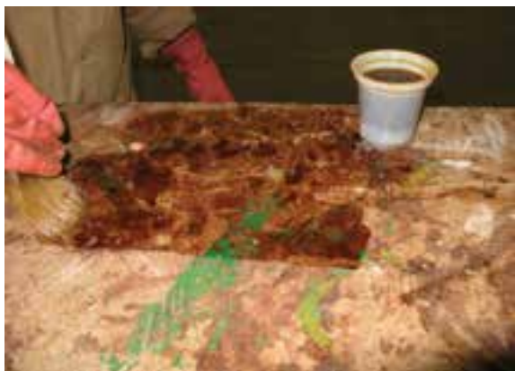
شکل ۱-۳- روغن اندود کردن میزکار با روغن بزرک.
