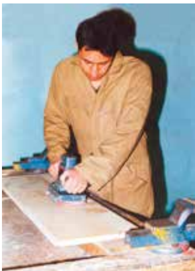
شکل ۵-۴۳- سنباده‌کاری در جهت الیاف.
