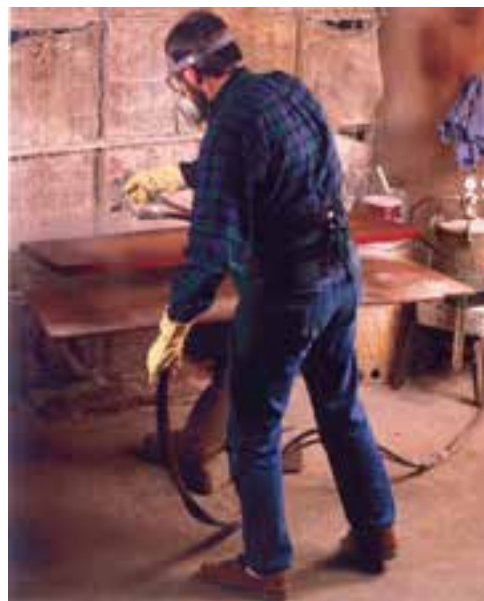
شکل ۱۲-۲۲- پاشیدن پلی استر ایستاده به سطح کار.
