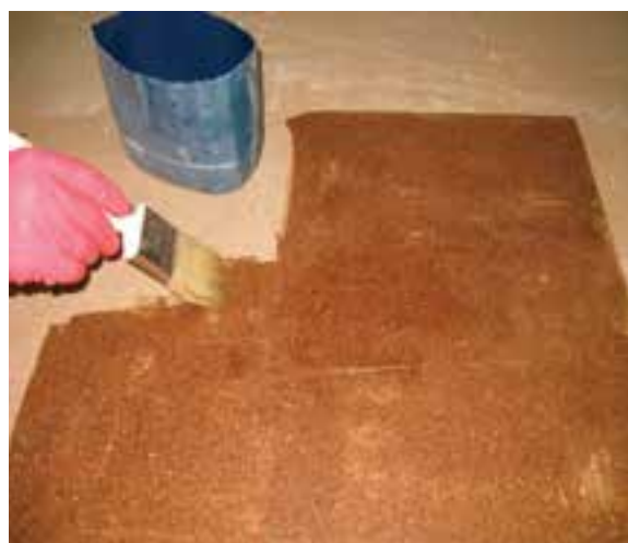
شکل ۲۰-۱۱- بوم کردن سطح تخته فرده پوب با سیلر.
