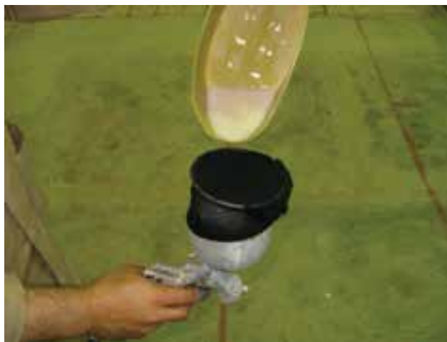
شکل ۳۹-۸- استفاده از جوراب نازک به عنوان صافی.
