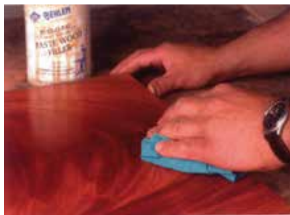
شکل ۷۵-۱۲- گرفتن روغن از سطح کار با مواد برطرف کننده روغن.
