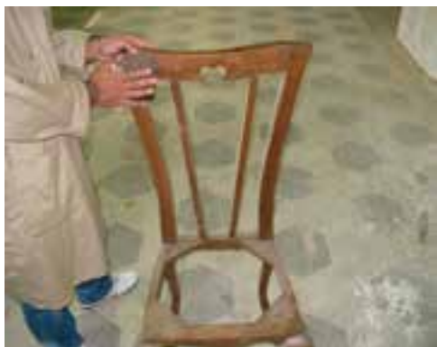
شکل ۵۷-۱۲- گرفتن گردوغبار از سطح کار با پارچه.
