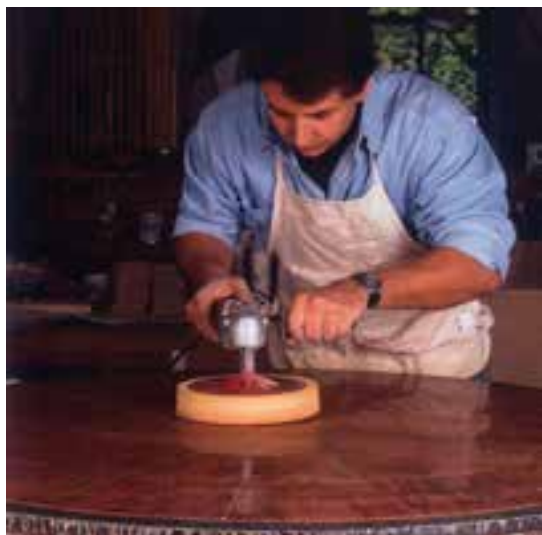
شکل ۱۲-۲۴- پولیش‌کاری سطح پلی استر فورده.
