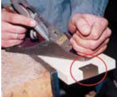
شکل ۳-۳- احتمال برخورد رنده با میخ و یا اشیاء فلزی.
