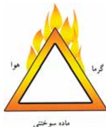
شکل ۲۸-۱- فاکتورهای مهم در شکل‌گیری آتش.
