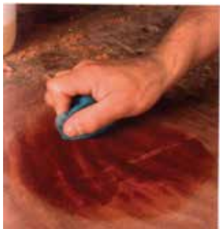
شکل ۷۳-۱۲- زدن لاک و الکل با کهنه (رنگ‌کاری).
