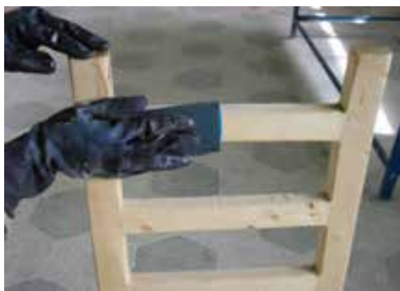
شکل ۶۱-۱۲- پوست آب کاری روی سطح سیلر فورده.
