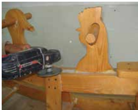
شکل ۱۹-۱۳- سنباده کاری با ماشین پوست دیسکی.
