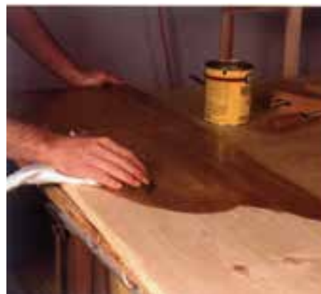
شکل ۱-۱۰- روغن اندود کردن سطح کار.
