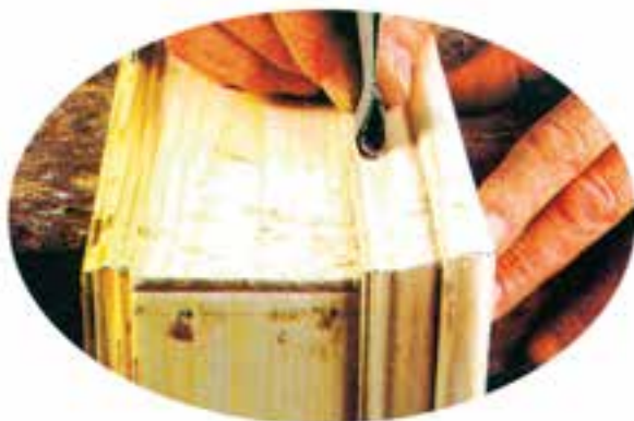
شکل ۲۸-۴ - سنباده‌کاری (روی سطوح محدب و مقعر).
