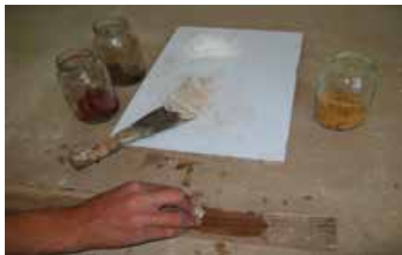
شکل ۱۳-۳۱ زدن آب روی قطعه کار برای سافت بتونه هم‌رنگی.
