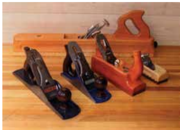
شکل ۳-۲۲ - انواع رنده‌های چوبی و آهنی.
