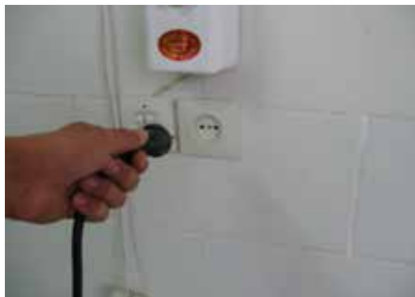
شکل ۲۵-۱۳- قطع کردن برق دستگاه سنباده لرزان.
