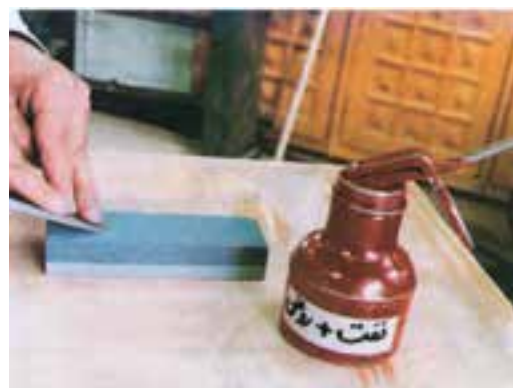
شکل ۳۱-۳- (روغن زدن یا نفت زدن روی سنگ).
