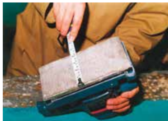
شکل ۳۸-۵- اندازه‌گیری طول صفحه‌ی سنداده لرزان.
