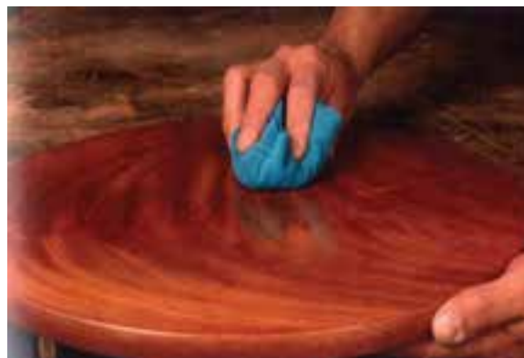
شکل ۷۴-۱۲- یردافت کاری سطح لای و الکل خورده.
