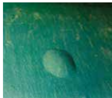
شکل ۸-۴۴- تاول زدگی سطح کار بعد از رنگ.
