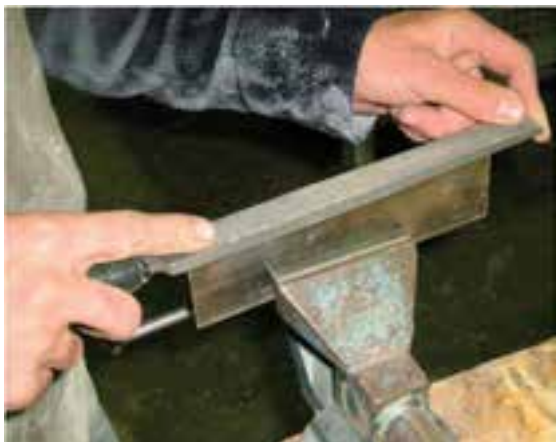
شکل ۱۰-۳- سوهان کشیدن روی نر لیسه.
