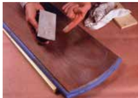
شکل ۱۵-۴- پوست آب کاری (روی سطح سیلر فورده).
