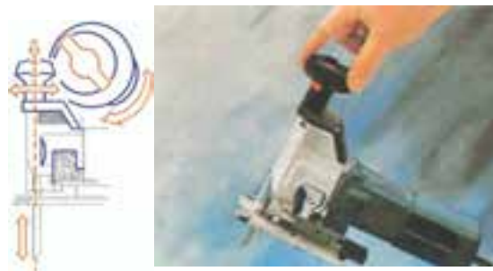
شکل ۱۵-۴۲- تعویض تیغه اره.
