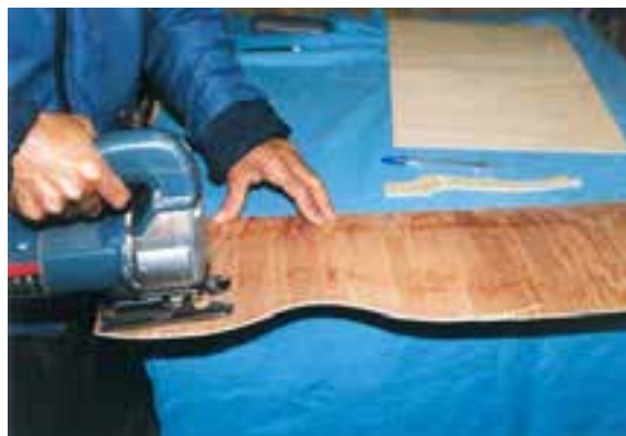
شکل ۱۸-۲۱- برش تخته سه‌لایه با توجیه به طرح الگو.
