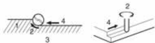
شکل ۱۶-۲۲- به جهت حرکت تیغه (روی قطعه کار، نسبت به گردش تیغه مول ممور فود توجه کنید.
