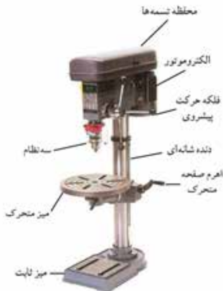
شکل ۱۹-۴- دریل ستونی پایه‌دار و قسمت‌های آن.
