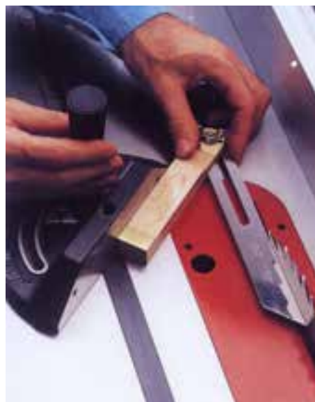
شکل ۱۲-۲۰- تنظیم زاویه‌ی تیغه
