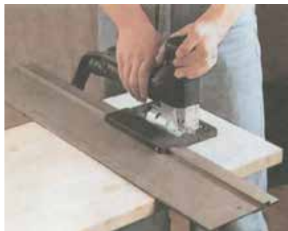
شکل ۱۵-۲۰- برش عرضی چوب به کمک ریل راهنما.
