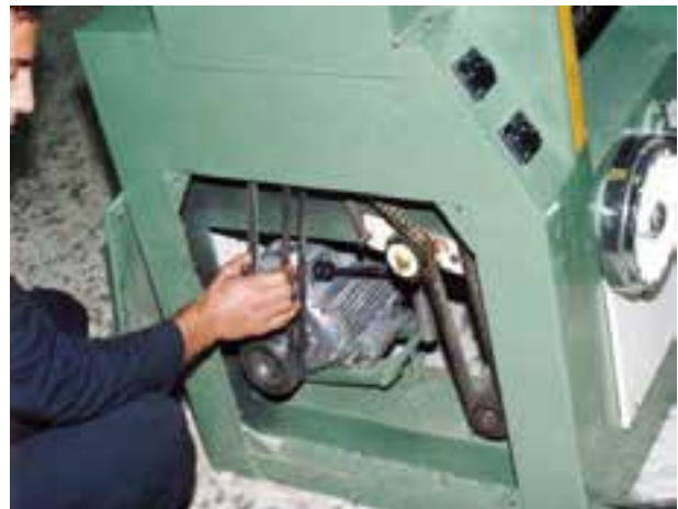
شکل ۸-۱۶- کنترل تسمه‌های انتقال نیرو
