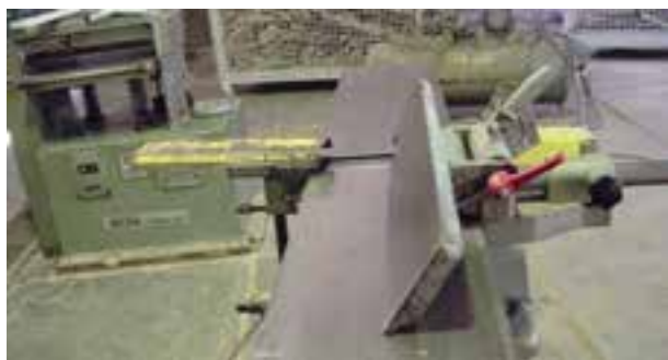
شکل ۳۴ ۴- تنظیم زاویه ۴۵ درجه گونیا‌ی رنده.
