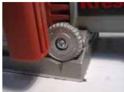
شکل ۱۷-۵- پیچ تنظیم عمق شیار.
