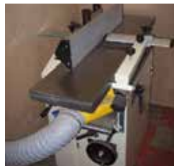
شکل ۴-۲۲ - مکنده‌ی قابل اتصال به ماشین کفرند.
