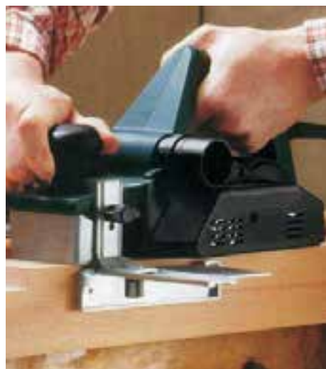
شکل ۱۴-۳۲. تنظیم گونبای سمت چپ رنده
