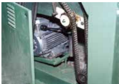
شکل ۸-۱۴- باز کردن درپوش برای روغن‌کاری.
