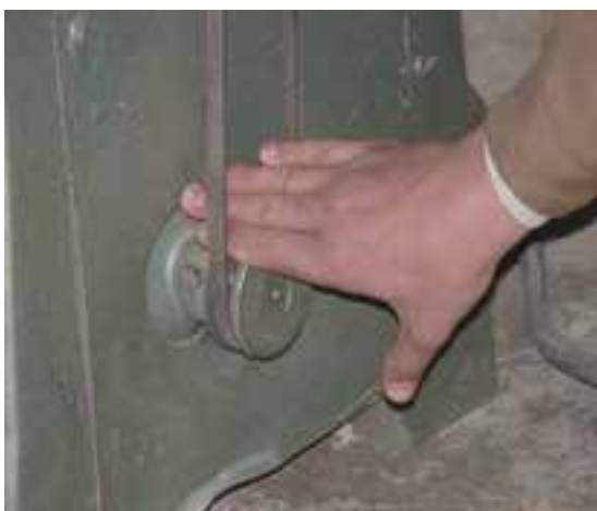
شکل ۶-۱۰-۱- مراقبت از انگشتان به هنگام تعویض تسمه.
