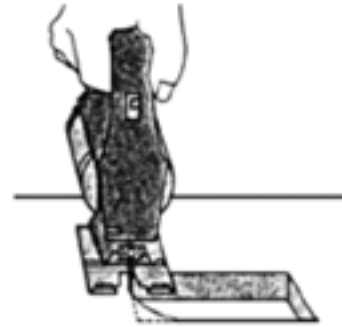
شکل ۱۵-۳۷- نمونه‌ی بریدن گوشه‌های داخلی با زاویه‌ی ۹۰ درجه.
