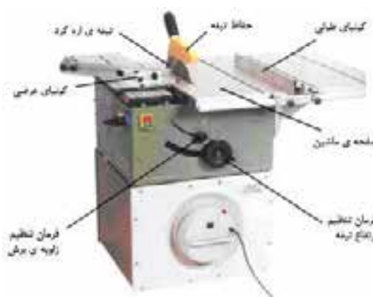
شکل ۱۲-۱ ماشین‌اره گرد میزی یا مجمعه‌ای.
