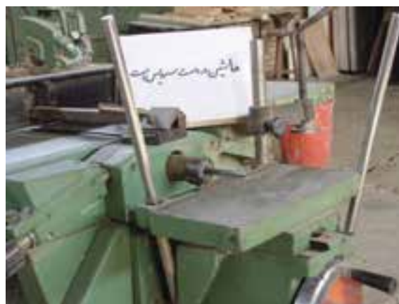
شکل ۱۰-۸- تابلوی هشدار سرویس‌کاری.
