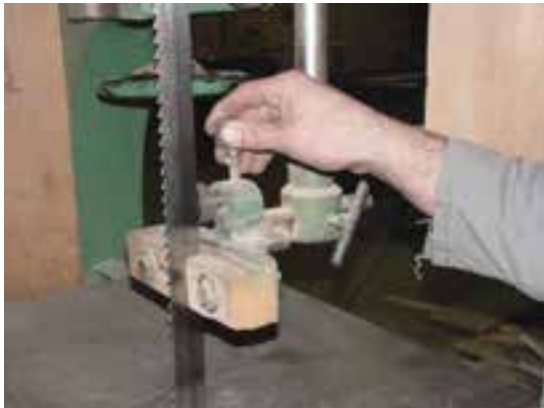
شکل ۵۲-۱- نمونه‌ی تنظیم فاصله‌ی بلبرینگ با پشت تیغه
