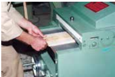
شکل ۳۷-۷- نمونه‌ی رندیدن چوب نازک.
