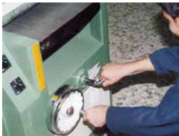
شکل ۷-۳۴ - تنظیم مقدار بار گندگی.
