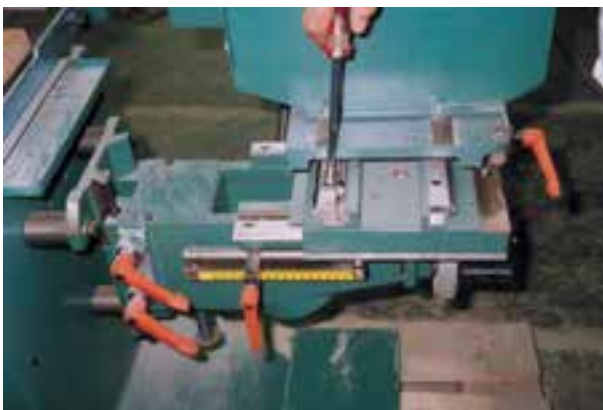
شکل ۱۴-۱- کنترل پیچ‌های دستگاه هدایت.
