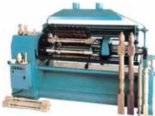
شکل ۱۱-۳ - ماشین خراطی تمام اتوماتیک
