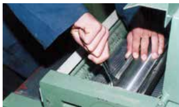
شکل ۲۴-۷- نمونه‌ی بستن تیغه‌ها به توپی.
