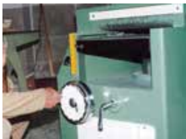
شکل ۲۱-۷- آزمایش روان بودن حرکت صفحه‌ی متمرک.
