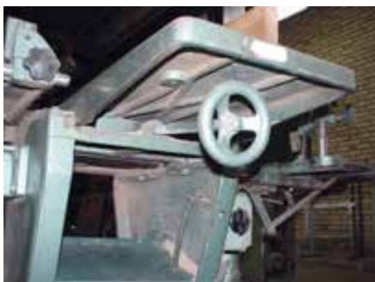
شکل ۳-۶- پیچ فلک‌ی تنظیم صمبه را باید با گازوییل شستشو نمود.
