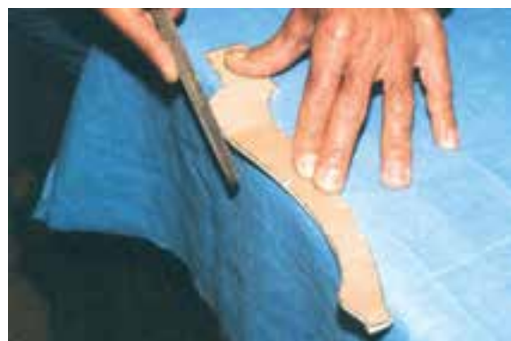
شکل ۱۸-۲۲- نمونه‌ی پرداخت کردن مسیر برش.
