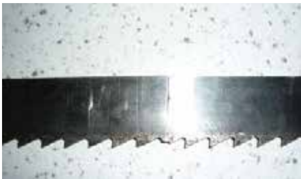
شکل ۱-۷۰- ترک تیغه اره از ممل جوش.
