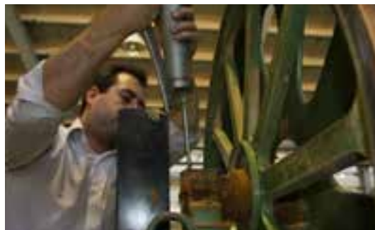
شکل ۳-۱. گریس‌کاری یاتاقان فلکه (اره).
