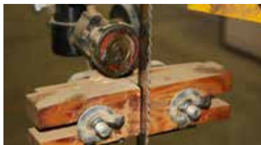
شکل ۳-۲. گریس‌کاری بلبرینگ تیغه (اره).
