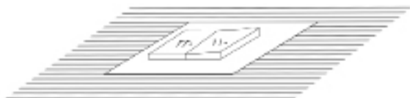
شکل ۱۴-۱۵- کلید تنظیم برق ۱۱۰ به ۲۲۰ ولت و برعکس.
