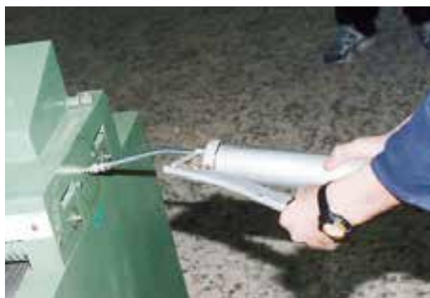
شکل ۸-۱. گریس‌کاری بلبرینگ یاتاقان‌ها.
