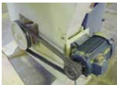
شکل ۳-۴. انتقال نیرو توسط تسمه.
