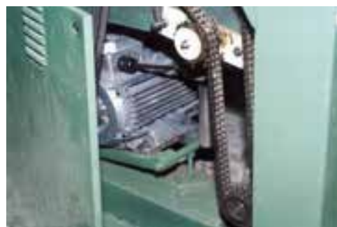
شکل ۱۳-۷. حفاظ تسمه، زنجیر، الکتروموتور و ...
