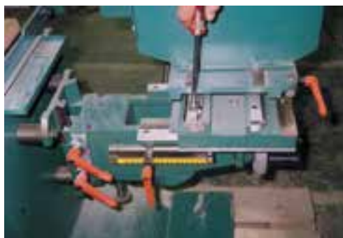
شکل ۱۰-۲۱ - سفت کردن پیچ‌های شُل شده.
