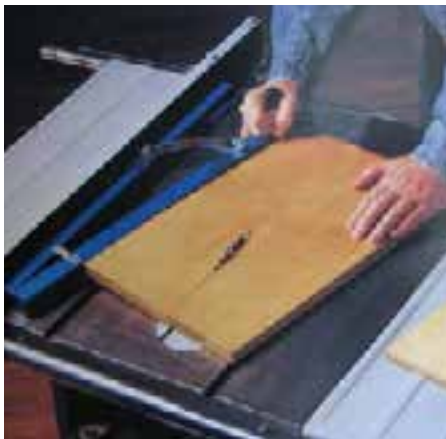
شکل ۱۲-۲۹- برش مورب با ابزار کمکی.
