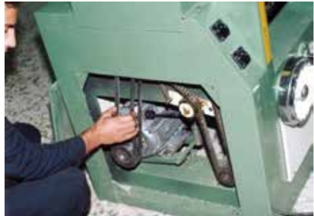
شکل ۸-۸- کنترل مقدار کشش تسمه‌ها.
