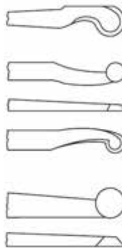
شکل ۱۱-۱۷- مغارهای مخصوص سطوح مقعر و فضاها داخلی.
