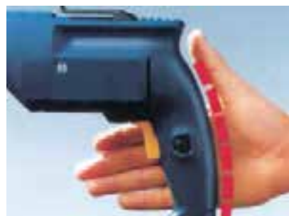
شکل ۱۹-۴۰ - دسترسی دکمه‌ی روشن و خاموش دریل.
