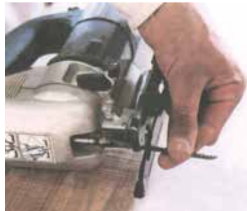
شکل ۱۵-۴۱- تعویض تیغه اره.
