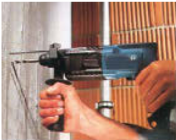
شکل ۱۹-۵۱- دریل با میله‌ی عمق‌سنج.
