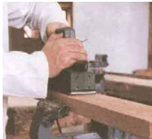
شکل ۱۷-۱۴- نمونه‌ی بستن چوب دافل گیره
