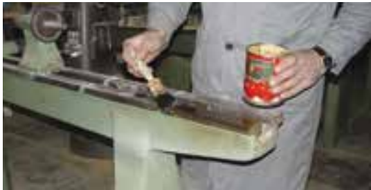
شکل ۱۱-۴۵- تمیزکاری قسمت‌های ضروری و بدون رنگ ماشین.
