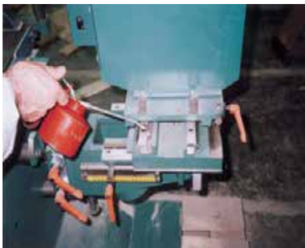
شکل ۱۳-۱- روغن‌کاری ممل ریل‌ها.
