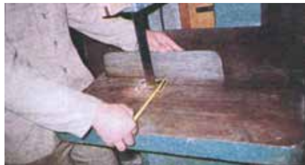
شکل ۱-۴۳-۱- اندازه‌گیری فاصله تیغه با گونیا.
