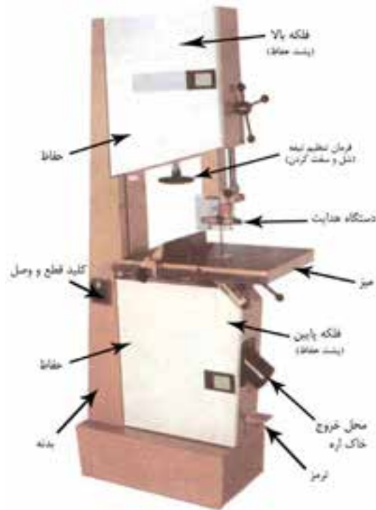
شکل ۴-۱. قسمت‌های مختلف یک ماشین اره‌نواری.
