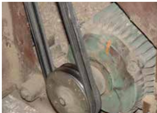
شکل ۱۰-۴- الکتروموتور ماشین کفرنده.
