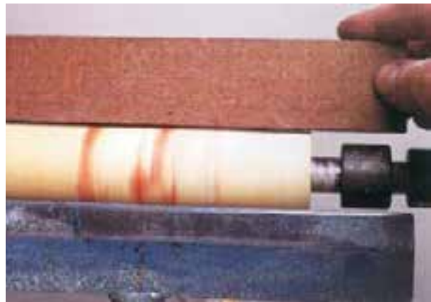
شکل ۱۱-۵۱- کنترل صافی قطعه چوب گرد شده.
