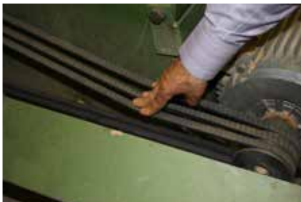
شکل ۲۲-۱- تنظیم سفتی تسمه
