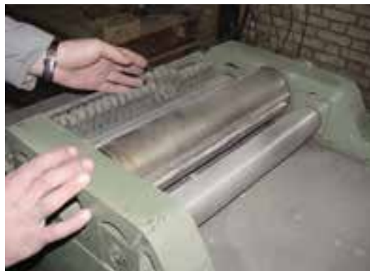
شکل ۷-۲۹- کنترل تمیزی شانه‌ها.
