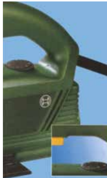
شکل ۴-۱۵- پیچ تنظیم دور، که زیر دسته و روی موتور نصب شده است.
