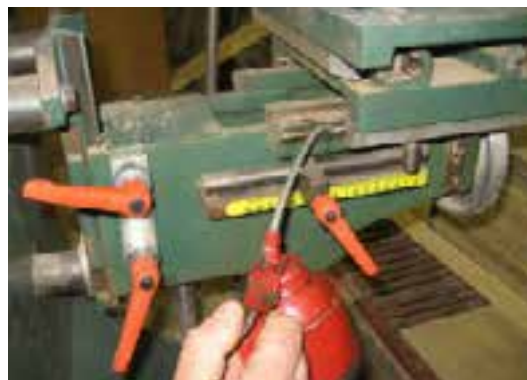
شکل ۱۰-۱- (روغن‌کاری ریل‌ها و کشوهای صفحه‌ی متمرک.
