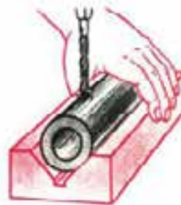
شکل ۱۹-۳۸ - سوراخ‌کاری جسم استوانه‌ای.
