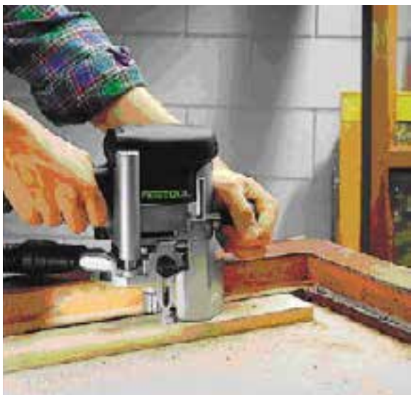
شکل ۱۶-۷- برداشتن قسمت اضافی سه لایه.
