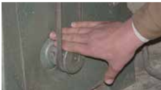
شکل ۵-۶- مراقبت از انگشتان به هنگام تعویض تسمه.
