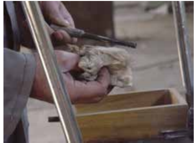
شکل ۱۶-۱۰- تمیز کردن مته‌های خارج شده از ماشین.
