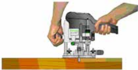
شکل ۱۶-۲۶- دوراهاه زدن قطعه کار با دستگاه اورفرز.
