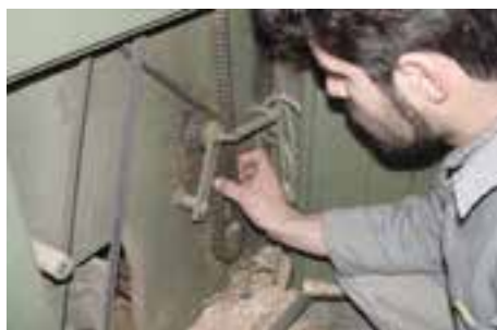
شکل ۲۷-۷- تنظیم و آزمایش سفتی زنجیر انتقال نیرو.
