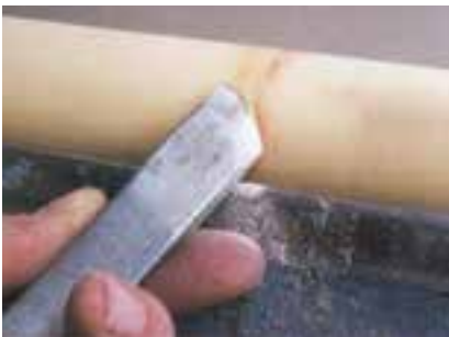
شکل ۱۱-۱۵- مغار نیم‌گرد، برای موه‌گیری و صاف کردن سطوح.
