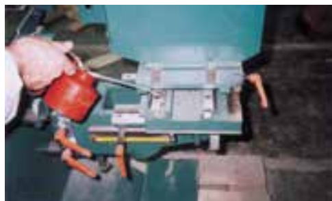
شکل ۱۰-۲۰ - روغن کاری ریل‌ها.
