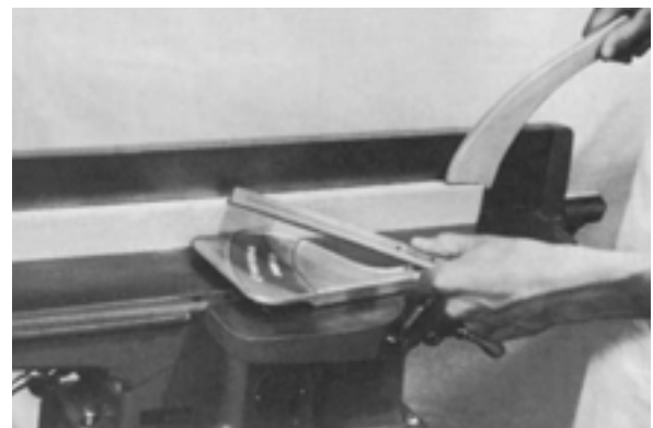
شکل ۱۷-۴- الف - رنده کردن انتهای چوب‌های باریک.
