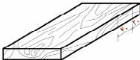
شکل ۹.۳۵ - نر چوب، ابتدا ۲۰ میلی‌متر و سپس ۴۰ میلی‌متر خط‌کشی شود.
