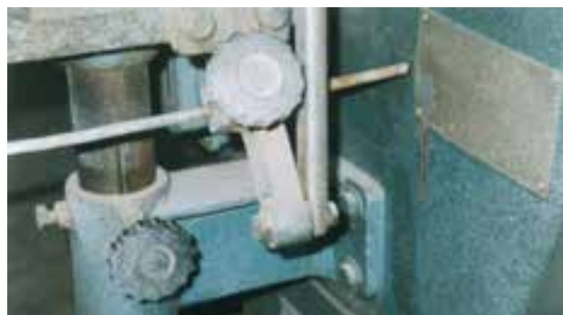
شکل ۹-۸ - سیستم تنظیم عمق کُم.
