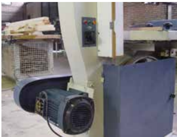
شکل ۲۷-۱- الکتروموتور تک فاز با فازن راه انداز.
