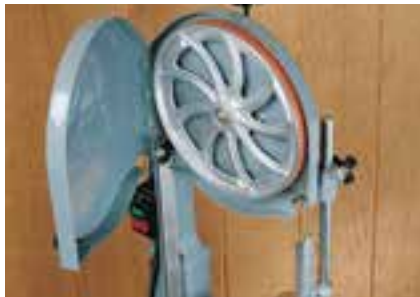
شکل ۴-۲. مفاظ باز شده‌ی روی فلکه و تیغه.
