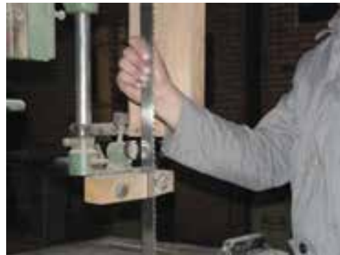
شکل ۵۱-۱- کنترل سفتی تیغه به کمک دست.
