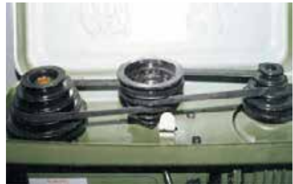
شکل ۱۹-۱۳- تغییر دور پله‌ای در دستگاه دریل ستونی.
