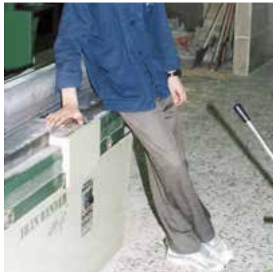
شکل ۱۹-۴- تماس دست با تیغه قطر آفرین است.
