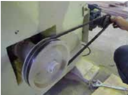
شکل ۳-۱۶. تعویض تسمه فرسوده.
