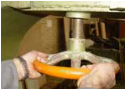
شکل ۳-۲. فرمان جابجایی (بالا و پایین) فلکه اره. حفاظ‌های روی فلکه و تیغه، باز شود (شکل ۲-۴).
