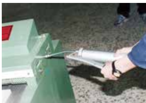
شکل ۸-۱۳- گریس‌کاری یاتاقان‌های ماشین.
