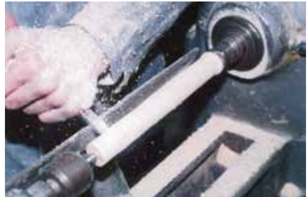
شکل ۱۱-۶۲- یکنواخت کردن چوب.
