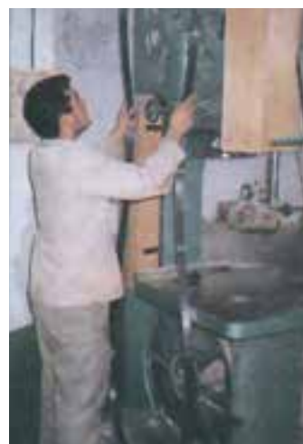
شکل ۱۰-۲- نمونه‌ی فارغ کردن تیغه اره.
