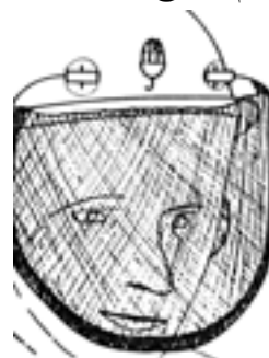
شکل ۱۱-۱۹- در هنگام عملیات فراطی، باید از عینک و ماسک
