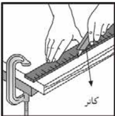
شکل ۱۵-۲۱- تعیین مسیر برش توسط فمکش و کاتر
