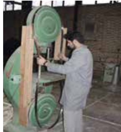
شکل ۶-۲- نمونه‌ی جا انداختن تیغه اره.
