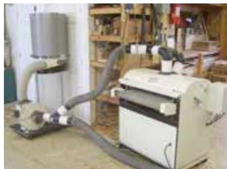
شکل ۷-۳۳ - با سیستم مکنده، محیط کار همواره پاکیزه است.
