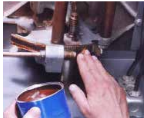
شکل ۱۲-۳۴- گریس‌کاری پرغ دنده‌ها.
