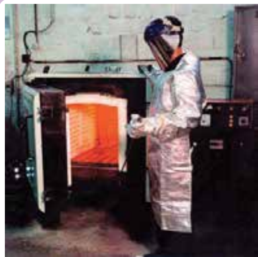
کوره عملیات حرارتی آزمایشگاهی
