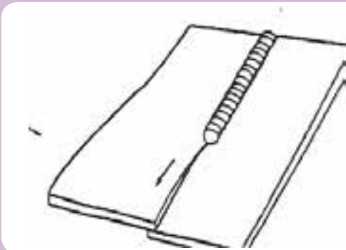
شکل ( ) قطعه فلزی در امتداد عرضی دچار پیچیدگی شده، و باعث گردیده است لبه های دو قطعه کار در قسمت جلویی خط جوش روی یکدیگر قرار گیرند.
