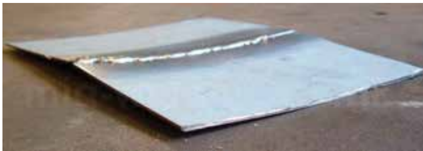
تاب برداشتن ورقه فولادی که بدون قید و بند بوسیله جوشکاری به هم متصل شده اند
