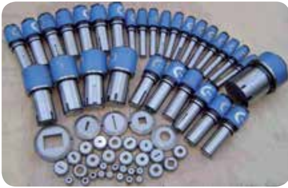
نمونه های سنبه‌های دستگاه پانچ CNC
