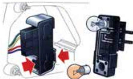
شکل (۱۰۱-۲) تعویض لامپ چراغ راهنما و ترمز عقب
