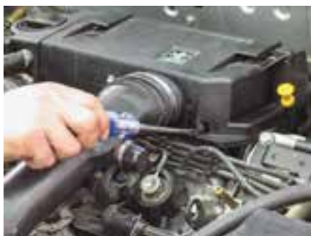
شکل (۲-۶۵) نصب در پوش محافظه فیلتر هوا
