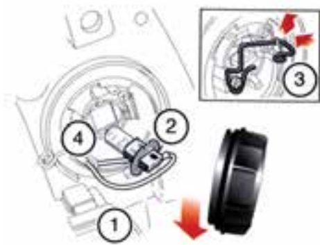
شکل (۲-۹۵) تعویض لامپ چراغ نور پایین
