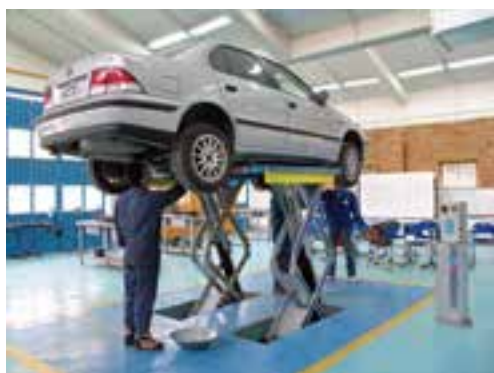
شکل (۲-۷۲) خودرو روی بالابر در ارتفاع مناسب
