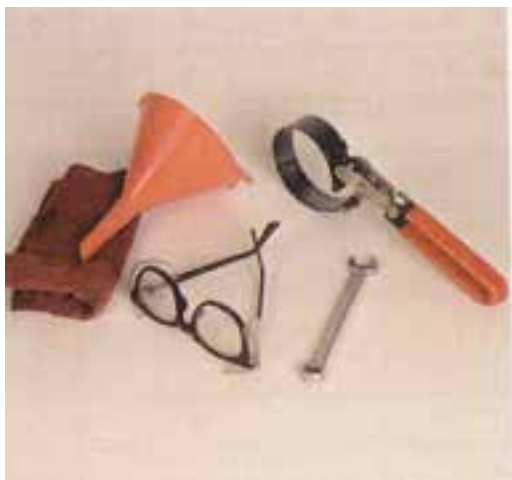
شکل (۲-۴۳) ابزار عمومی و بازبست فیلتر
