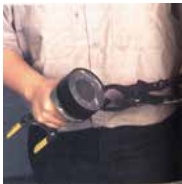
شکل (۱-۵۱) استفاده از رینگ جمع کن
