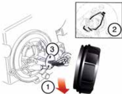
شکل (۲-۹۴) تعویض لامپ چراغ جلو نور بالا
