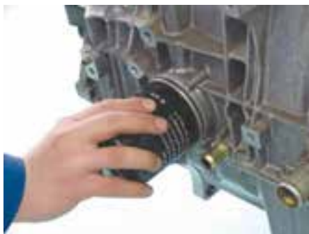
شکل (۲-۵۴) نصب و محکم کردن فیلتر
