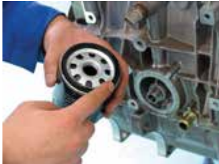
شکل (۲-۵۳) کنترل دندانه و واشر لاستیکی فیلتر
