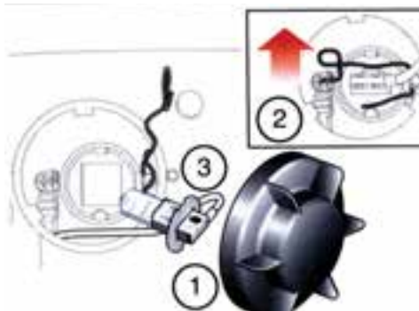
شکل (۱۰۰-۲) تعویض لامپ چراغ مه شکن جلو
