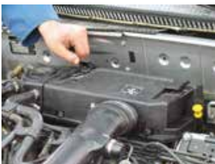
شکل (۲-۶۳) بازکردن در هواکش
