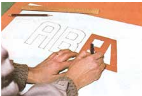
شکل ۳-۱۱ - استفاده از شابلون (قالب)
