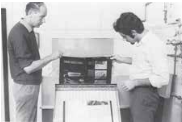
شکل (۳-۱۱) دستگاه ظهور فرم نایلونی
