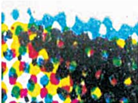
شکل (۶-۱) ساختار نقاط در فرآیند چاپ
