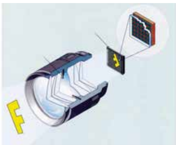
شکل (۴-۵) استفاده از CCD به جای فیلم در دوربین‌های عکاسی دیجیتال
