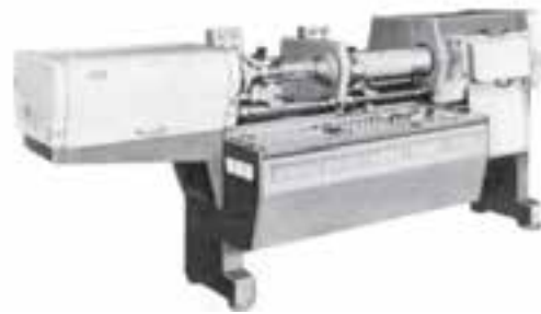
شکل (۲-۳۳) نمونه‌ای از اسکنر درام
