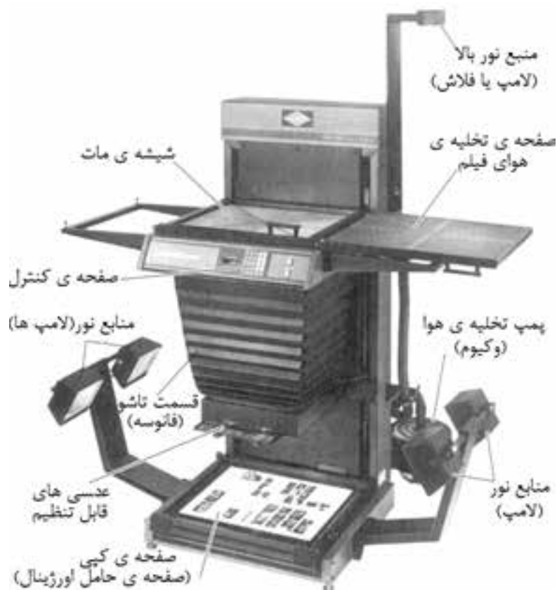
شکل ۳-۴۹- قسمت های اصلی یک دوربین عمودی استاندارد
