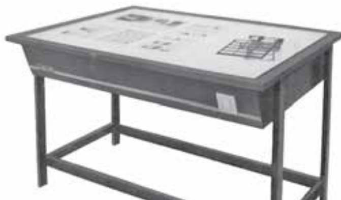
شکل ۸۲-۳- مونتاژ فیلم‌ها بر روی میز مونتاژ
