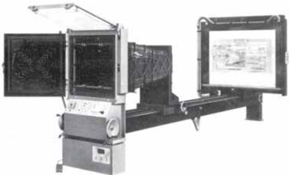
شکل ۳-۵۰- دوربین رپرو داکشن افقی در حال کار
