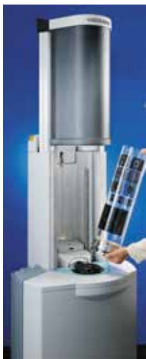
شکل ۱۴-۱- دستگاه اسکنر درام استوانه‌ای برای ثبت تصاویر
