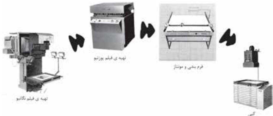
شکل ۱-۲۵- مراحل مختلف لیتوگرافی از تهیه ی فیلم تا پلیت
