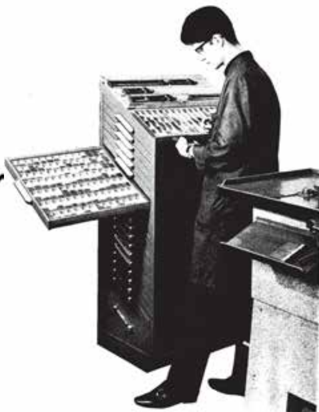
شکل ۷-۱- نمایش حروف چینی دستی و قفسه‌ی گارسه (جعبه دسته بندی حروف) با ۲۰ گارسه محتوی انواع حروف با فونت و بزرگی های مختلف
