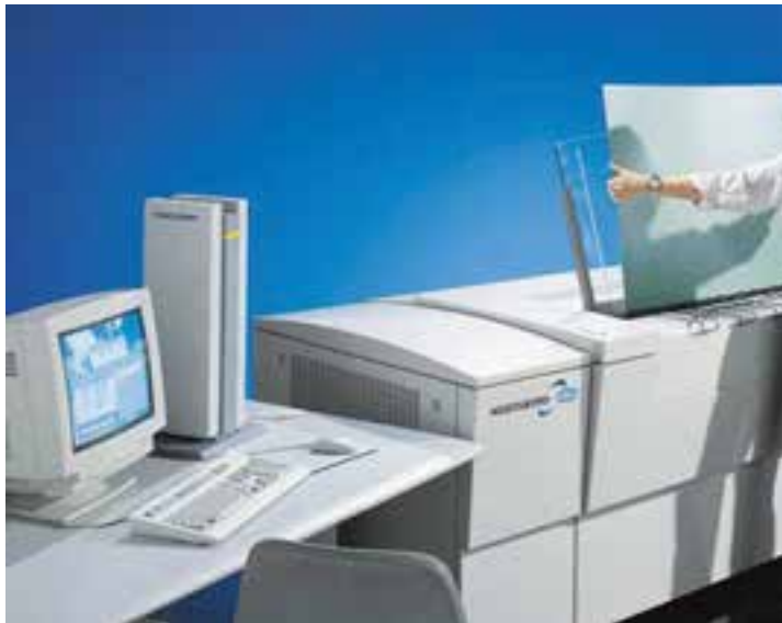
شکل ۱۹-۱- سیستم کامپیوتر به پلیت دیجیتالی برای نوردهی پلیت
