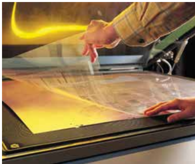
شکل ۱۷-۱- قرار گیری مونتاژ فیلم در قید کپی به منظور تهیه پلیت
