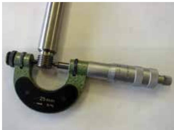
شکل ۱-۲۴۱ اندازه‌گیری شیار رزوه و پیچ
