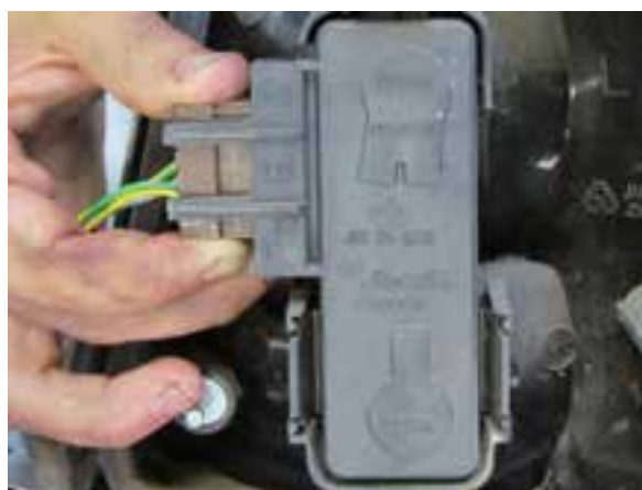
شکل ۲-۱۵۰ جداکردن کانکتور
