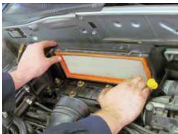
شکل ۲-۱۴ نصب فیلتر هوای نو
