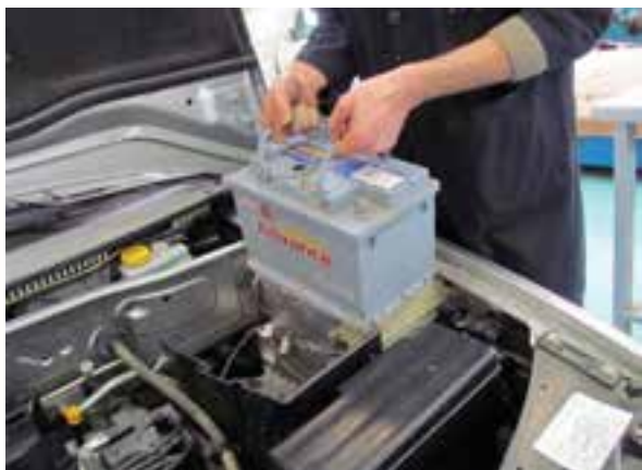
شکل ۲-۱۰۱ خارج کردن باتری از خودرو
