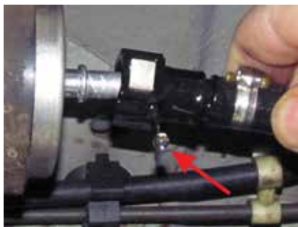
شکل ۲-۶۷ خارج کردن شیلنگ ورودی
