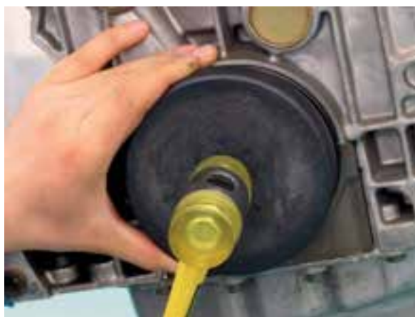
شکل ۳-۳۱۵ نصب کاسه‌نمد به وسیله ابزار مخصوص
