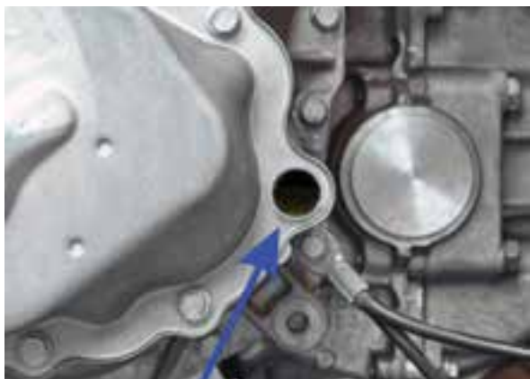
شکل ۲-۵۶ دریچه بازديد روغن جعبه‌دنده
