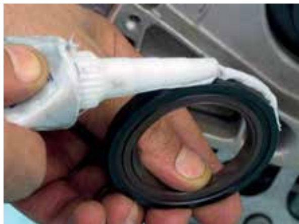
شکل ۳-۳۱۰ چسب زدن کاسه‌نمد سر میل‌لنگ
