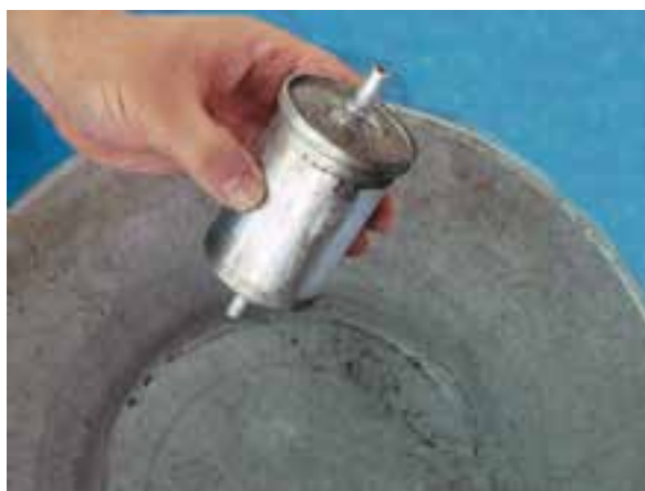
شکل ۲-۷۳ تخلیه بنزین داخل فیلتر بنزین
