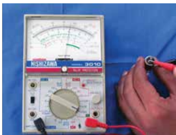
شکل ۲-۱۵۶ آزمایش لامپ چراغ ترمز
