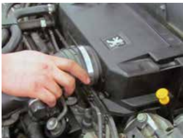
شکل ۲-۲۰ جازدن لوله مکندۀ هوا
