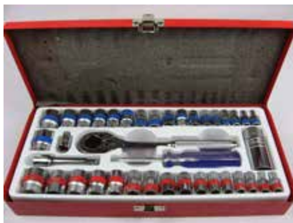
شکل ۱-۷۳ جعبه بوکس ۳۹ پارچه میلی متری و اینچی
