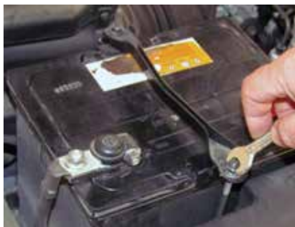
شکل ۲-۱۰۴ بازکردن بست نگهدارنده باتری
