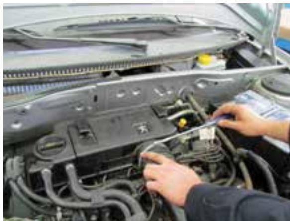
شکل ۲-۲۱ بستن پیچ بست لوله مکندۀ هوا
