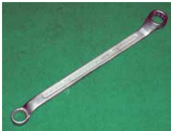
شکل ۱-۱۸ آچار رینگی سر کج برای مواضع کم‌عمق
