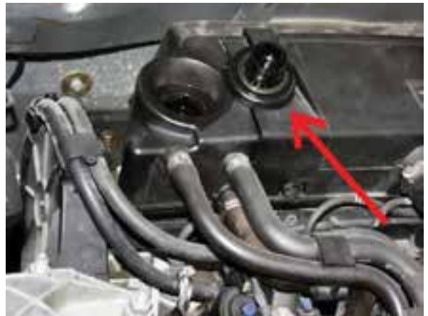
شکل ۲-۴۵ بازکردن در محفظه روغن
