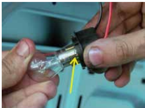
شکل ۲-۱۶۱ نحوه قرار گرفتن لامپ در داخل پایه
