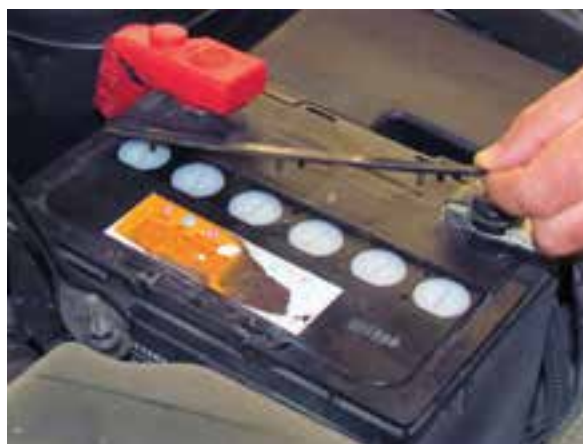
شکل ۲-۱۰۶ خارج کردن صفحه بالای درپوش‌ها
