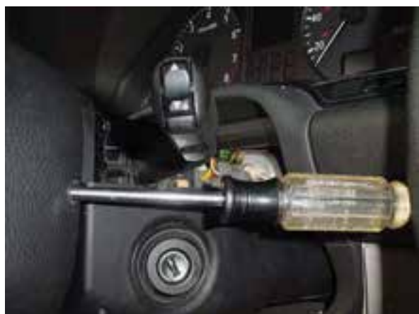
شکل ۱-۱۱۰ کاربرد آچار پیچ‌گشتی مغناطیسی
