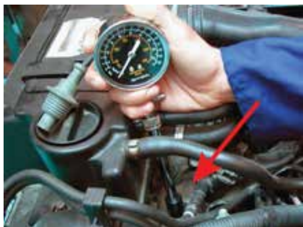
شکل ۱-۲۱۷ کاربرد کمپرس سنج
