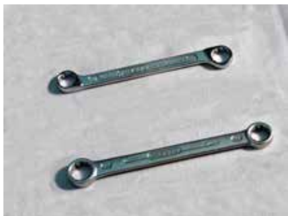
شکل ۱-۲۳ آچار رینگی سر کج و تخت
