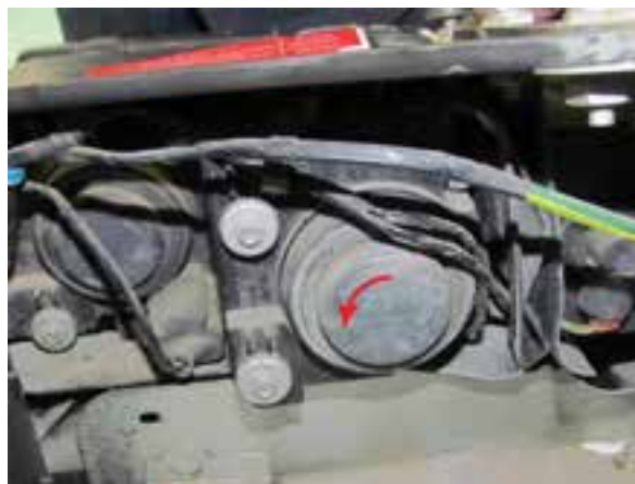
شکل ۲-۱۱۸ بازکردن قاب چراغ
