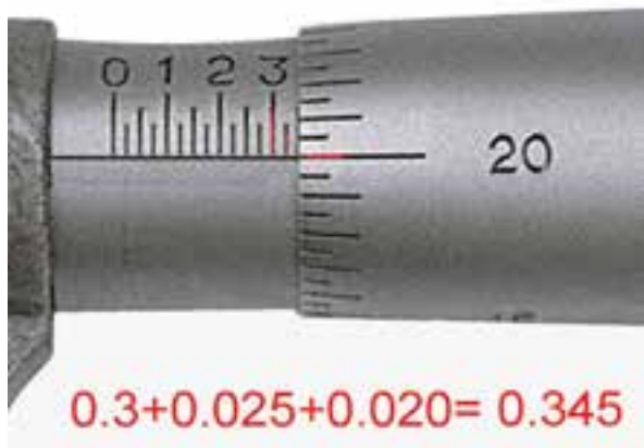
شکل ۱-۲۳۹ نحوه خواندن میکرومتر
