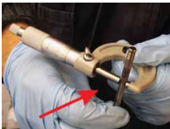
شکل ۱-۲۴۲ اندازه‌گیری قطر ساقه سوپاپ
