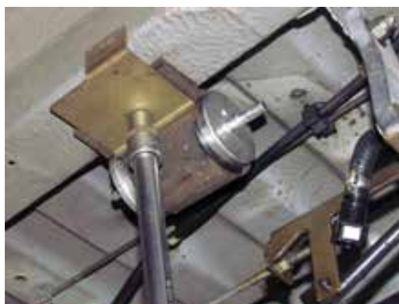
شکل ۲-۷۱ باز کردن پیچ نگهدارنده فیلتر بنزین
