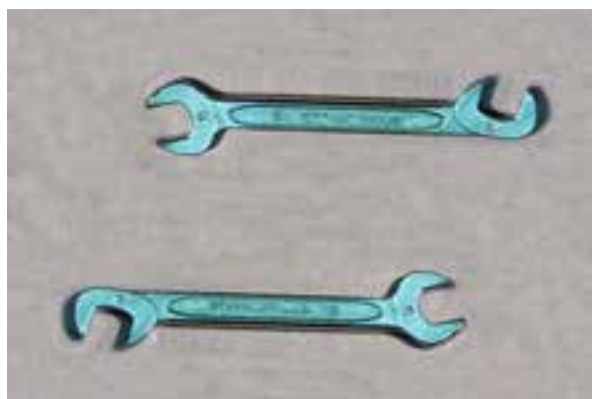
شکل ۱-۷ آچار دوسر تخت با انحراف دهانه ۶۰ درجه
