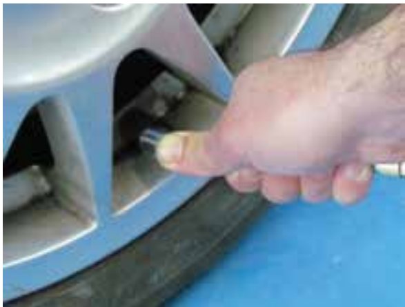
شکل ۲-۱۶۵ اتصال فشارسنج به تایر
