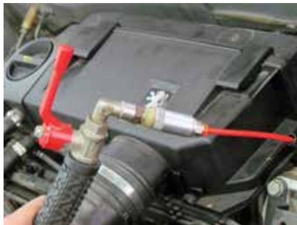
شکل ۲-۳۵ بازکردن شیر اصلی و دستگاه ساکشن
