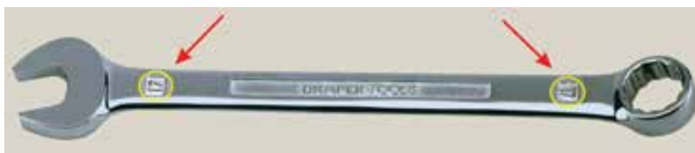
شکل ۱-۳۰ آچار ترکیبی یکسر رینگ - یکسر تخت، فلش ها اندازه دهانه های آچار را نشان می دهد.
