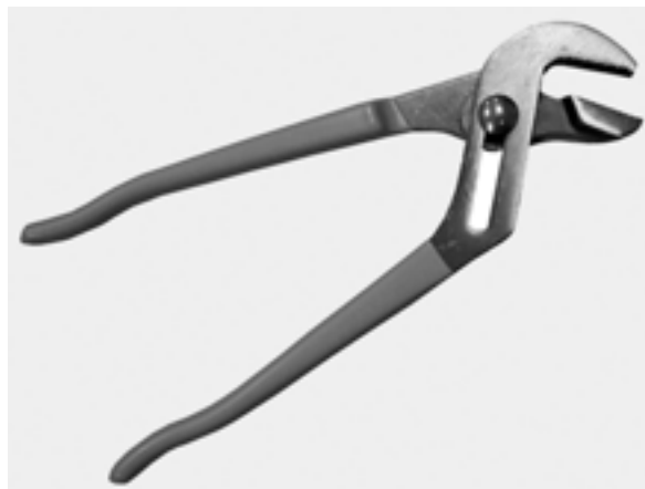
شکل ۱-۱۳۴ انبر کلاغی با شیار صاف
