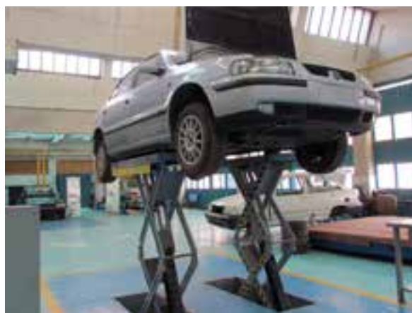
شکل ۲-۴۹ بالا بردن خودرو با جک قیچی
