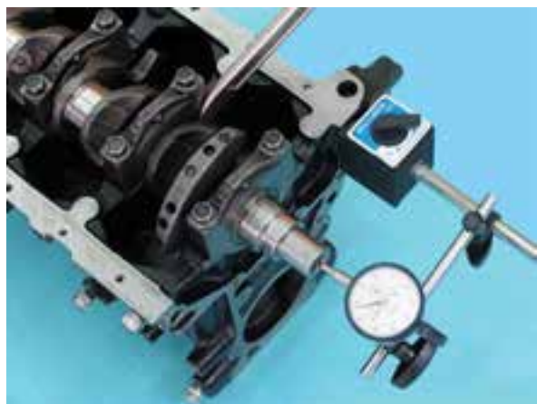
شکل ۱-۲۵۱ نحوه اندازه گیری لقی طول میل لنگ
