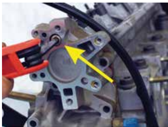
شکل ۱۹۰ کاربرد آچار آلن شش‌گوش
