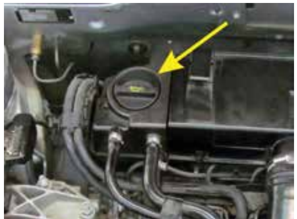
شکل ۲-۴۷ بستن در محفظه روغن
