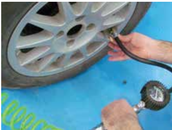
شکل ۲-۱۶۷ افزودن هوای فشرده به تایر
