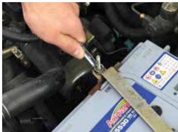
شکل ۲-۱۰۰ بازکردن بست نگهدارنده باتری
