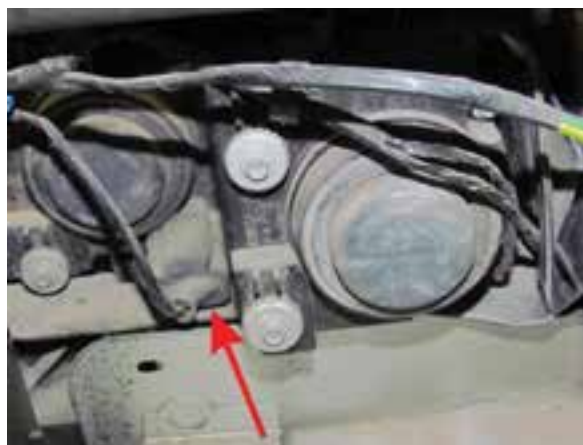
شکل ۲-۱۳۰ گردگیر روی کانکتور چراغ پارک
