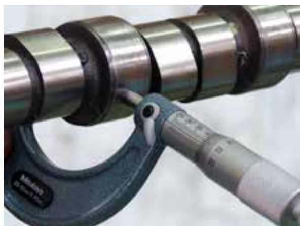
شکل ۱-۲۴۳ اندازه‌گیری قطر یاتاقان ثابت میل بادامک
