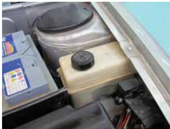
شکل ۲-۷۹ مخزن روغن هیدرولیک فرمان
