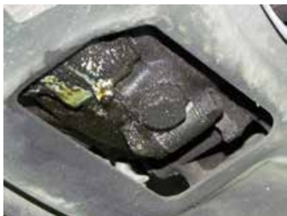
شکل ۲-۵۲ آثار نشتی روغن
