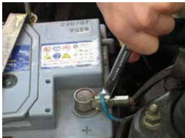
شکل ۲-۹۹ بازکردن بست اتصال ترمینال مثبت
