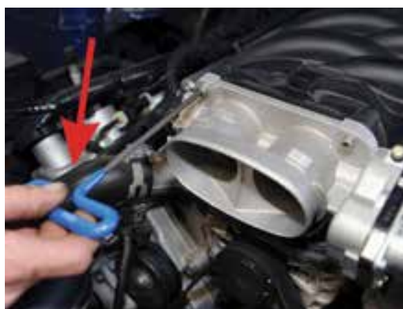
شکل ۱۸۷ کاربرد آچار آلن دسته‌دار
