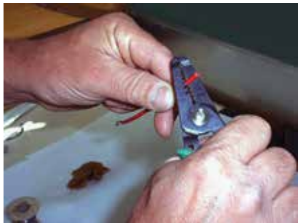
شکل ۱-۱۵۳ انبر سیم لخت کن و عملکرد آن
