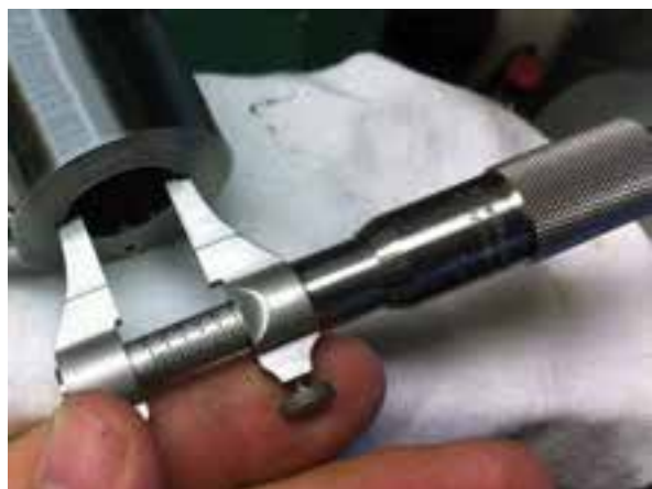
شکل ۱-۲۴۷ کاربرد میکرومتر اندازه گیر دهانه داخلی
