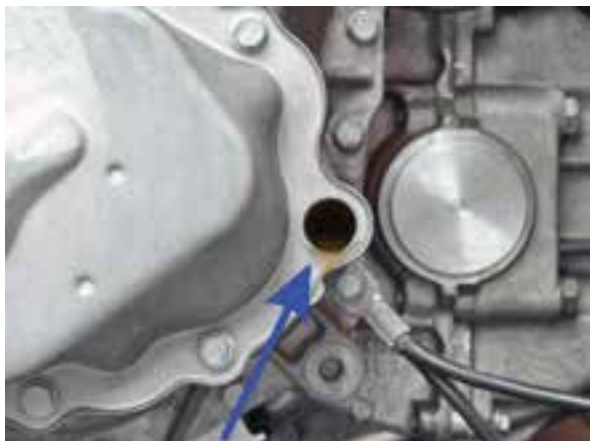
شکل ۲-۶۰ سرریز روغن از دریچه بازديد
