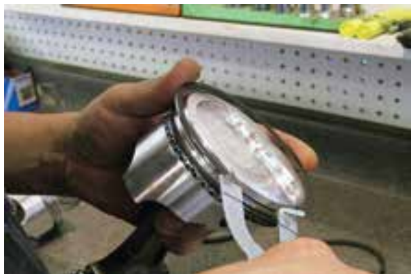
شکل ۱-۱۸۳ کاربرد رینگ بازکن
