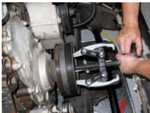
شکل ۱-۱۹۵ کاربرد پولی کش سه شاخه
