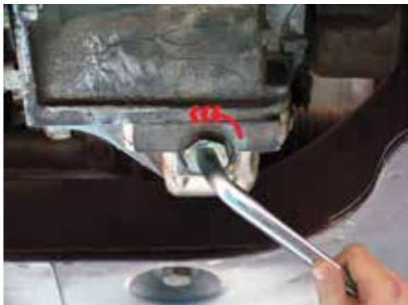
شکل ۲-۵۸ بازکردن پیچ تخلیه جعبه‌دنده
