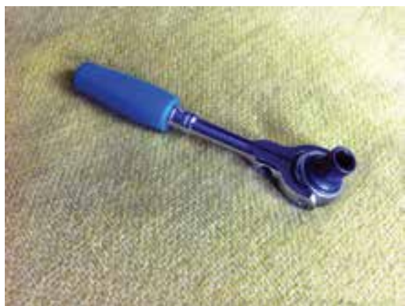
شکل ۱-۶۰ آچار بوکس دسته جفجغه ای
