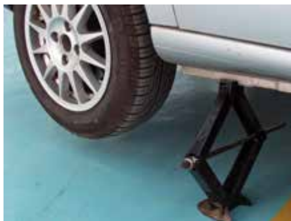
شکل ۱-۲۰۸ یک نوع جک مکانیکی (خاص خودرو)
