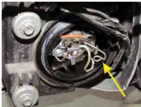
شکل ۲-۱۲۰ میله فنری نگهدارنده لامپ
