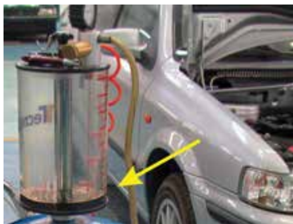
شکل ۲-۳۷ تخلیه روغن موتور به دستگاه ساکشن
