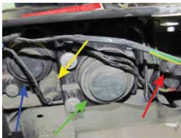
شکل ۲-۱۱۶ چراغ‌های داخل مجموعه چراغ‌های جلو خودرو
