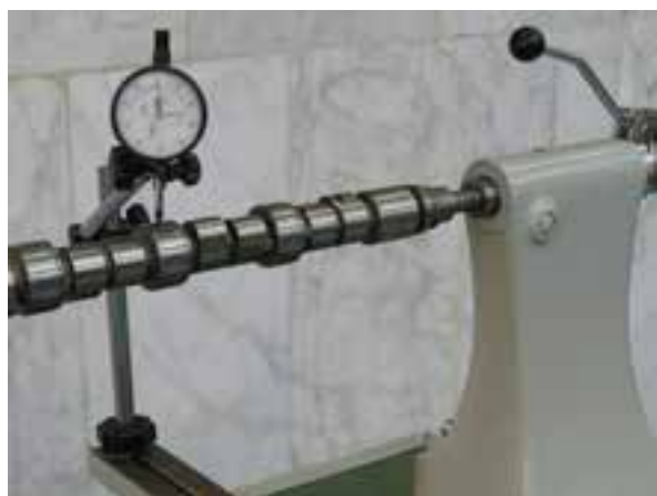
شکل ۱-۲۵۵ نحوه اندازه گیری دو پهن میل بادامک
