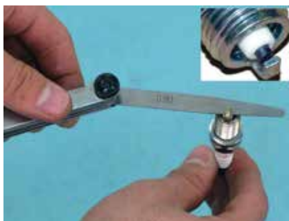
شکل ۱-۱۷۰ فیلرگیری دهانه شمع
