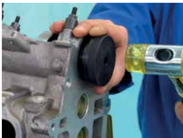
شکل ۳-۳۱۶ نصب کاسه‌نمد میل بادامک با ابزار مخصوص
