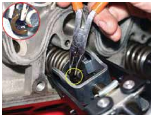
شکل ۱-۱۸۶ خارج کردن خار آزاد شده فنر سوپاپ
