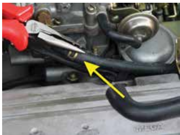
شکل ۱-۱۳۳ کاربرد انبر دم‌باریک
