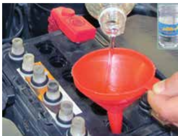
شکل ۲-۱۱۰ جبران کاهش سطح الکترولیت با آب مقطر
