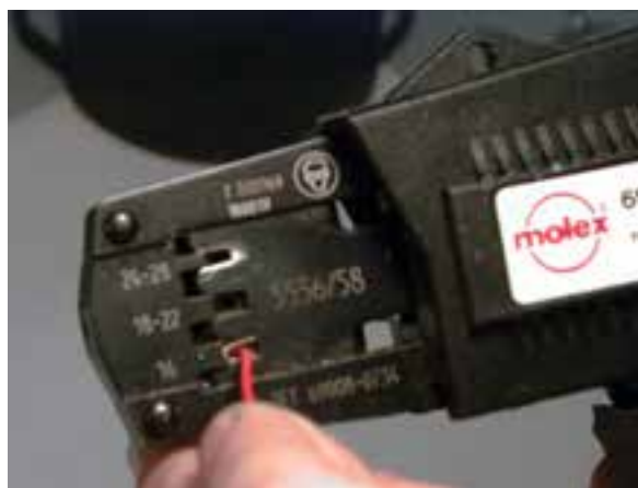
شکل ۱-۱۵۴ انبر پرچ کن سر سیم
