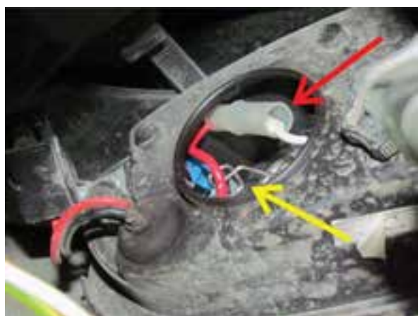
شکل ۲-۱۴۵ اتصال الکتریکی و میله فنری نگهدارنده لامپ
