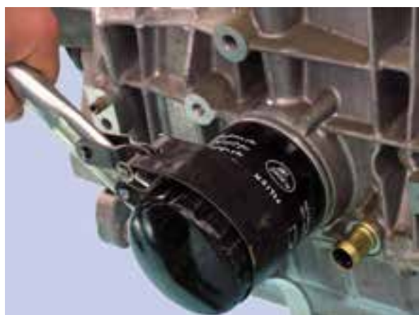
شکل ۲-۴۲ بازکردن فیلتر روغن
