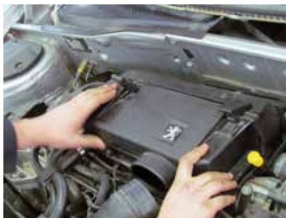
شکل ۲-۱۵ سوار کردن قاب محفظه فیلتر هوا
