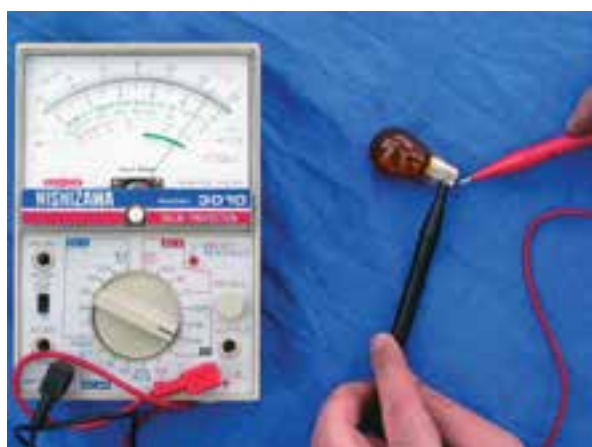
شکل ۲-۱۵۷ آزمایش لامپ چراغ راهنما
