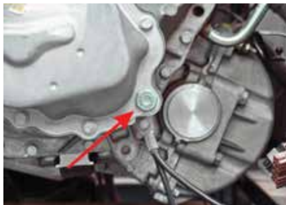
شکل ۲-۵۵ پیچ سرریز روی جعبه‌دنده
