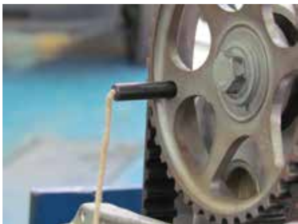
شکل ۱-۲۷۴ کاربرد پین تنظیم تایم میل بادامک
