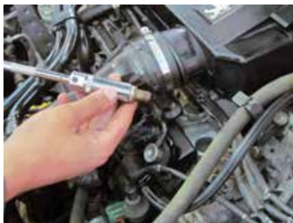
شکل ۲-۹۰ خارج کردن شمع از محل خود
