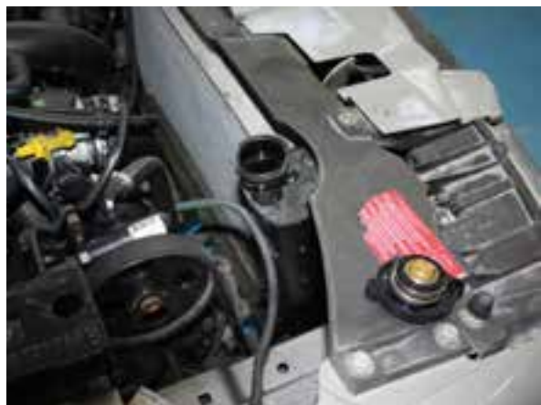
شکل ۲-۸۳ بازدید و بررسی سطح مایع خنک‌کننده
