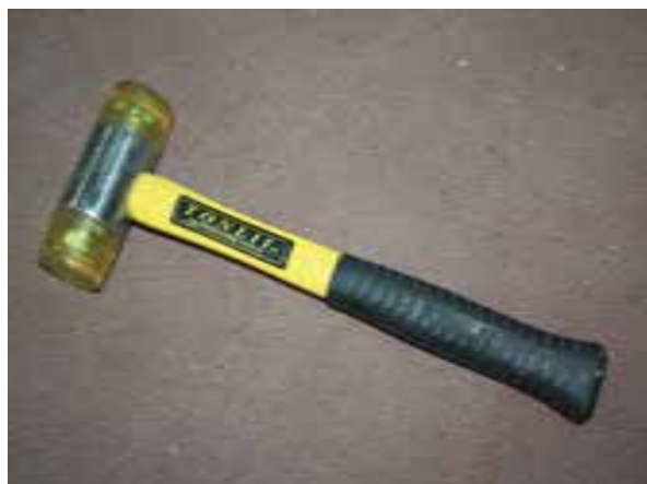
شکل ۱-۱۵۹ چکش دوسر پلاستیکی
