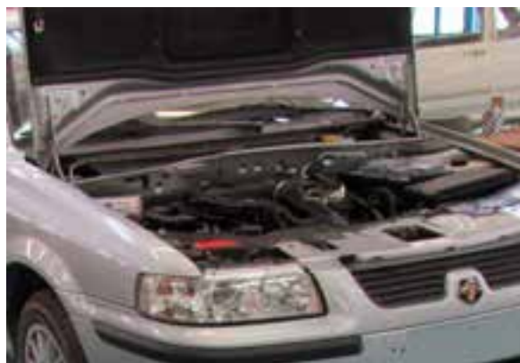
شکل ۲-۳ بازکردن در موتور خودرو
