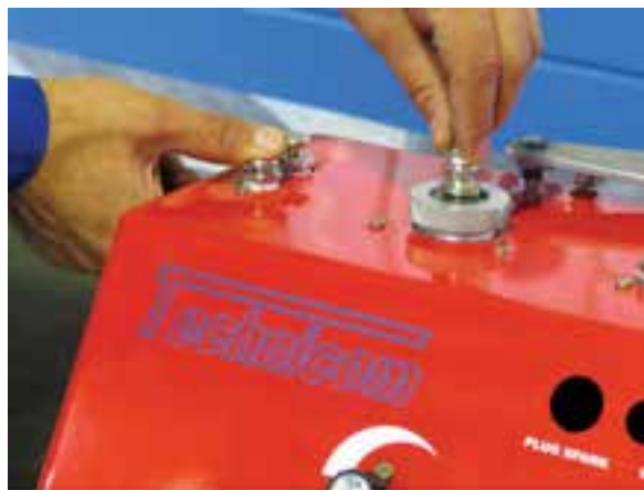
شکل ۲-۹۲ پاک‌کردن و تمیز کردن شمع با دستگاه
