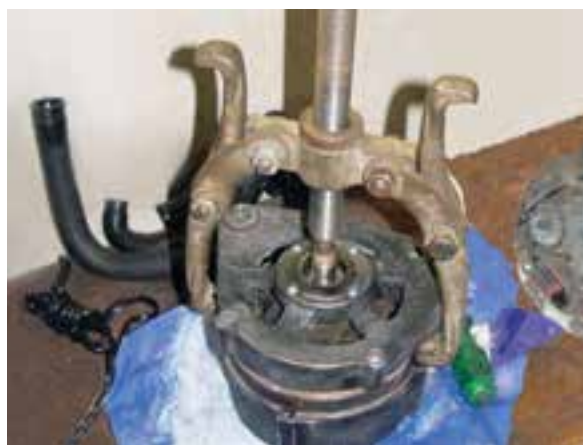
شکل ۱-۱۹۴ کاربرد پولی کش
