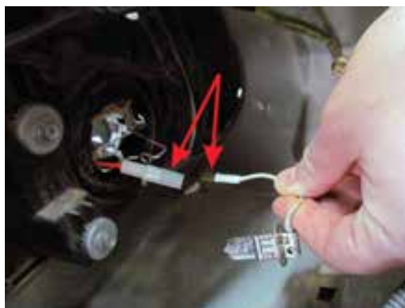
شکل ۲-۱۲۴ جدا کردن اتصال الکتریکی لامپ
