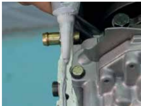
شکل ۳-۳۰۹ چسب زدن محل نصب واشر کارتر
