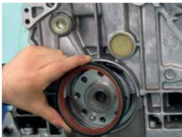
شکل ۳-۳۱۳ کاسه‌نمد انتهایی میل‌لنگ
