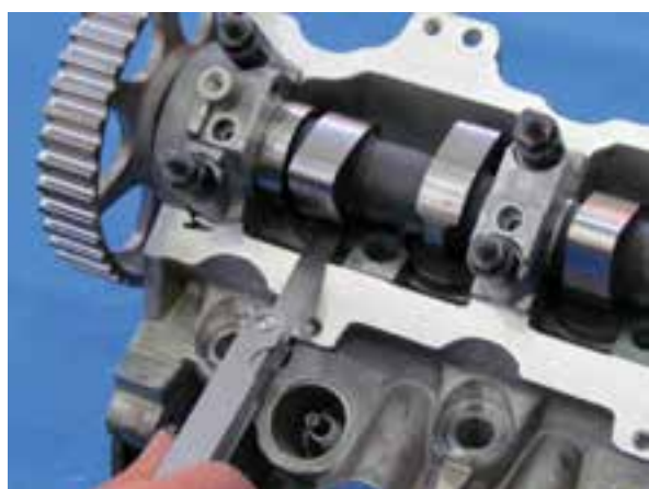
شکل ۱-۱۷۱ فیلرگیری سوپاپ
