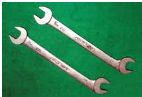
شکل ۱-۶ آچار دوسر تخت با انحراف دهانه ۳۰ درجه
