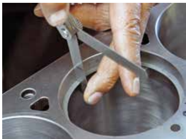
شکل ۱-۱۶۹ کاربرد فیلر برای اندازه‌گیری دهانه رینگ
