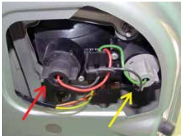
شکل ۲-۱۵۸ محل لامپ چراغ‌های دنده عقب و مه شکن
