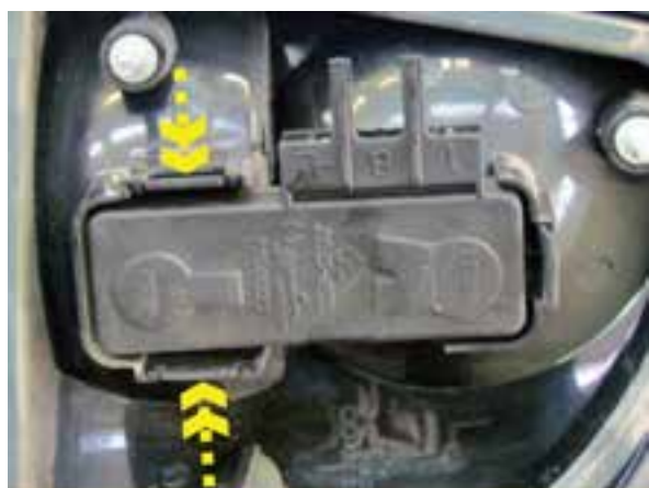
شکل ۲-۱۵۱ خارج کردن پایه لامپ‌ها
