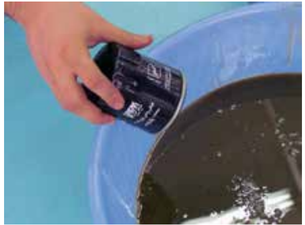
شکل ۲-۴۳ تخلیه روغن داخل فیلتر روغن
