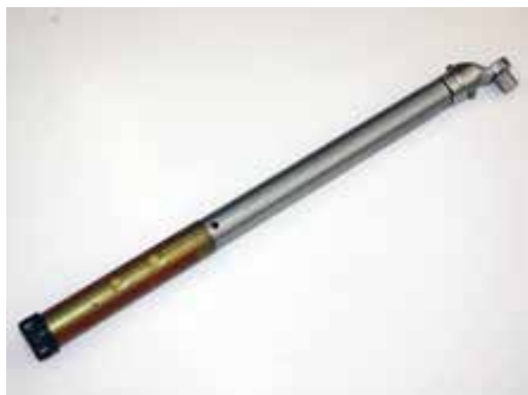
شکل ۱-۸۰ آچار درجه‌دار مکانیکی ضامن‌دار
