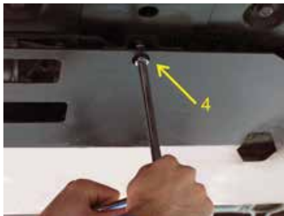
شکل ۲-۵۳ باز کردن پیچ‌های سینی زیر جعبه دنده
