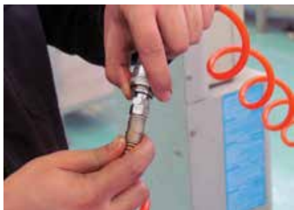
شکل ۲-۳۰ اتصال رابط شیلنگ هوای فشرده
