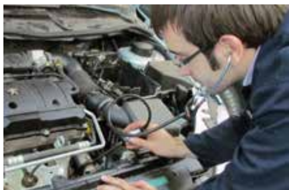
شکل ۱-۲۲۳ کاربرد گوشی تقویت صدا برای عیب‌یابی قطعه
