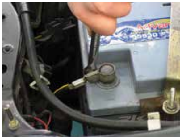
شکل ۲-۶۳ باز کردن بست کامل منفی باتری
