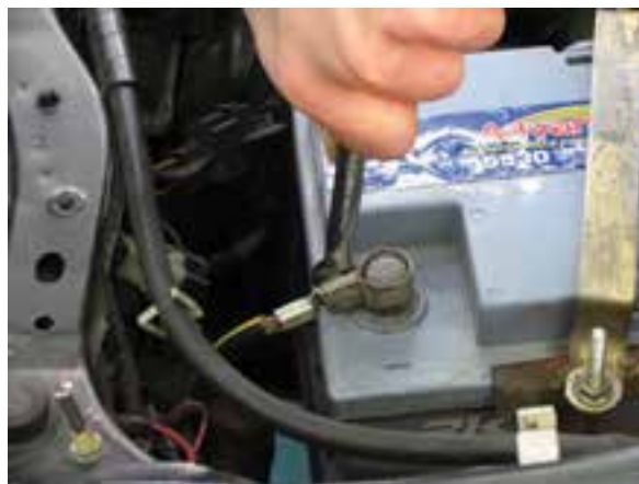
شکل ۲-۹۸ بازکردن بست اتصال ترمینال منفی باتری
