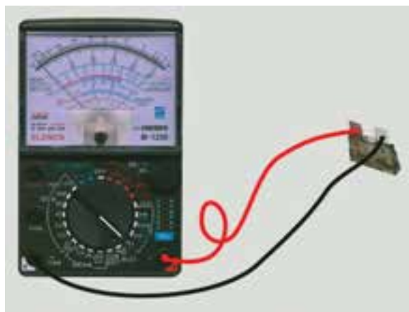
شکل ۱-۲۶۵ کاربرد مولتی متر برای آزمایش سالم بودن فیوز
