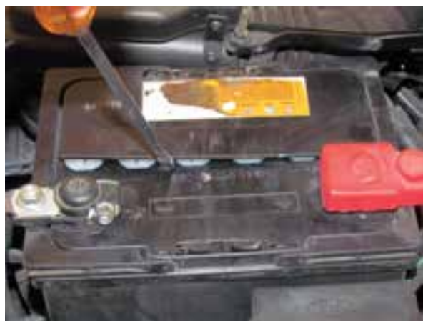
شکل ۲-۱۰۵ جداکردن صفحه روی درپوش‌ها
