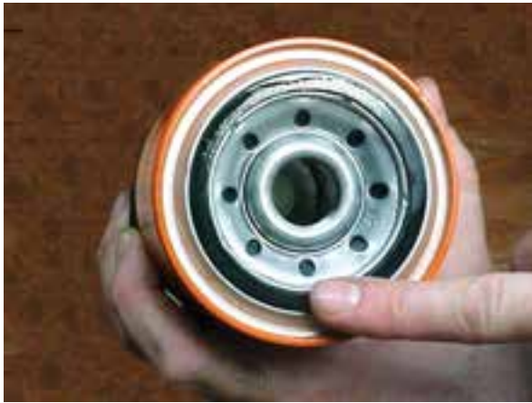
شکل ۲-۴۴ روغن زدن اورینگ فیلتر روغن
