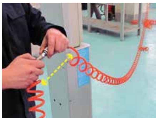
شکل ۲-۴۰ قطع اتصال شیلنگ هوای فشرده
