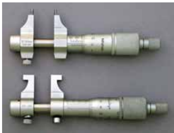
شکل ۱-۲۴۶ دو نوع میکرومتر اندازه گیر شکاف دهانه
