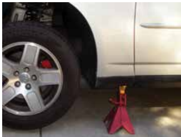
شکل ۱-۲۱۲ کاربرد پایه فلزی برای استقرار مطمئن خودرو
