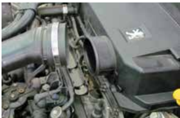
شکل ۲-۶ جدا کردن لوله مکند هوا
