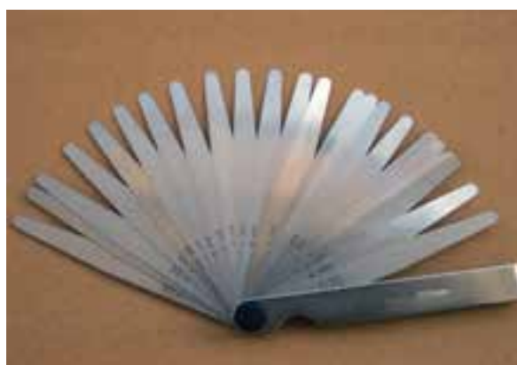
شکل ۱-۱۶۶ فیلر میلی‌متری ۲۰ تیغه
