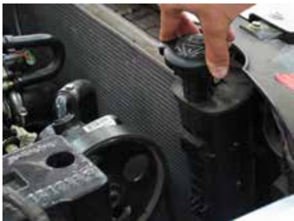
شکل ۲-۸۵ بستن درب رادیاتور (منبع انبساط)
