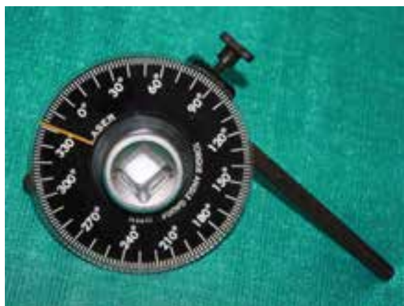
شکل ۱-۸۱ آچار تورک‌متر زاویه‌ای
