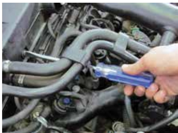
شکل ۲-۱۶ بستن پیچ قاب
