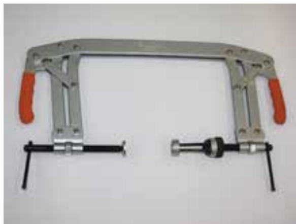
شکل ۱-۱۸۴ نوعی از فنر جمع کن سوپاپ
