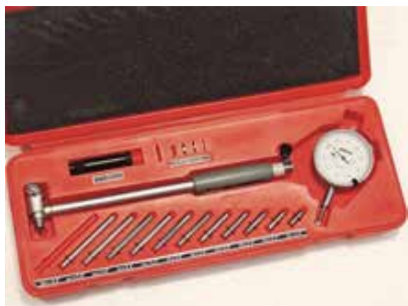
شکل ۱-۲۵۳ ساعت اندازه گیر نوع اینچی
