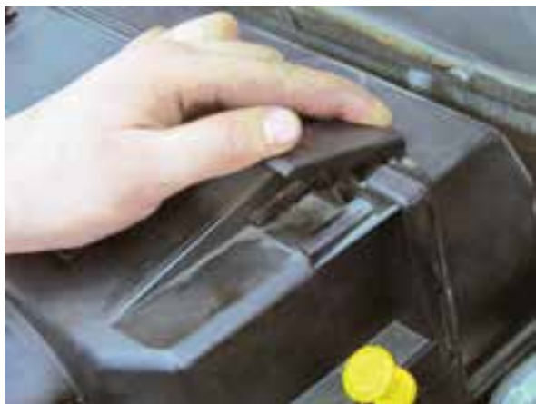
شکل ۲-۱۸ بستن بست نگهدارنده قاب
