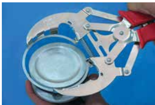
شکل ۱-۱۸۱ طرز کار رینگ بازکن
