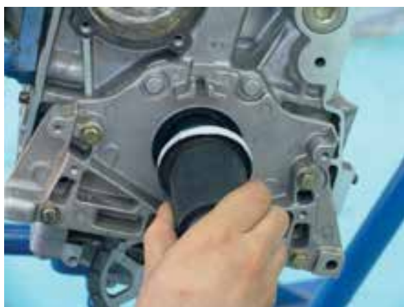
شکل ۳-۳۱۱ چسب زدن کاسه‌نمد سر میل‌لنگ
