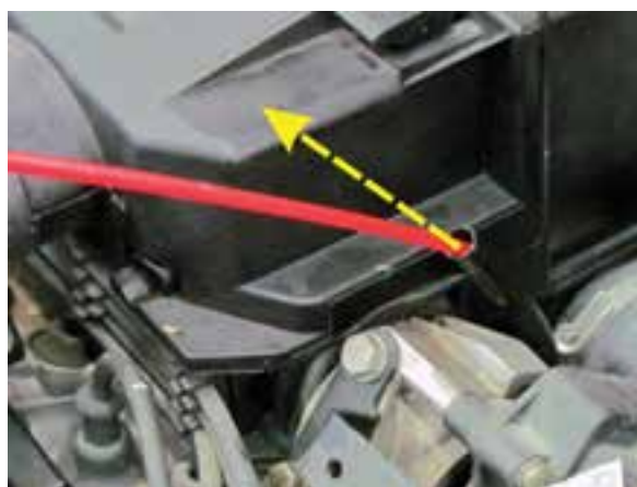
شکل ۲-۳۹ خارج کردن لوله رابط
