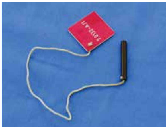
شکل ۱-۲۷۳ پین تنظیم تایم میل بادامک
