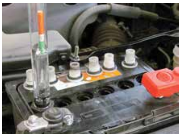
شکل ۲-۱۰۹ اندازه‌گیری چگالی الکترولیت
