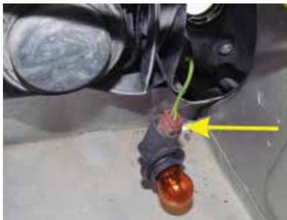
شکل ۲-۱۳۶ جداکردن کانکتور یا اتصال الکتریکی
