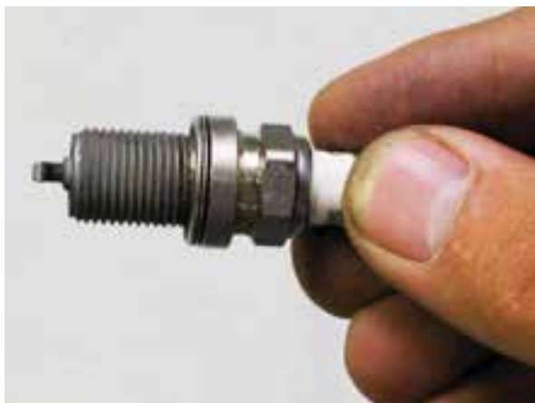
شکل ۲-۹۳ بررسی شمع پس از استفاده از دستگاه شمع پاک‌کن
