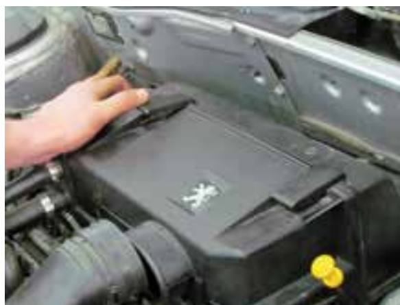
شکل ۲-۱۹ بستن بست نگهدارنده قاب
