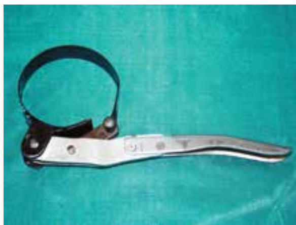
شکل ۱-۲۱۴ آچار فیلتر روغن
