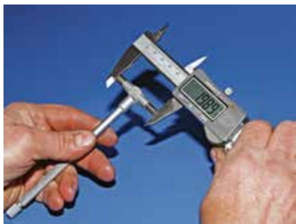
شکل ۱-۲۶۰ خواندن فاصله فک‌های اندازه‌گیر تلسکوپی
