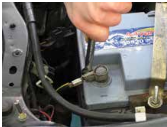
شکل ۲-۱۴۰ بازکردن بست اتصال ترمینال منفی باتری
