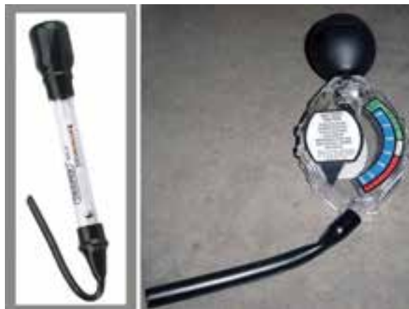
شکل ۱-۱۹۸ دو نوع چگالی سنج باتری (معمولی)
