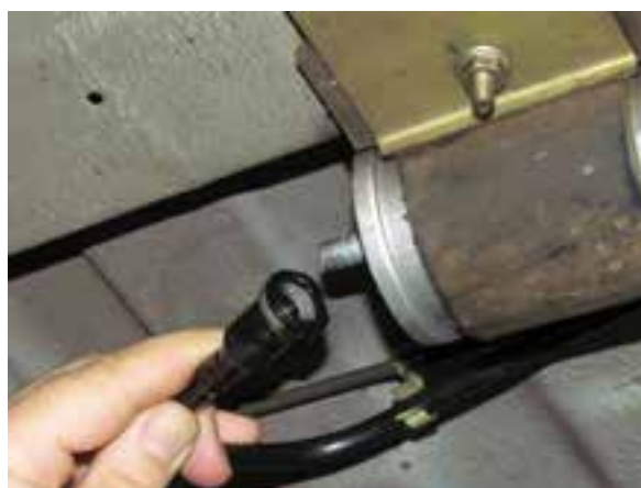
شکل ۲-۶۹ جدا کردن شیلنگ خروجی از فیلتر
