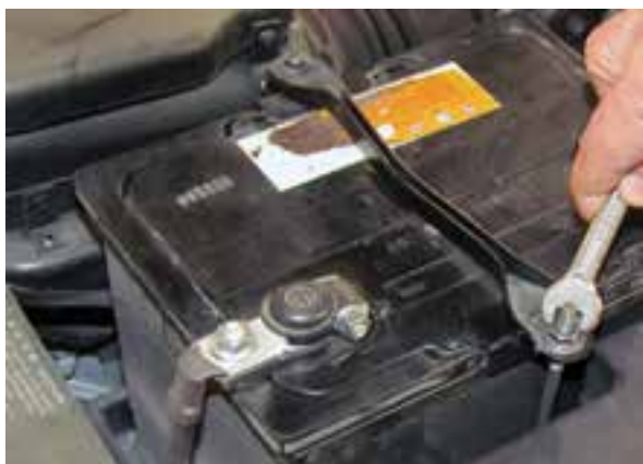
شکل ۲-۱۱۳ بستن بست نگهدارنده باتری
