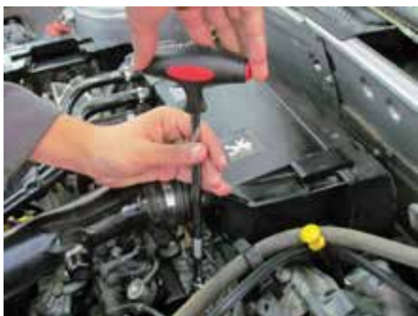
شکل ۲-۹۵ بستن شمع
