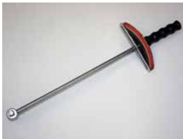
شکل ۱-۷۹ آچار درجه‌دار مکانیکی عقربه‌ای
