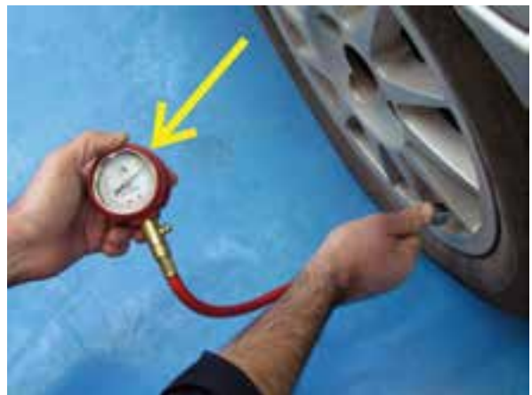
شکل ۲-۱۶۶ اندازه‌گیری فشار باد تایر
