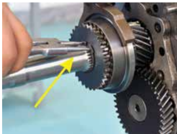
شکل ۱-۱۴۸ کاربرد خار بازکن
