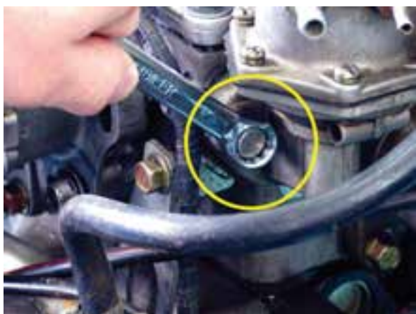
شکل ۱-۲۹ کاربرد آچار رینگ
