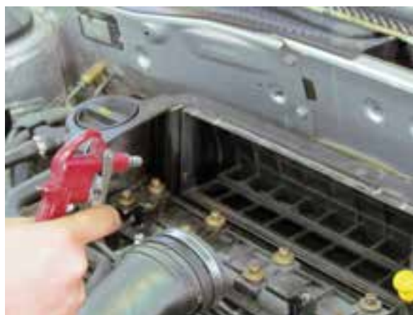
شکل ۲-۱۳ تمیز کردن گردوغبار محل نصب فیلتر هوا
