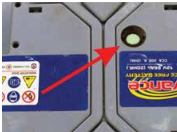
شکل ۲-۹۷ هیدرومتر، یا اسیدسنج باتری
