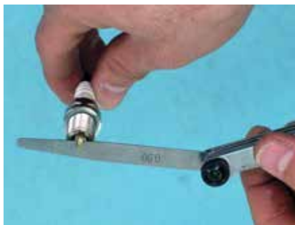
شکل ۲-۹۴ فیلرگیری شمع
