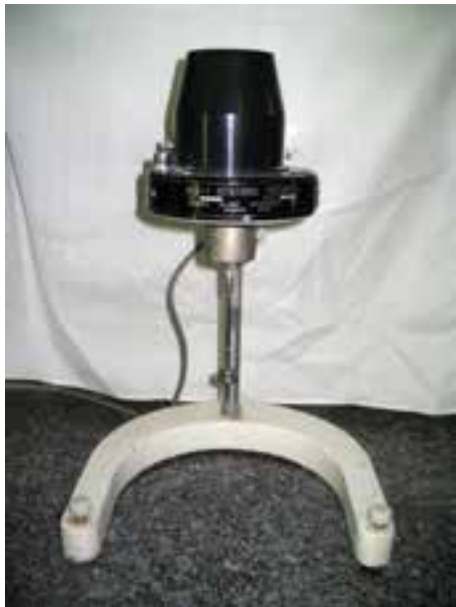
شکل ۲-۴۵- ج: وِسکومتر چرخشی (بروکفیلد) آنالوگ
