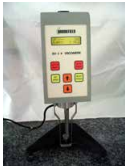
شکل ۲-۴۵- د: وِسکومتر چرخشی (بروکفیلد) دیجیتالی
