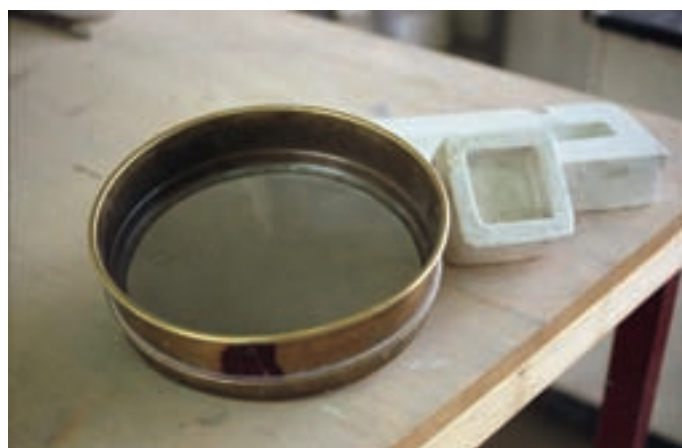
شکل ۳-۸- یک قالب گچی انقباض در جوار یک الک آزمایشگاهی
