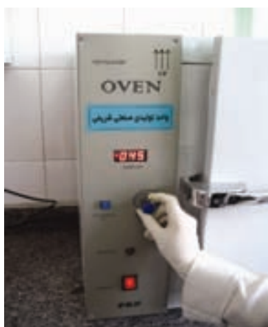
شکل ۲-۱۷- تنظیم خشک کن روی دمای ۴۵ درجه سلسیوس
