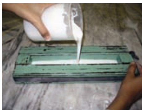
شکل ۲-۱۴- تخلیه دوغاب گچ داخل قالب
