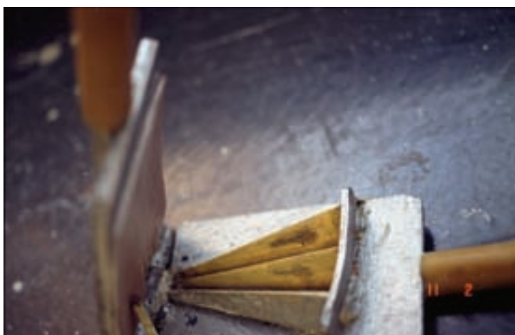
شکل ۳-۲۴- قالب ویژه ساخت مخروط‌های سنجش دمای خمیری [۷]
