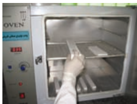
شکل ۲-۱۶- قراردادن نمونه در خشک کن، دمای ۴۵ درجه سلسیوس
