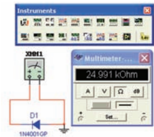
شکل ۱۷-۲ مقاومت دیود در بایاس مخالف
