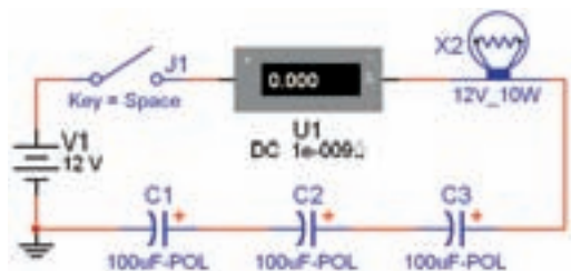
شکل ۸-۵ جریان عبوری از مدار خازن‌های سری
