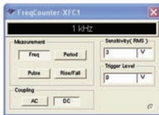
شکل ۶-۶ استفاده از فرکانس متر در اندازه‌گیری فرکانس
