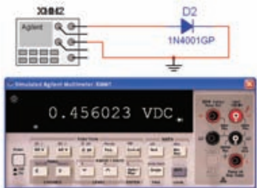
شکل ۲۱-۲ آزمایش دیدود در بایاس موافق
