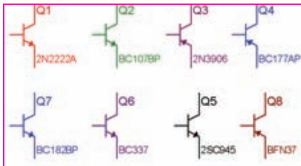
شکل ۴-۶ انواع ترانزیستور با شماره‌ی فنی
