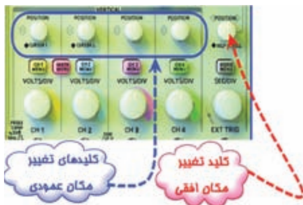
شکل ۲-۹۶ کلیدهای تغییر موقعیت عمودی و افقی
