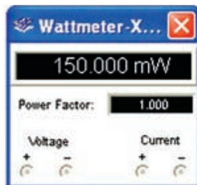
شکل ۴-۸ اندازه‌گیری توان در یکی از شاخه‌های مدار موازی
