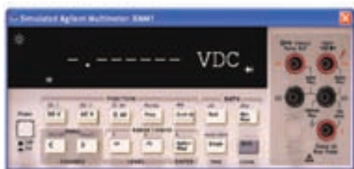
شکل ۲۰-۲ آماده ساختن مولتی‌متر برای آزمایش دیدود
