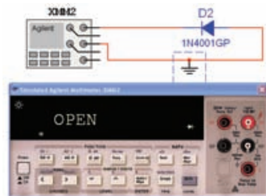
شکل ۲-۲۲ آزمایش دیود در بایاس مخالف
