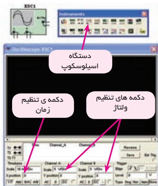
شکل ۱-۲۰ اسیلوسکوپ و دکمه‌های تنظیمات
