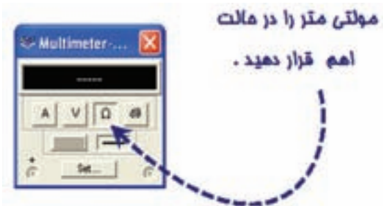
شکل ۲-۶۳ مولتی متر در حالت اهم متر
