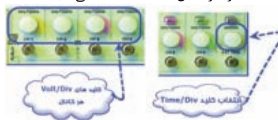
شکل ۲-۹۳ کلیدهای انتخاب Volt/Div و Time/Div
