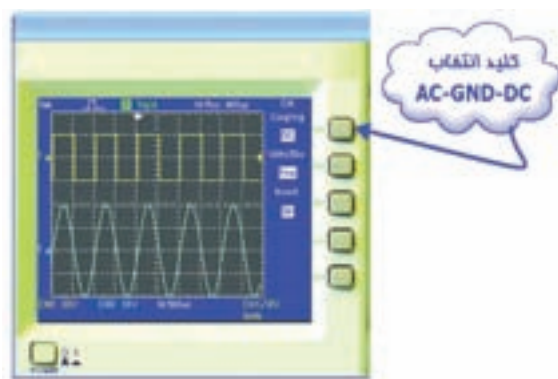
شکل ۲-۹۴ کلید انتخاب ورودی AC-GND-DC
