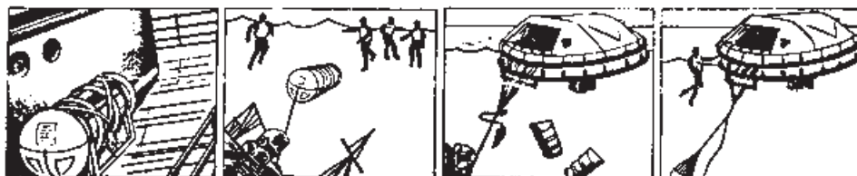
شکل ۱۷-۱- دستگاه آزادکننده هیدرواستاتیکی لایفرافت
