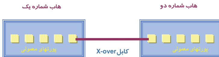
شکل ۱۹-۵ اتصال دو هاب با استفاده از پورت معمولی و یک کابل X-Over
