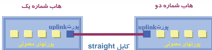
شکل ۱۸-۵ اتصال دو هاب با استفاده از پورت Uplink و یک کابل Straight
