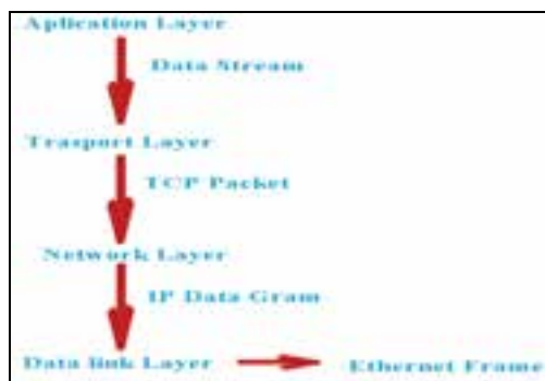
شکل ۴-۳ انتقال داده در لایه‌های مختلف براساس پروتکل TCP/IP
