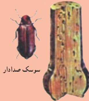
چوب خورده شده به وسیله‌ی سوسک صدا دار
