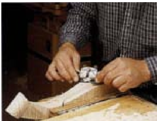
شکل ۲-۳۴. کاربرد رنده بال کبوتری، برای رندیدن قوس‌های داخلی و خارجی یک پایه‌ی سُم آهویی.
