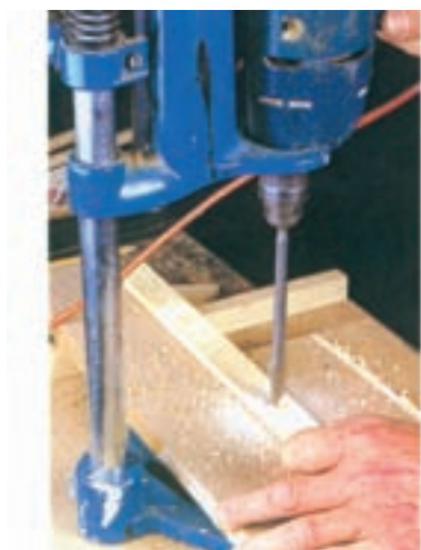
شکل ۱۰-۱۲- سوراغ‌کاری زهوار.
