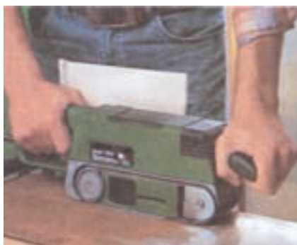
شکل ۷-۴. روش کنترل و کاربرد صمیع دستگاه.
