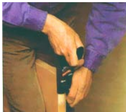
شکل ۲-۲۱- برای رندیدن سر چوب، رنده از خارج به داخل هدایت می‌شود.
