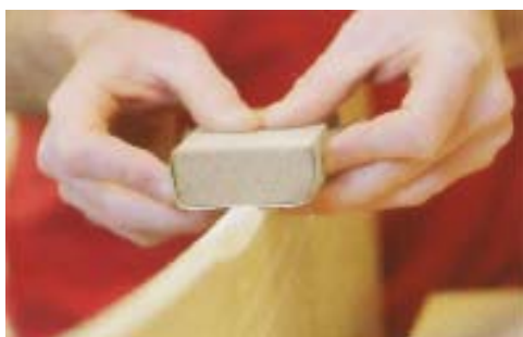
شکل ۳-۲۱. طریقه‌ی سنباده‌کاری نر قطعات با دو دست.
