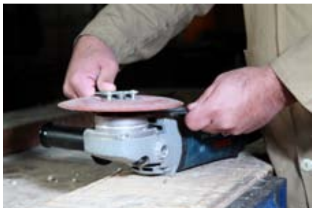
شکل ۷-۲۰- بستن ورق سنباده روی دیسک لاستیکی و ممک کردن آن با مهره‌ی مفصوص.
