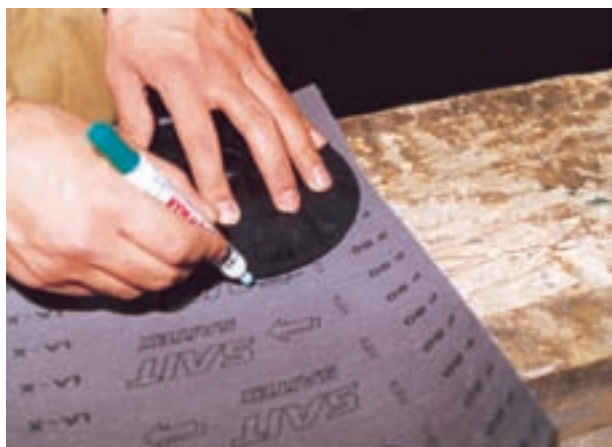
شکل ۷-۳۵- ترسیم گردی دیسک روی سنباده.
