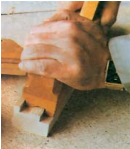
شکل ۷-۱۰-۴ رنده دستی افزار (پروفیلی)، برای تهیه‌ی زهوار تزئینی.
