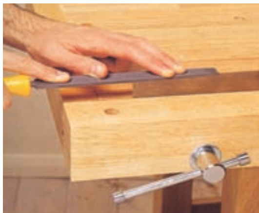
شکل ۲-۷- نمونه‌ی سوهان زدن ضخامت لیسه.
