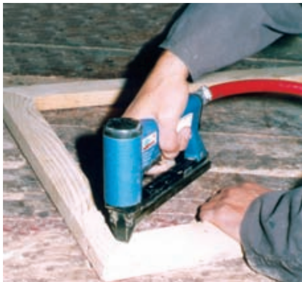
شکل ۸-۱۶- منگنه زدن روی درزهای ۴۵ درجه شده.
