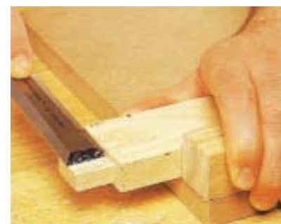
شکل ۹-۹۸- اندازه کردن زبانه با مغار.
