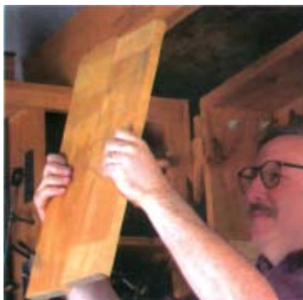
شکل ۱-۳۵- درز تفتقه ها باید طوری باشد، که نور از بین شان عبور نکند.
