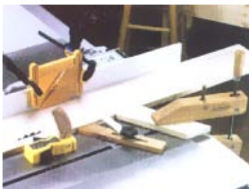
شکل ۱-۲۵- کاربرد گیره‌ی موازی چوبی، برای بستن قطعات به صفحه‌ی ماشین اَره گرد.
