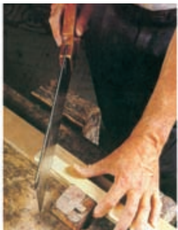
شکل ۱۰-۱۱- برش زهوار، با زاویه‌ی ۴۵ درجه.
