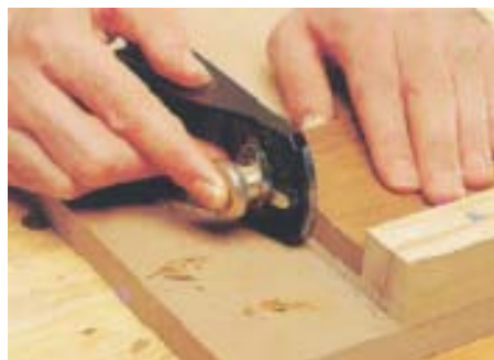
شکل ۲-۲۲- نحوه‌ی رندیدن نر تخته خرده چوب، با استفاده از چوب کمکی.
