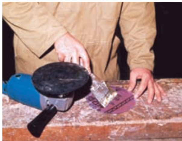
شکل ۷-۳۶- چسب به طور یکنواخت و به صورت یک لایه نازک روی سنبله گرد دستگاه پهن شود.
