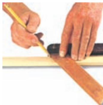
شکل ۱۰-۱۰- فلکشی زهوار، با زاویه‌ی ۴۵ درجه.
