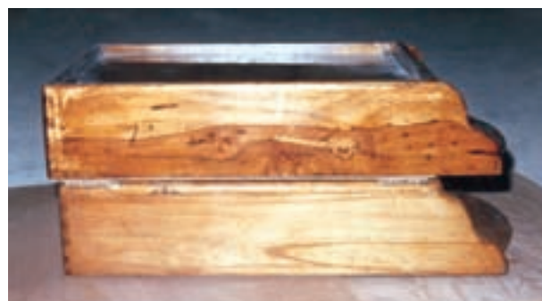
شکل ۴۰-۴- بین قطعات رنگ شده، مقوا یا پلاستیک قرار دهید.
