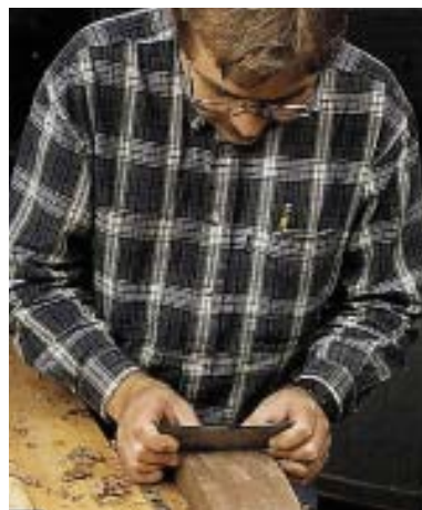
شکل ۲-۳۰. پرداخت سطوح قوس دار به وسیله لیسه.
