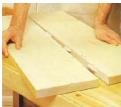
شکل ۹-۹۴- صفحه‌ی (ویه، با اتصال بیسکوییتی.
