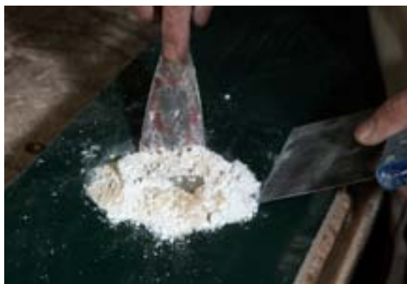
شکل ۴-۱۴- چگونگی کار کردن با کاردک و لیسه.
