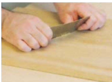
شکل ۲-۱۳. جهت حرکت لیسه، هنگام پُرزگیری.
