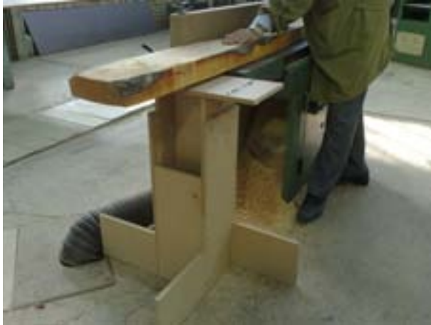
شکل ۹-۱۴- کاربرد میز کمکی برای ماشین کفرند.
