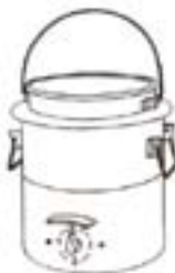
شکل ۱-۳. ظرف سريشم الكتريكي با جاي آب از ورق مس.
