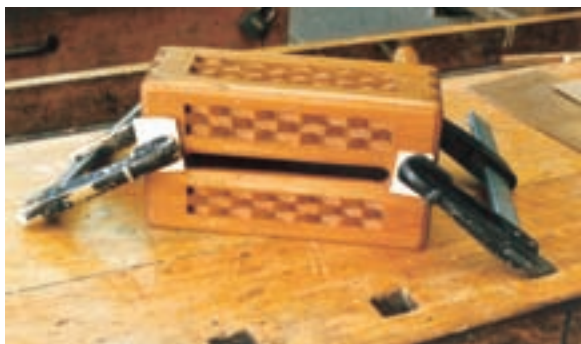
شکل ۹-۷۰- بستن سقف به بدنه‌ها.
