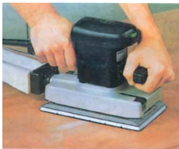
شکل ۳-۱۴- سنباده‌زنی با یک دستگاه سنباده لرزان کامل.
