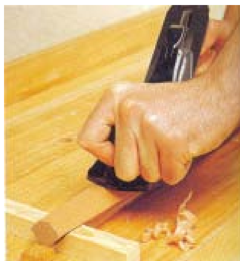
شکل ۲۷-۲. نمونه ی پرداخت قید شش ضلعی با رنده پرداخت.
