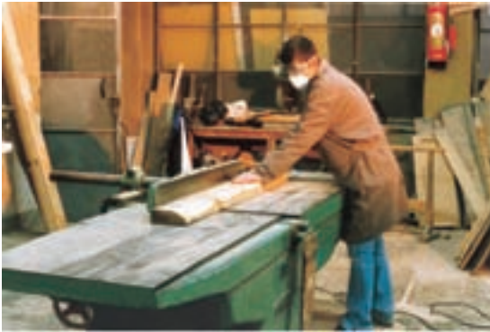
شکل ۹-۹- مقدار باز بودن زیاد گونیا، فطرآفرین است.
