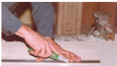
شکل ۵-۲۹- برش (روکش با کاتر)
