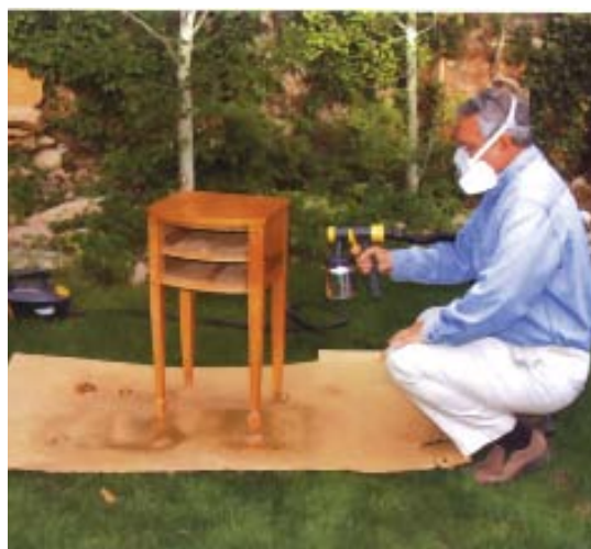
شکل ۲۳-۴. رنگ‌کاری با پیستوله (رنگ پوششی).
