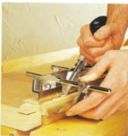
شکل ۹-۱۰۰- شیار انداختن دافل قیدهای عرضی.
