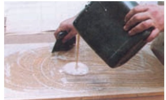
شکل ۶-۴. پخش کردن چسب به وسیله‌ی شانه‌ی چسب‌زنی.
