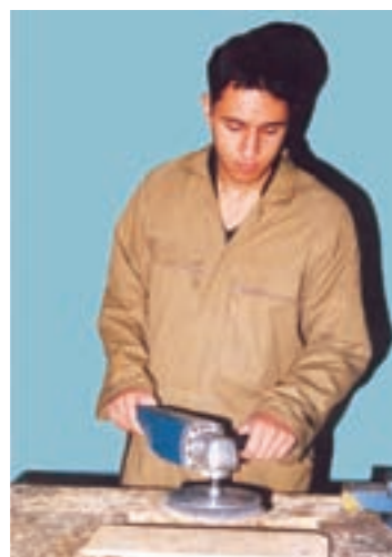
شکل ۷-۴۰- هدایت و کنترل صمیع دستگاه سنباده.
