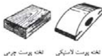
شکل ۷-۱. تخته پوست چوبی و شیوه‌ی صمیع کار با آن.
