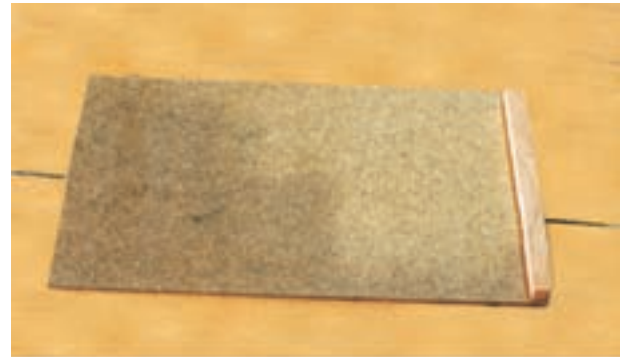
شکل ۹-۶۲. پسباندن (هوار به لبه‌ی کف جعبه).
