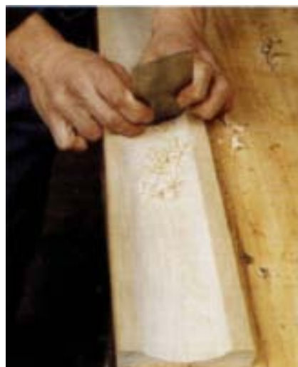
شکل ۲-۵- کاربرد لیسه با لبه‌ی نیم گرد.
