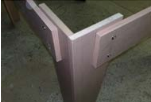
شکل ۱۲۱۶ اتصال پایه به قید توسط پیچ فیکس.
