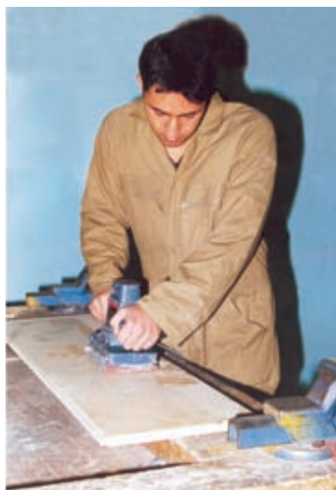
شکل ۷-۱۰ - پیچونگی کنترل دستگاه سنباده لرزان.
