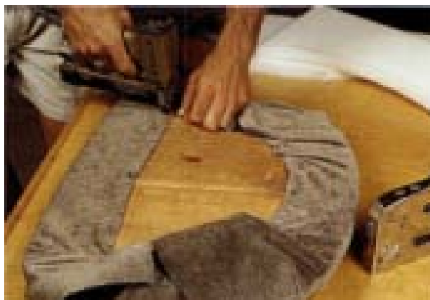
شکل ۸-۵- کاربرد منگنه در رویه‌کوبی.
