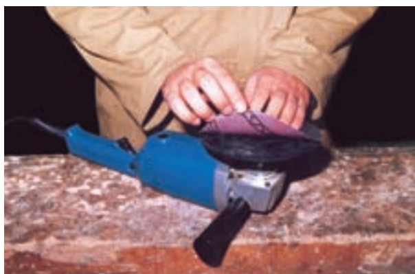
شکل ۷-۳۷- ورق سنبله به دقت روی دیسک قرار گیرد.
