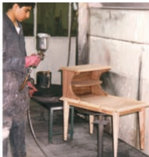
شکل ۲۴-۴. رنگ‌کاری با پیستوله (رنگ شفاف).
