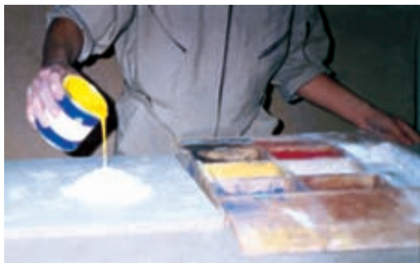
شکل ۴-۳- مواد تشکیل دهنده‌ی بتونه (روغنی).
