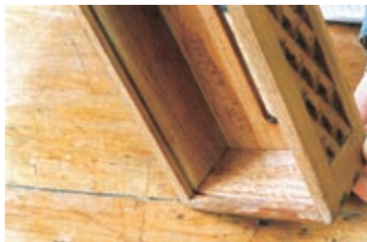
شکل ۹-۶۷- کنشکاف داخل بدنه‌های یک جعبه دستمال کاغذی.
