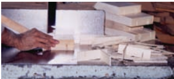
شکل ۱۱-۳۱- تولید شبکه‌های داخل در.
