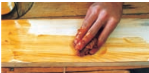
شکل ۴-۲۸. (رنگ‌های زیر کار) با کهنه دست زده می‌شود.
