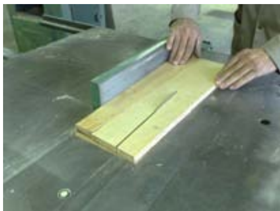
شکل ۱۲-۱۳- برش پایه ها با اره گرد مفصص MDF.
