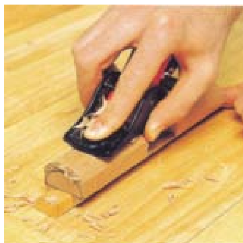
شکل ۲۶-۲. نمونه ی پرداخت قطعه ای با مقطع نیم گرد.
