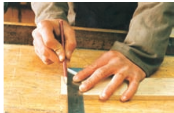
شکل ۹-۶۳. فم کشی ممل اتصال با گونیا.
