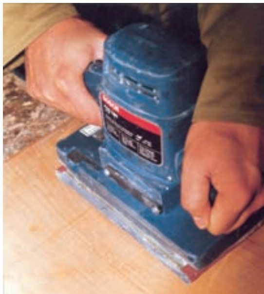
شکل ۷-۱۱ - سنباده کاری در جهت الیاف.
