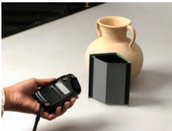
تصویر ۹-۷- نورسنجی بازتابی از کارت خاکستری
