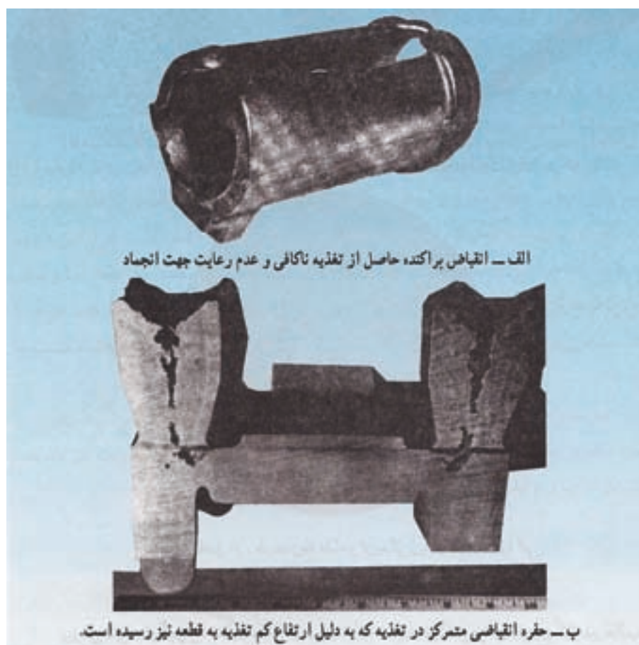
شکل ۲-۱۸- کشیدگی و حفره‌های انقباضی
