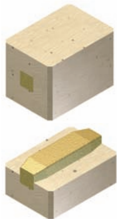
شکل ۱۷-۸ - قالبگیری ماهیچه (نیمی از ماهیچه)
