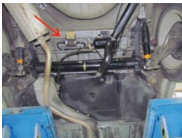
شکل ۲-۶۵ محل نصب فیلتر بنزین
