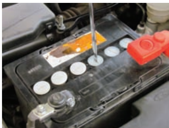
شکل ۲-۱۱۱ بستن درپوش خانه‌های باتری
