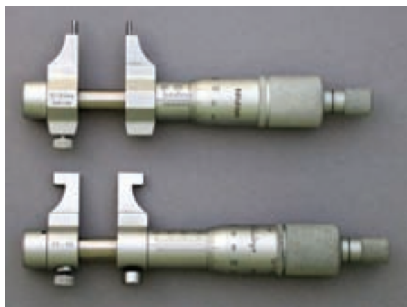
شکل ۱-۲۴۶ دو نوع میکرومتر اندازه گیر شکاف دهانه
