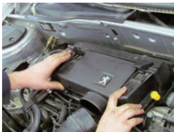
شکل ۲-۱۵ سوار کردن قاب محفظه فیلتر هوا
