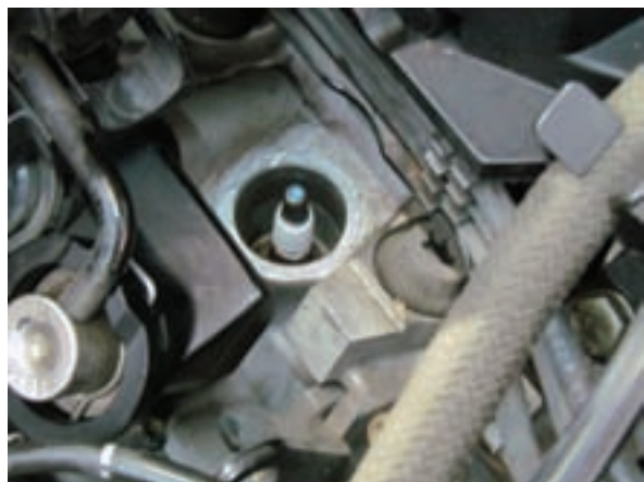
شکل ۲-۸۷ شمع موتور
