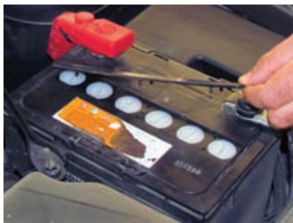
شکل ۲-۱۰۶ خارج کردن صفحه بالای درپوش‌ها
