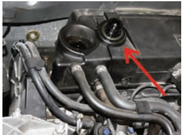
شکل ۲-۴۵ بازکردن در محفظه روغن
