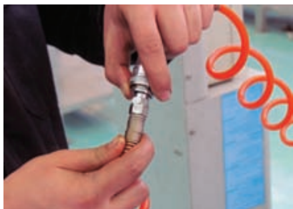
شکل ۲-۳۰ اتصال رابط شیلنگ هوای فشرده
