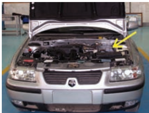
شکل ۲-۹۶ محل باتری در خودرو
