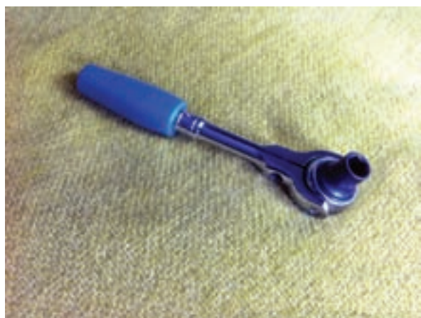
شکل ۱۶۰ آچار بوکس دسته جفجغه ای
