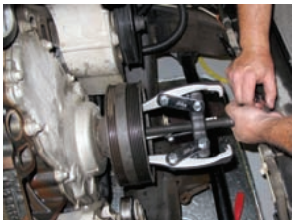
شکل ۱-۱۹۵ کاربرد پولی کش سه شاخه
