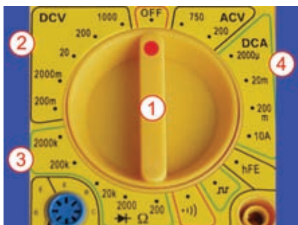
شکل ۱-۲۶۸ حوزه های کاری مولتی متر ۱. سلکتور یا کلید انتخاب حوزه کاری ۲. حوزه کاری اندازه گیری ولتاژ جریان مستقیم ۳. حوزه کاری اندازه گیری مقاومت جریان DC ۴. حوزه کاری اندازه گیری شدت جریان DC
