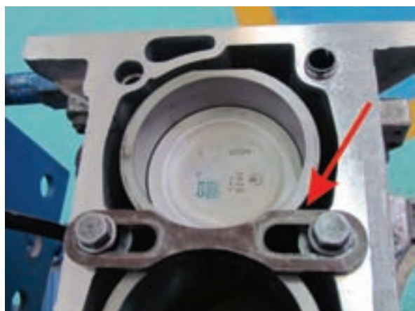
شکل ۱-۲۷۲ کاربرد پوش بند برای ثابت نگه داشتن پوش ها درون بلوکه سیلندر
