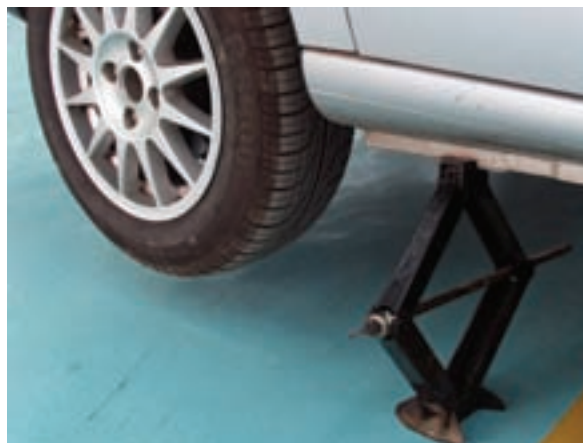
شکل ۱-۲۰۸ یک نوع جک مکانیکی (خاص خودرو)
