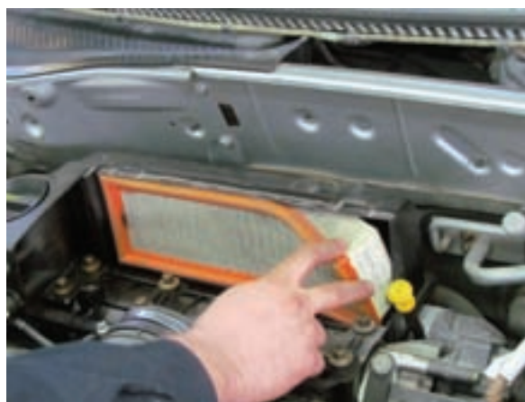
شکل ۲-۱۱ خارج کردن فیلتر هوا
