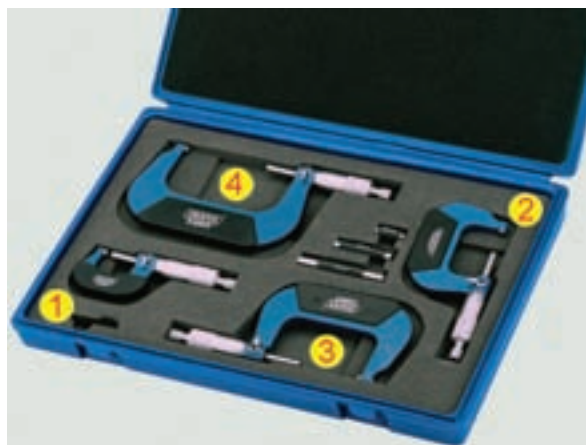
شکل 1-234 میکرومتر نوع میلی متری. ۱. اندازه گیر صفر تا 25 ۲. اندازه گیر 25 تا 50 . ۳. اندازه گیر 50 تا 75 . ۴. اندازه گیر 75 تا 100 .
