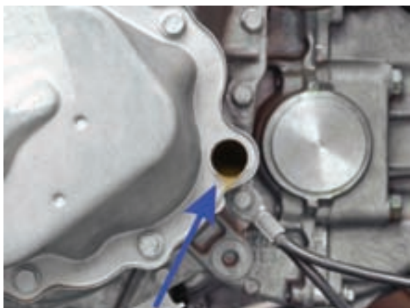
شکل ۲-۶۰ سرریز روغن از دریچه بازديد
