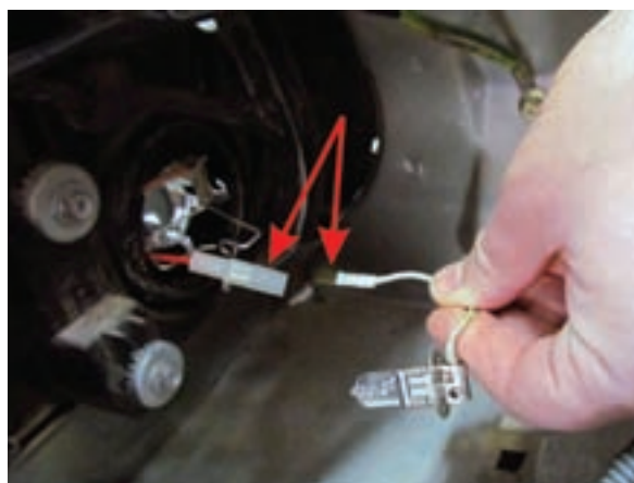
شکل ۲-۱۲۴ جدا کردن اتصال الکتریکی لامپ
