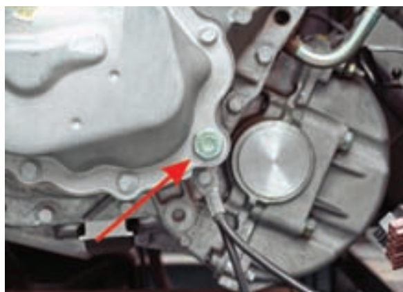
شکل ۲-۵۵ پیچ سرریز روی جعبه‌دنده
