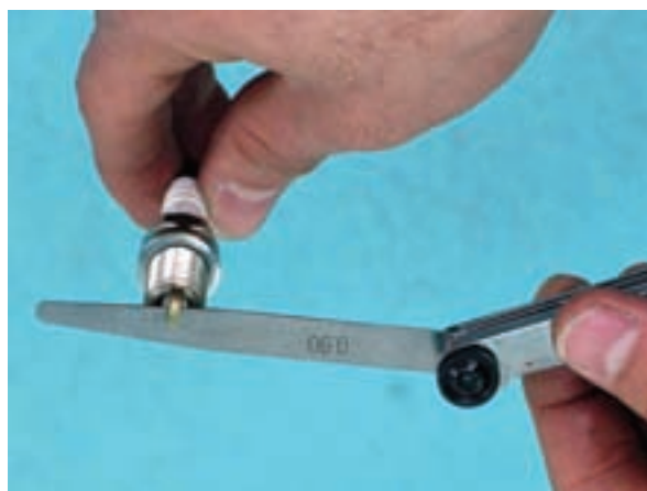
شکل ۲-۹۴ فیلرگیری شمع
