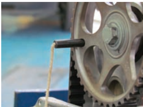
شکل ۱-۲۷۴ کاربرد پین تنظیم تایم میل بادامک
