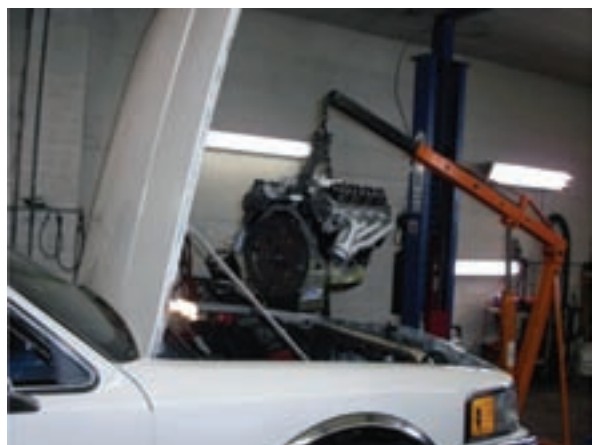
شکل ۱-۲۰۷ جک هیدرولیکی چرخدار بالابر
