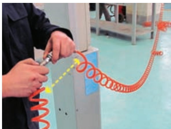
شکل ۲-۴۰ قطع اتصال شیلنگ هوای فشرده
