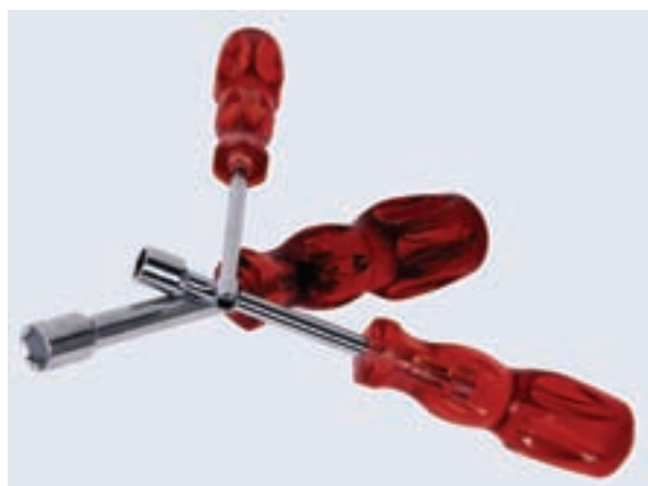
شکل ۱-۶۴ پیچ گشتی بوکس
