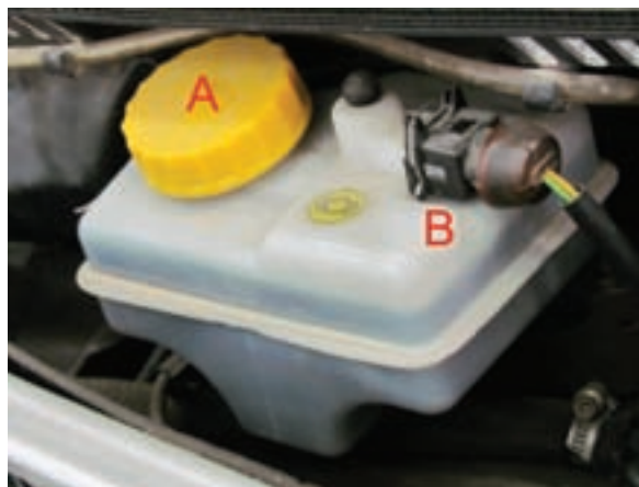
شکل ۲-۷۷ مخزن مایع ترمز. A در مخزن. B حسگر تشخیص سطح مایع ترمز.
