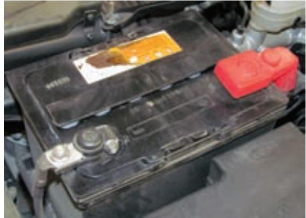
شکل ۲-۱۱۲ قراردادن صفحه روی درپوش‌ها در محل خود
