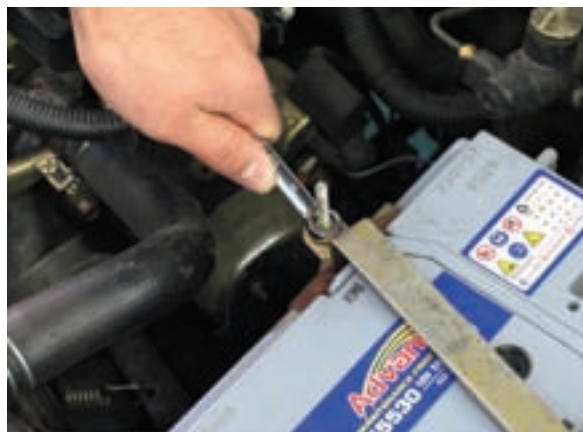
شکل ۲-۱۰۰ بازکردن بست نگهدارنده باتری
