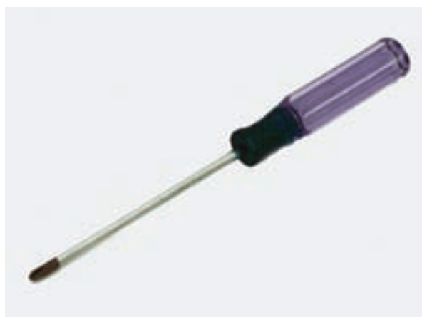
شکل ۱۰۰-۱ آچار پیچ گشتی مخصوص پیچ های شیاردار سه گوش
