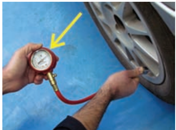
شکل ۲-۱۶۶ اندازه‌گیری فشار باد تایر
