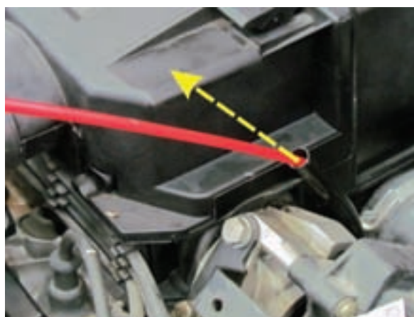
شکل ۲-۳۹ خارج کردن لوله رابط
