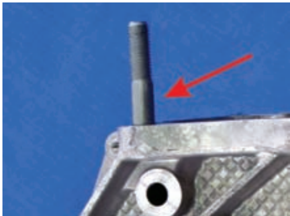
شکل ۱-۱۱۷ (ب) پیچ دوسر دنده
