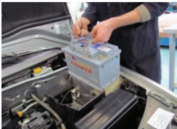
شکل ۲-۱۰۱ خارج کردن باتری از خودرو
