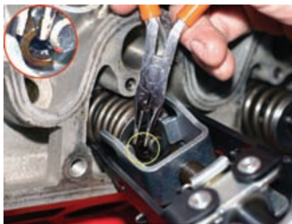
شکل ۱-۱۸۶ خارج کردن خار آزاد شده فنر سوپاپ
