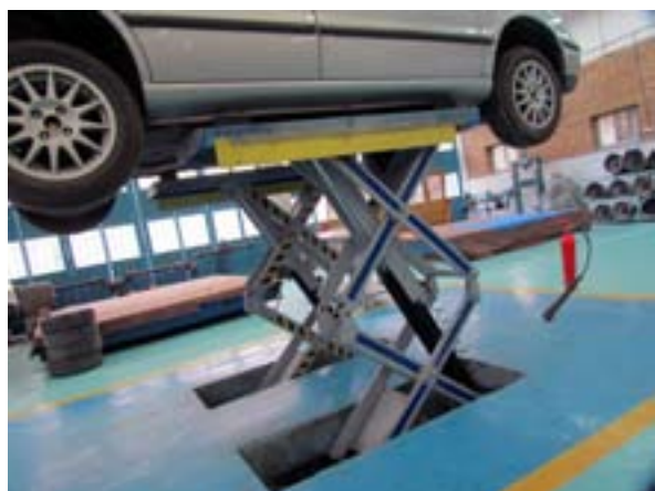
شکل ۲-۶۴ بالا بردن خودرو به وسیله جک بالابر
