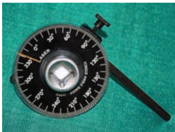
شکل ۱-۸۱ آچار تورک‌متر زاویه‌ای
