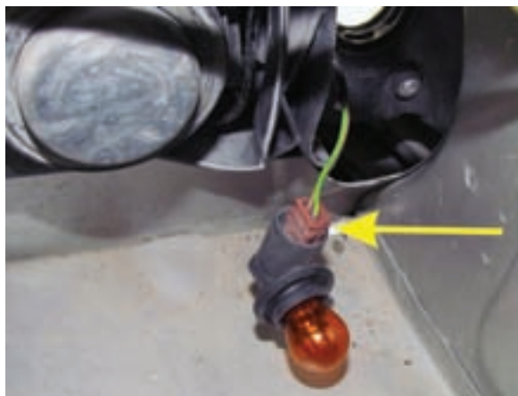
شکل ۲-۱۳۶ جداکردن کانکتور یا اتصال الکتریکی
