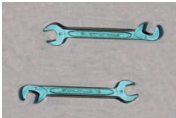
شکل ۱-۷ آچار دوسر تخت با انحراف دهانه ۶۰ درجه
