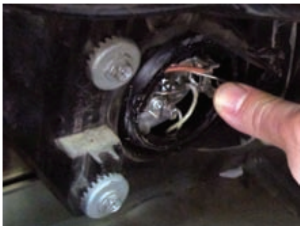
شکل ۲-۱۲۱ آزادکردن میله فنری
