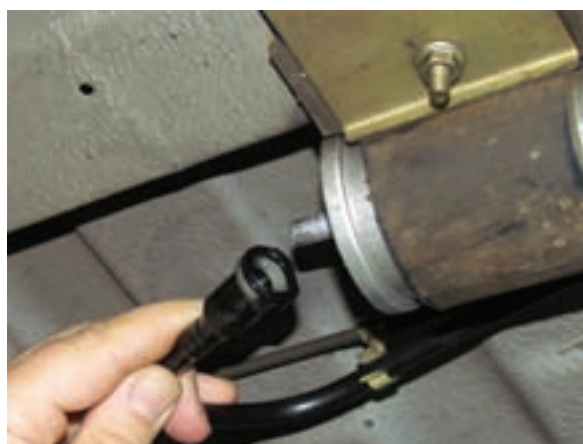
شکل ۲-۶۹ جدا کردن شیلنگ خروجی از فیلتر
