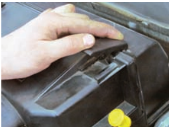
شکل ۲-۱۸ بستن نگهدارنده قاب
