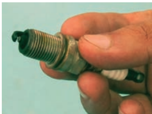
شکل ۲-۹۱ بررسی شمع
