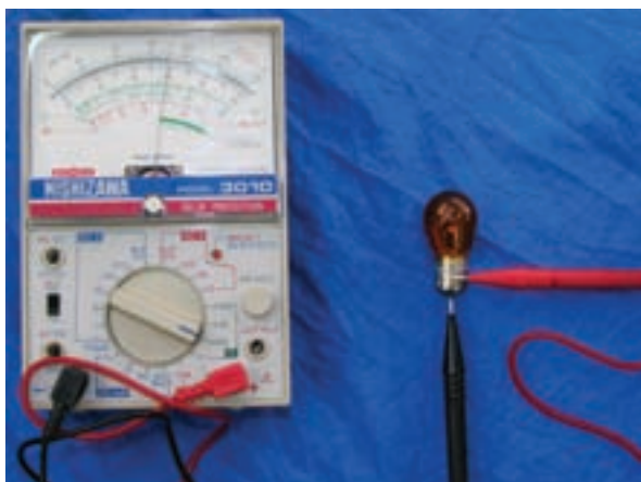
شکل ۲-۱۳۹ آزمایش لامپ
