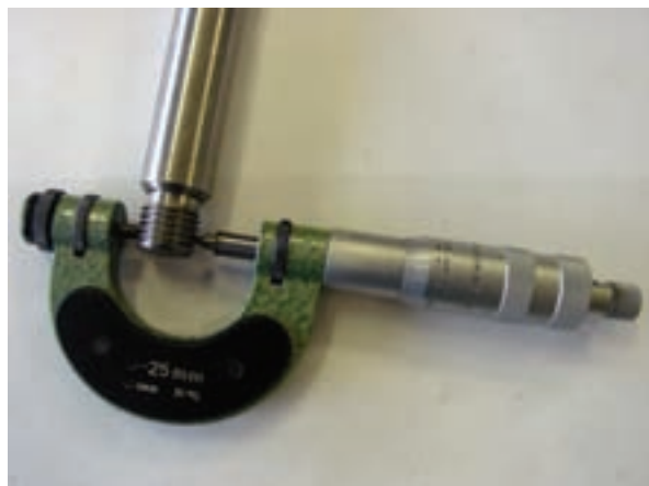
شکل ۱-۲۴۱ اندازه‌گیری شیار رزوه و پیچ
