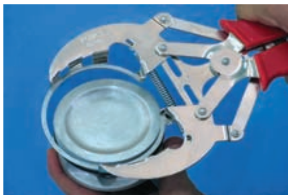
شکل ۱-۱۸۱ طرز کار رینگ بازکن
