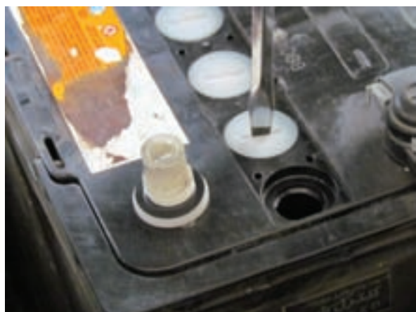
شکل ۲-۱۰۷ بازکردن درپوش خانه‌های باتری
