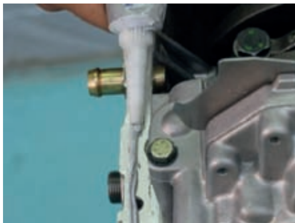
شکل ۳-۳۰۹ چسب زدن محل نصب واشر کارتر
