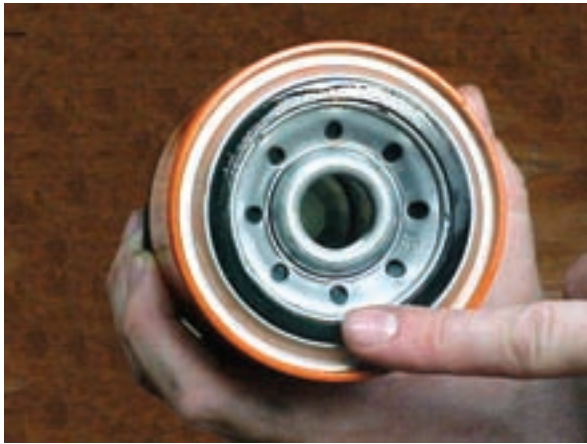
شکل ۲-۴۴ روغن زدن اورینگ فیلتر روغن
