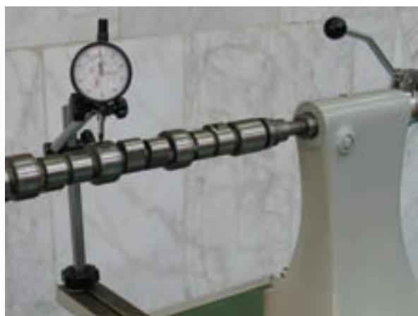
شکل ۱-۲۵۵ نحوه اندازه گیری دو پهن میل بادامک
