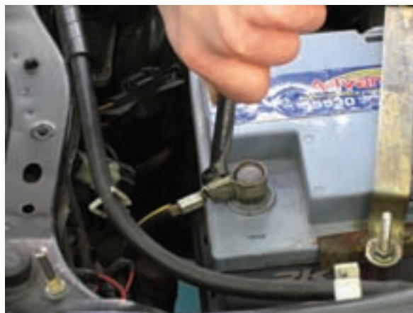
شکل ۲-۹۸ بازکردن بست اتصال ترمینال منفی باتری
