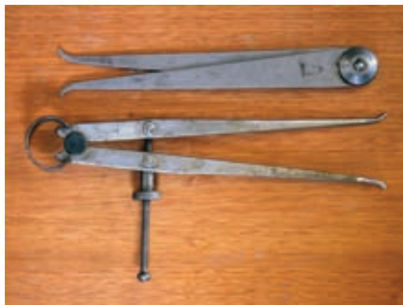
شکل ۱-۲۶۱ دو نوع اندازه‌گیر پرگاری
