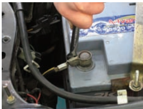
شکل ۲-۶۳ باز کردن بست کامل منفی باتری
