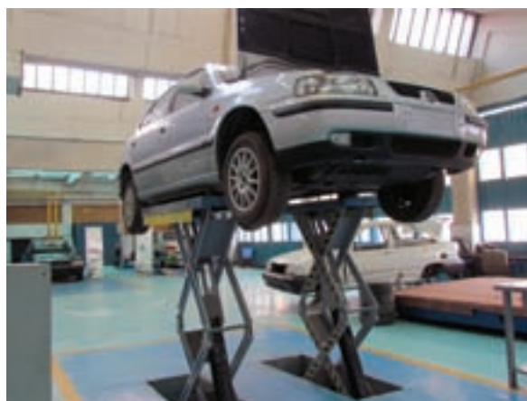
شکل ۲-۴۹ بالا بردن خودرو با جک قیچی
