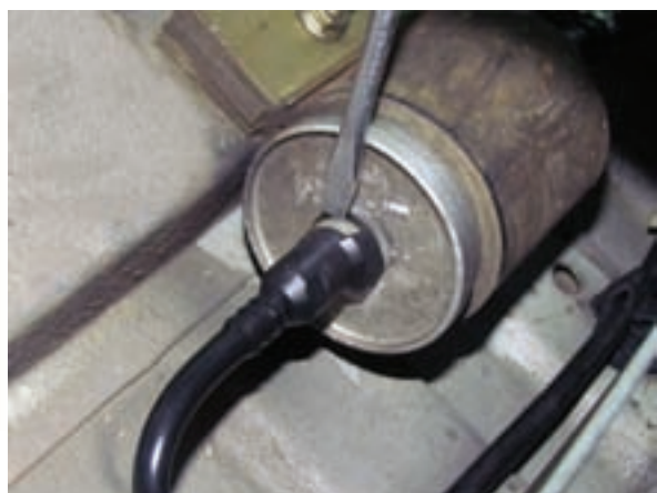
شکل ۲-۶۸ آزاد کردن ضامن شیلنگ خروجی
