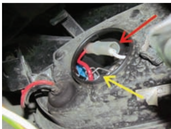
شکل ۲-۱۴۵ اتصال الکتریکی و میله فنی نگهدارنده لامپ
