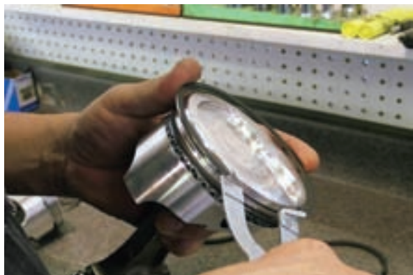
شکل ۱-۱۸۳ کاربرد رینگ بازکن
