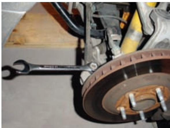
شکل ۱-۳۸ کاربرد آچار ترکیبی یکسر رینگی - یکسر تخت
