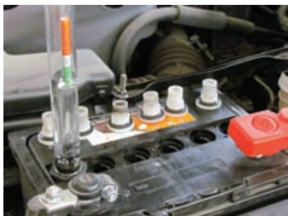
شکل ۲-۱۰۹ اندازه‌گیری چگالی الکترولیت
