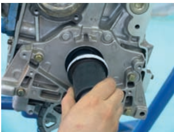
شکل ۳-۳۱۱ چسب زدن کاسه‌نمد سر میل‌لنگ
