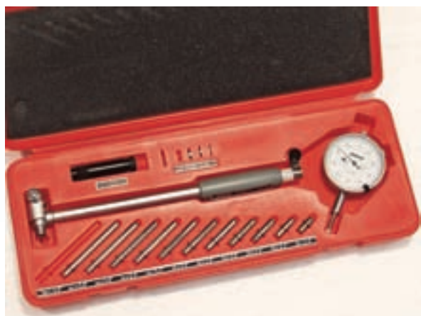
شکل ۱-۲۵۳ ساعت اندازه گیر نوع اینچی
