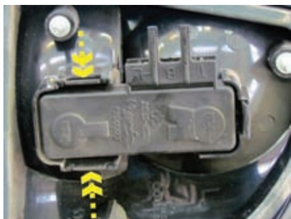
شکل ۲-۱۵۱ خارج کردن پایه لامپ‌ها
