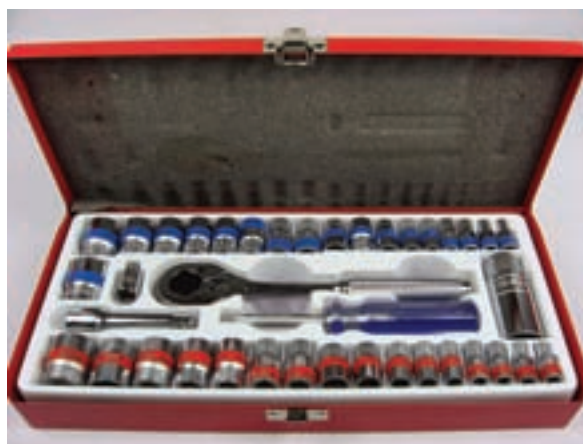
شکل ۱-۷۳ جعبه بوکس ۳۹ پارچه میلی متری و اینچی
