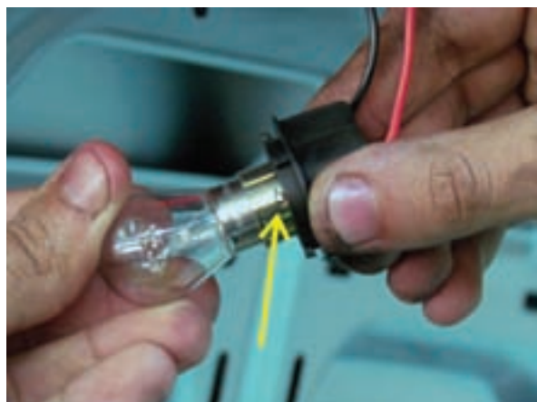
شکل ۲-۱۶۱ نحوه قرار گرفتن لامپ در داخل پایه
