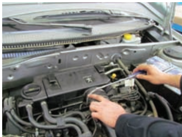
شکل ۲-۲۱ بستن پیچ بست لوله مکندۀ هوا
