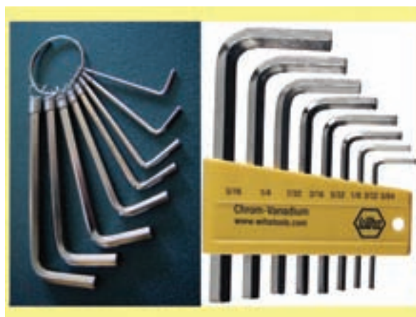
شکل ۱۸۵ یک سری ۸ تایی آچار آلن نوع میلی‌متری و نوع اینچی
