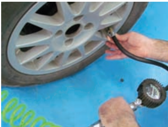
شکل ۲-۱۶۷ افزودن هوای فشرده به تایر
