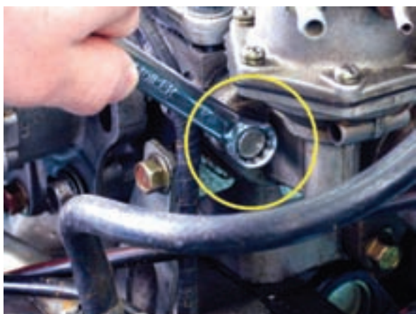
شکل ۱-۲۹ کاربرد آچار رینگ
