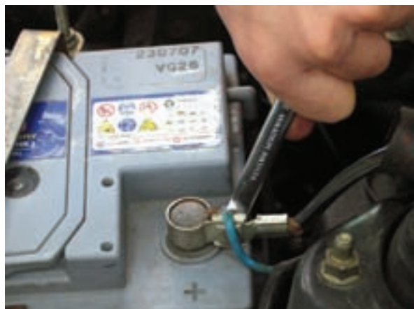
شکل ۲-۹۹ بازکردن بست اتصال ترمینال مثبت
