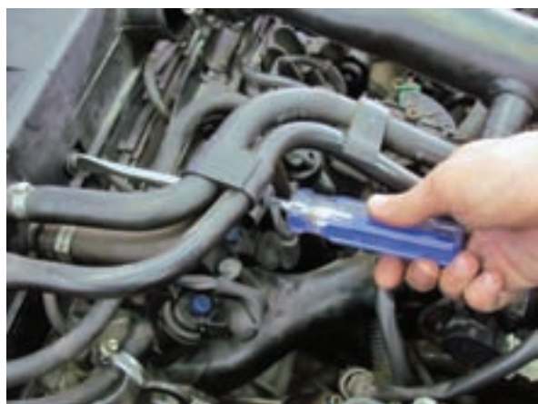
شکل ۲-۱۶ بستن پیچ قاب
