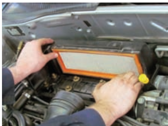
شکل ۲-۱۴ نصب فیلتر هوای نو
