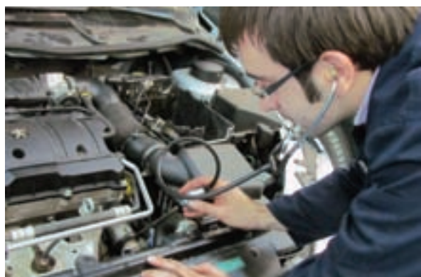
شکل ۱-۲۲۳ کاربرد گوشی تقویت صدا برای عیب‌یابی قطعه
