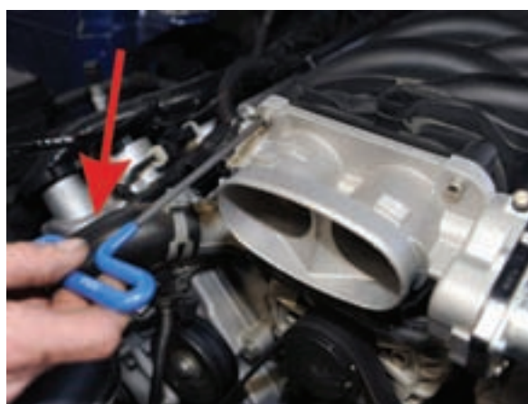
شکل ۱۸۷ کاربرد آچار آلن دسته‌دار
