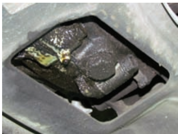
شکل ۲-۵۲ آثار نشتی روغن
