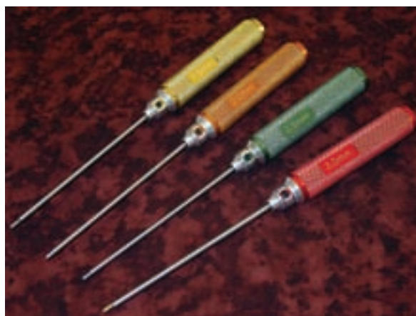
شکل ۱۰۱-۱ پیچ گشتی های چهارگوش اندازه ۳/۵-۲/۵-۱/۵ میلی متری
