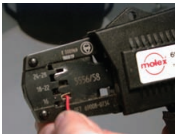
شکل ۱-۱۵۴ انبر پرچ کن سر سیم
