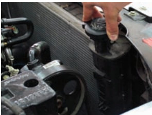
شکل ۲-۸۵ بستن درب رادیاتور (منبع انبساط)
