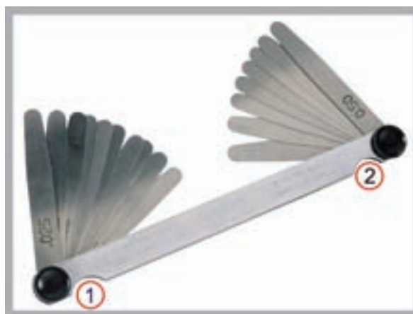
شکل ۱-۱۶۸ فیلر میلی‌متری - اینچی، ۱. فیلر اینچی، ۲. فیلر میلی‌متری
