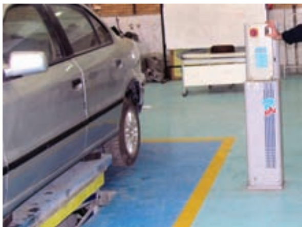
شکل ۲-۶۲ پایین آوردن جک بالابر
