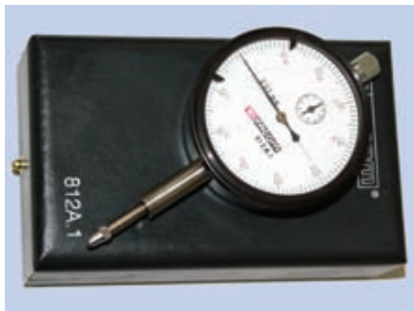
شکل ۱-۲۴۹ ساعت اندازه گیر نوع میلی متری
