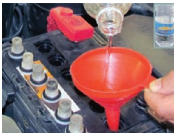
شکل ۲-۱۱۰ جبران کاهش سطح الکترولیت با آب مقطر
