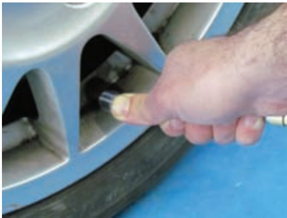
شکل ۲-۱۶۵ اتصال فشارسنج به تایر
