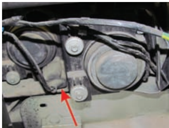
شکل ۲-۱۳۰ گردگیر روی کانکتور چراغ پارک
