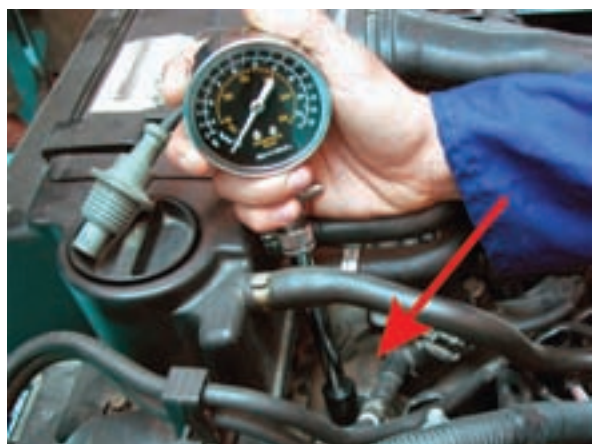
شکل ۱-۲۱۷ کاربرد کمپرس سنج
