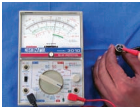
شکل ۱۵۶-۲ آزمایش لامپ چراغ ترمز
