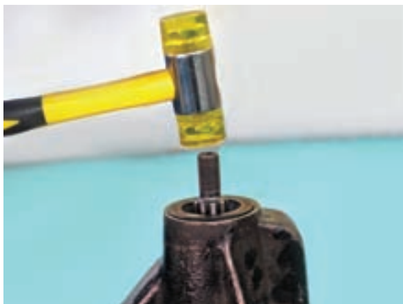
شکل ۱-۱۶۲ کاربرد چکش پلاستیکی
