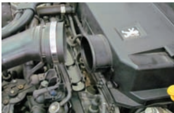
شکل ۲-۶ جدا کردن لوله مکندۀ هوا
