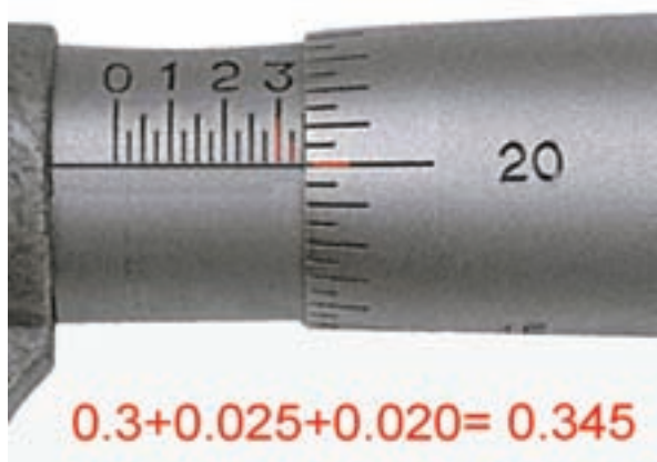
شکل ۱-۲۳۹ نحوه خواندن میکرومتر
