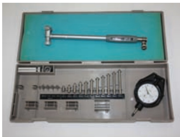
شکل ۱-۲۵۲ ساعت اندازه گیر نوع میلی متری
