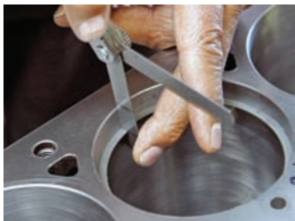
شکل ۱-۱۶۹ کاربرد فیلر برای اندازه‌گیری دهانه رینگ
