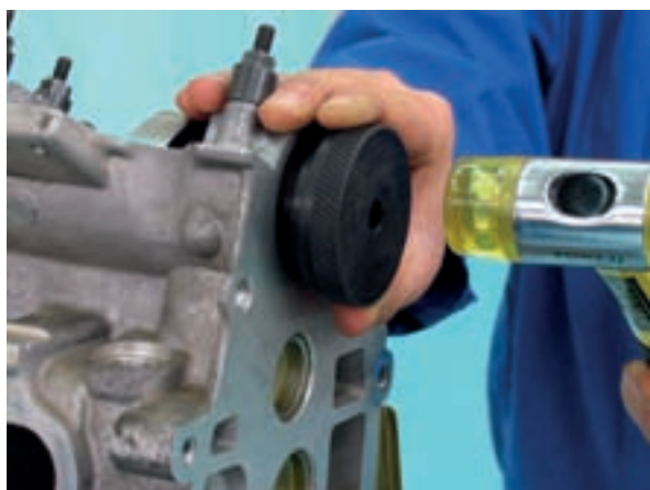
شکل ۳-۳۱۶ نصب کاسه‌نمد میل‌بادامک با ابزار مخصوص
