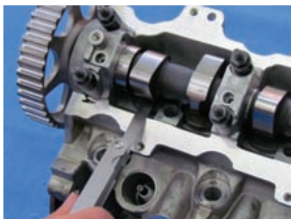
شکل ۱-۱۷۱ فیلرگیری سوپاپ
