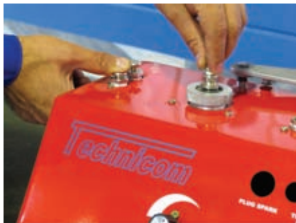
شکل ۲-۹۲ پاک کردن و تمیز کردن شمع با دستگاه
