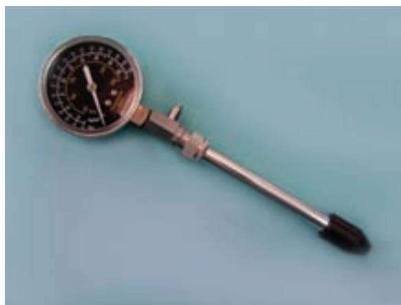
شکل ۱-۲۱۶ یک نوع کمپرس سنج
