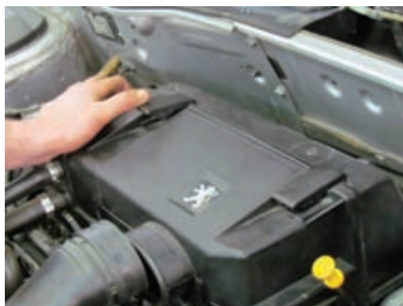
شکل ۲-۱۹ بستن نگهدارنده قاب
