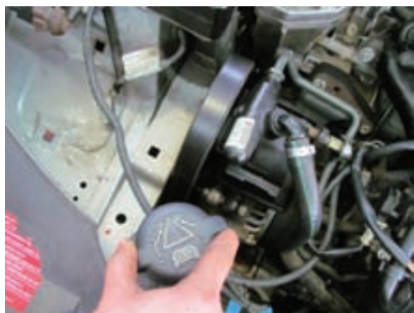
شکل ۲-۸۲ بازکردن درب منبع انبساط رادیاتور
