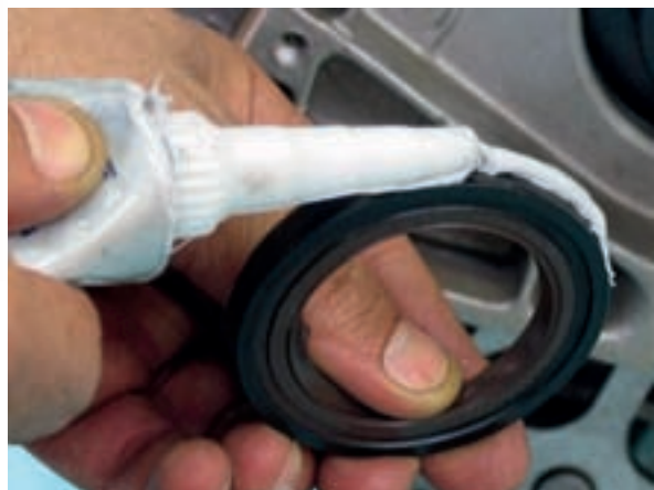
شکل ۳-۳۱۰ چسب زدن کاسه‌نمد سر میل‌لنگ
