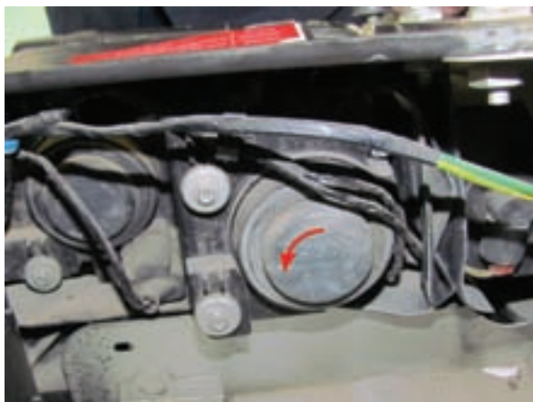
شکل ۲-۱۱۸ بازکردن قاب چراغ
