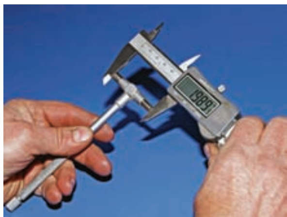
شکل ۱-۲۶۰ خواندن فاصله فک‌های اندازه‌گیر تلسکوپی
