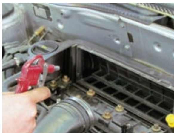
شکل ۲-۱۳ تمیز کردن گردوغبار محل نصب فیلتر هوا
