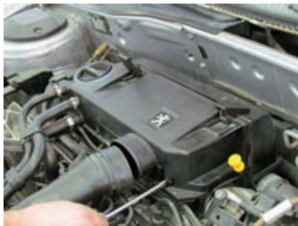
شکل ۲-۱۷ بستن پیچ قاب
