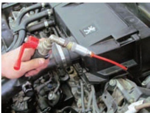
شکل ۲-۳۴ قراردادن لوله رابط در محل گیج روغن
