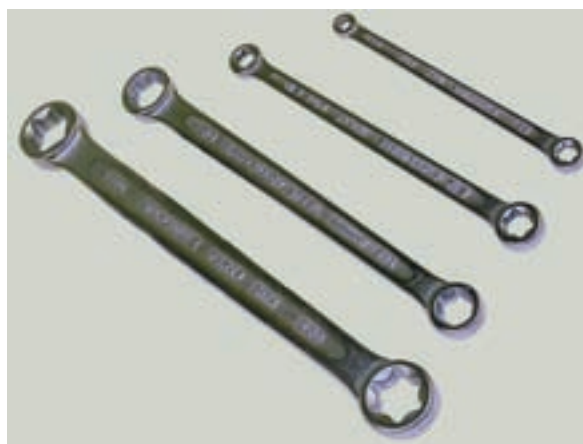
شکل ۱-۲۲ آچار دو سر رینگ شش شیاره تخت
