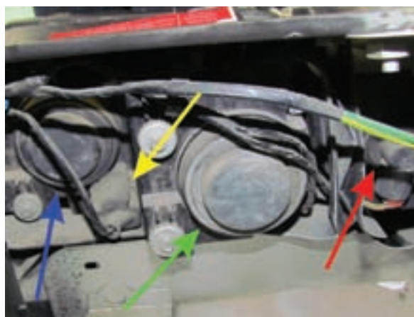
شکل ۲-۱۱۶ چراغ‌های داخل مجموعه چراغ‌های جلو خودرو
