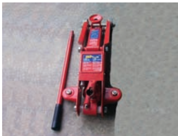
شکل ۱-۲۰۶ جک سوسماری در اندازه کوچک
