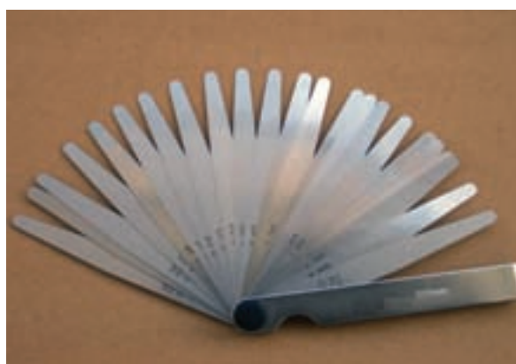
شکل ۱-۱۶۶ فیلر میلی‌متری ۲۰ تیغه
