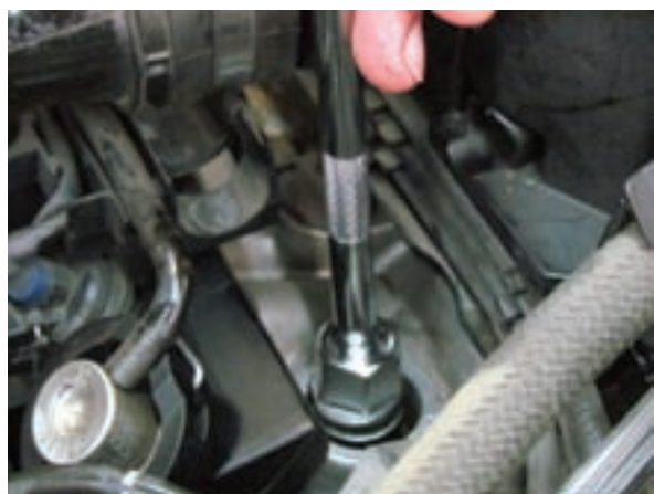
شکل ۲-۸۹ باز کردن شمع
