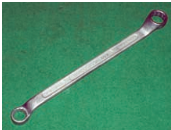
شکل ۱-۱۸ آچار رینگی سر کج برای مواضع کم‌عمق
