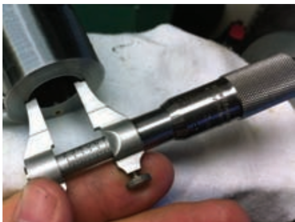
شکل ۱-۲۴۷ کاربرد میکرومتر اندازه گیر دهانه داخلی
