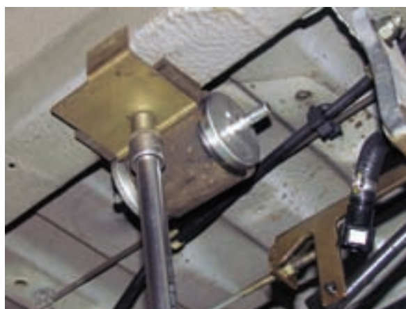
شکل ۲-۷۱ باز کردن پیچ نگهدارنده فیلتر بنزین
