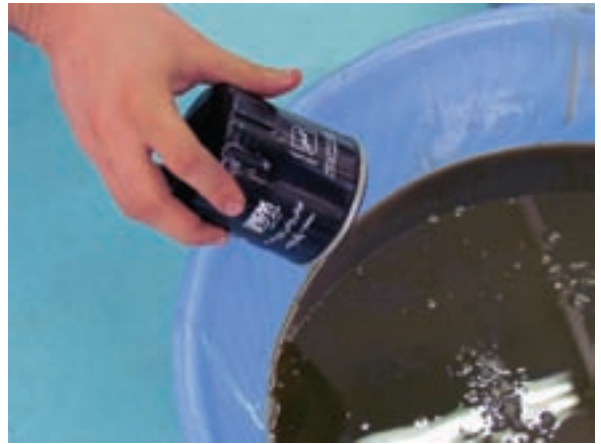
شکل ۲-۴۳ تخلیه روغن داخل فیلتر روغن
