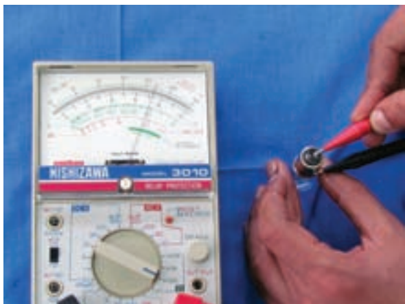
شکل ۱۵۵-۲ آزمایش لامپ چراغ خطر
