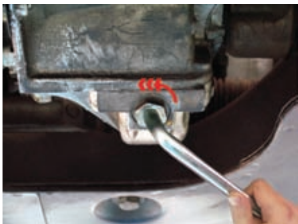
شکل ۲-۵۸ بازکردن پیچ تخلیه جعبه‌دنده
