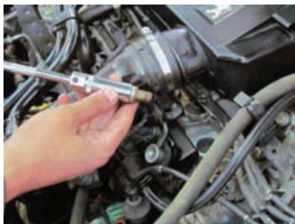
شکل ۲-۹۰ خارج کردن شمع از محل خود
