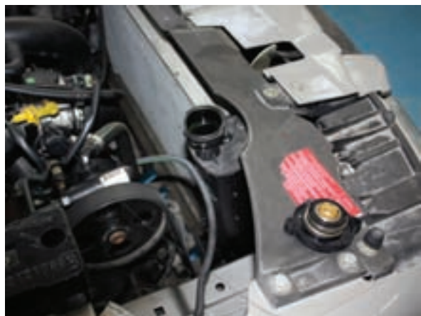
شکل ۲-۸۳ بازدید و بررسی سطح مایع خنک‌کننده
