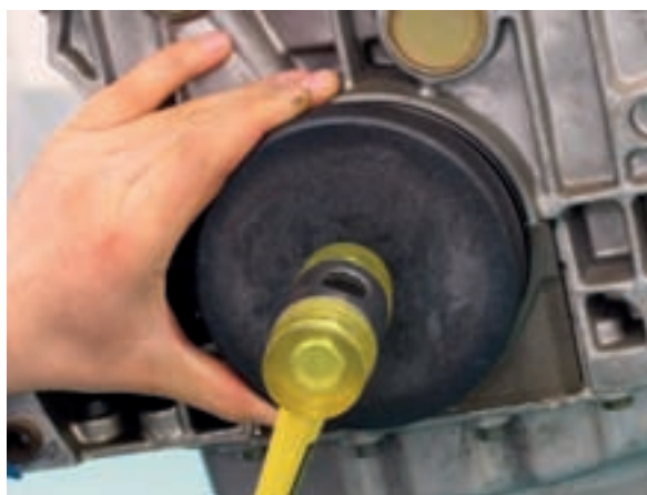
شکل ۳-۳۱۵ نصب کاسه‌نمد به‌وسیله ابزار مخصوص
