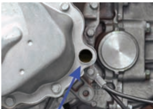
شکل ۲-۵۶ دریچه بازديد روغن جعبه‌دنده
