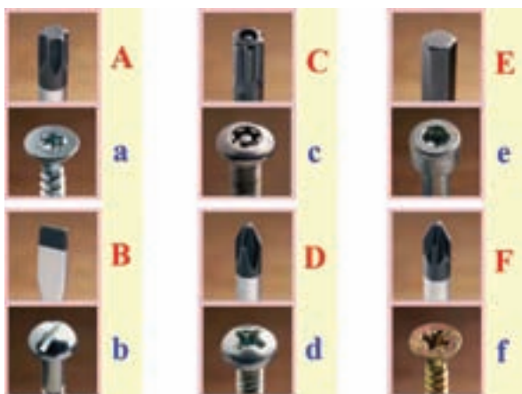
شکل ۱-۹۶ فرم آچار پیچ‌گشتی، (A-F) فرم آچارخور پیچ (a-f)
