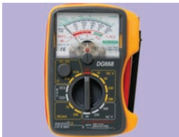
شکل ۱-۲۶۳ یک نوع مولتی متر عقربه ای (آنالوگ)
