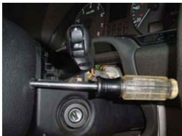
شکل ۱-۱۱۰ کاربرد آچار پیچ‌گشتی مغناطیسی
