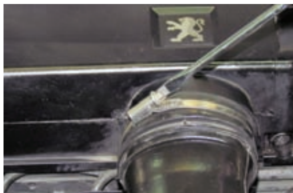
شکل ۲-۵ بازکردن بست فلزی لوله مکندۀ هوا
