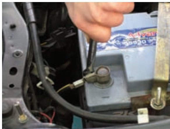
شکل ۲-۱۴۰ بازکردن بست اتصال ترمینال منفی باتری
