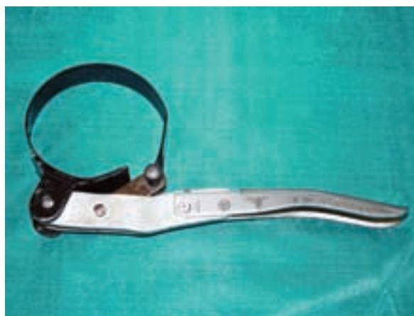
شکل ۲۱۴-۱ آچار فیلتر روغن
