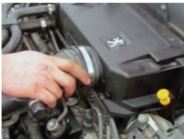
شکل ۲-۲۰ جازدن لوله مکندۀ هوا
