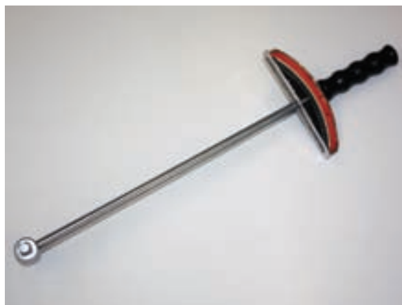
شکل ۱-۷۹ آچار درجه دار مکانیکی عقربه‌ای
