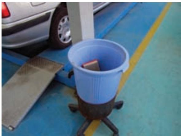
شکل ۲-۲۲ قراردادن فیلتر کارکرده در ظرف ضایعات
