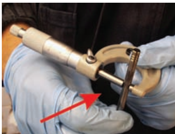
شکل ۱-۲۴۲ اندازه‌گیری قطر ساقه سوپاپ
