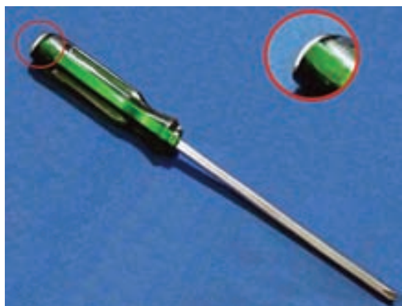
شکل ۱-۱۰۳ یک نوع آچار پیچ گشتی چکش خور
