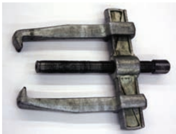
شکل ۱-۱۹۲ یک نوع پولی کش دو شاخه
