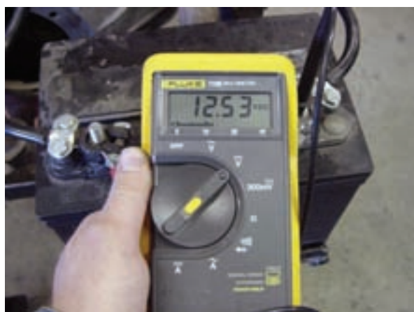
شکل ۱-۲۶۶ کاربرد مولتی متر برای تعیین شدت جریان باتری ۱۲ ولتی خودرو
