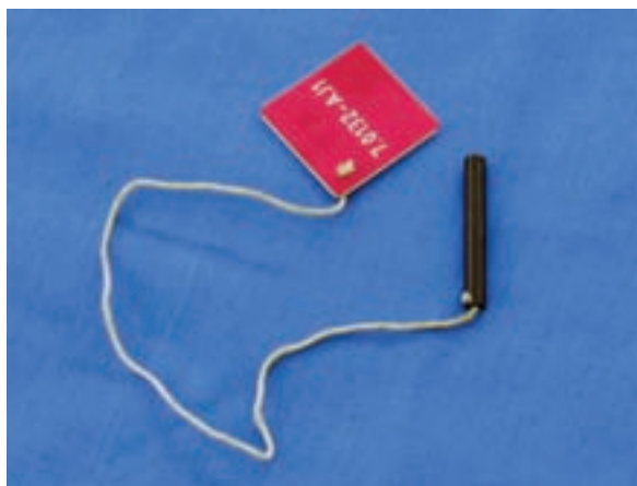
شکل ۱-۲۷۳ پین تنظیم تایم میل بادامک
