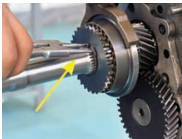
شکل ۱-۱۴۸ کاربرد خار بازکن
