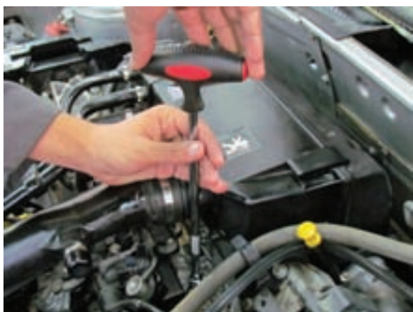
شکل ۲-۹۵ بستن شمع
