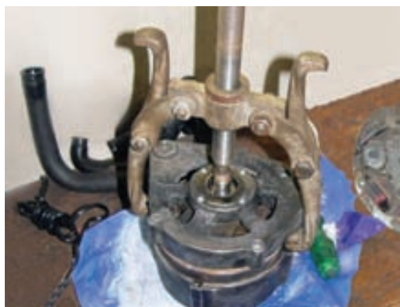
شکل ۱-۱۹۴ کاربرد پولی کش
