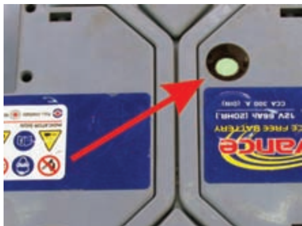
شکل ۲-۹۷ هیدرومتر، یا اسیدسنج باتری
