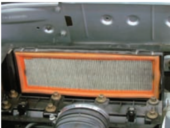
شکل ۲-۱۰ محل قرارگرفتن فیلتر هوا
