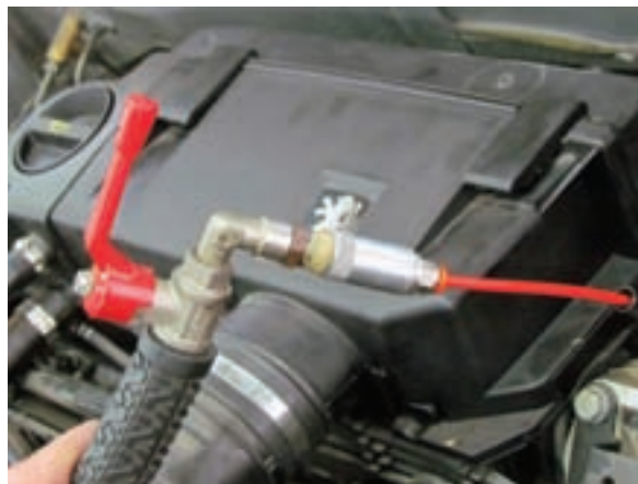
شکل ۲-۳۵ بازکردن شیر اصلی و دستگاه ساکشن
