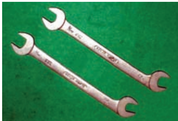
شکل ۱-۶ آچار دوسر تخت با انحراف دهانه ۳۰ درجه
