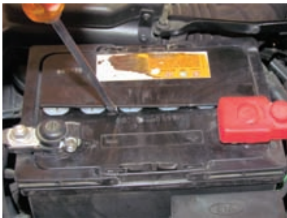
شکل ۲-۱۰۵ جدا کردن صفحه روی درپوش‌ها
