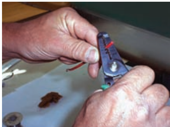
شکل ۱-۱۵۳ انبر سیم لخت کن و عملکرد آن
