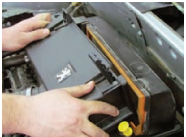
شکل ۲-۹ جداکردن قاب محفظه فیلتر هوا
