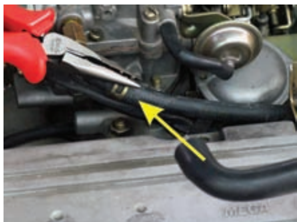
شکل ۱-۱۳۳ کاربرد انبر دم‌باریک
