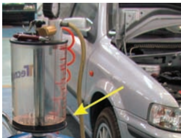
شکل ۲-۳۷ تخلیه روغن موتور به دستگاه ساکشن
