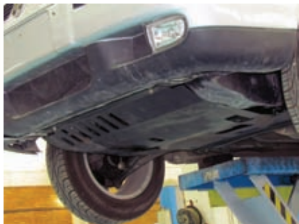
شکل ۲-۱۴۱ بالا بردن خودرو با جک بالا بر
