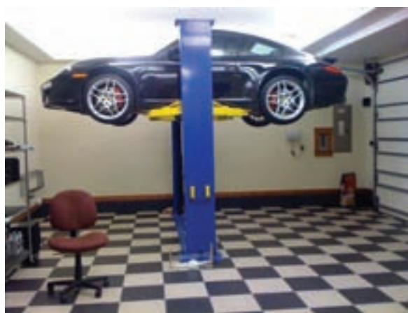
شکل ۱-۲۰۲ جک ثابت دوستونی
