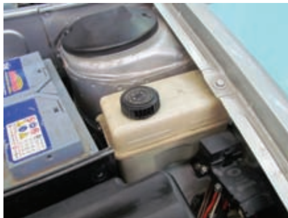
شکل ۲-۷۹ مخزن روغن هیدرولیک فرمان
