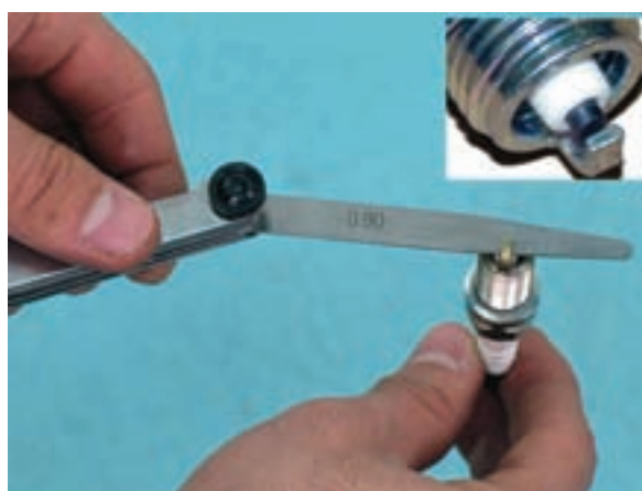
شکل ۱-۱۷۰ فیلرگیری دهانه شمع
