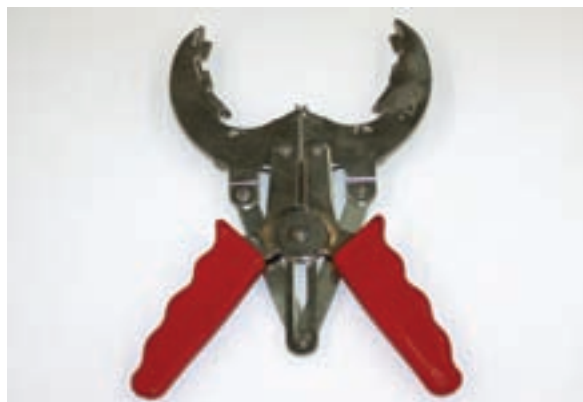
شکل ۱-۱۸۰ رینگ بازکن تکیه‌گاه‌دار
