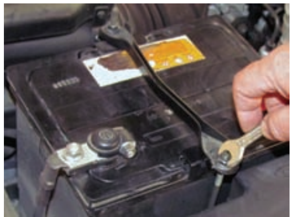
شکل ۲-۱۰۴ باز کردن بست نگهدارنده باتری
