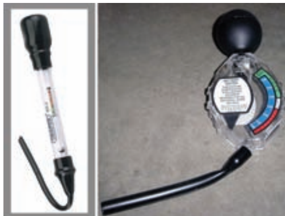
شکل ۱-۱۹۸ دو نوع چگالی سنج باتری (معمولی)
