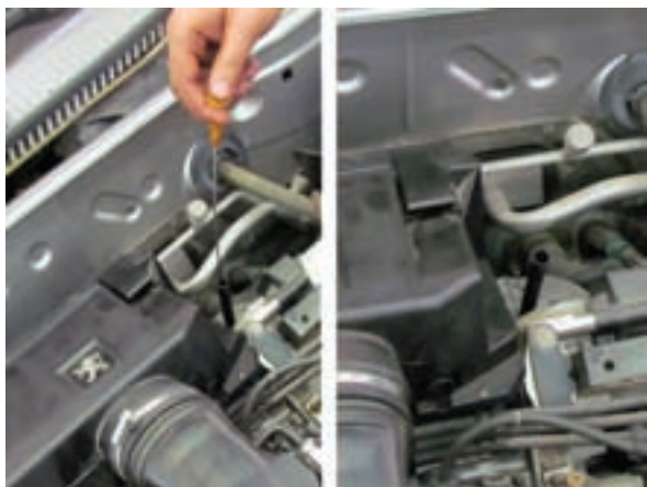
شکل ۲-۳۲ خارج کردن گیج روغن
