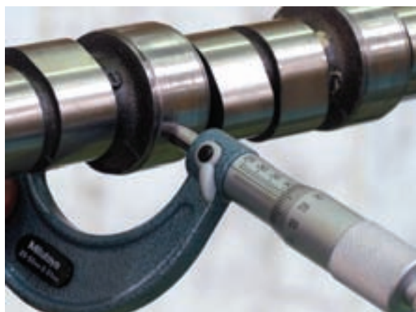
شکل ۱-۲۴۳ اندازه‌گیری قطر یاتاقان ثابت میل بادامک
