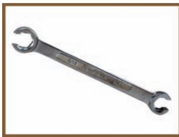
شکل ۱-۲۴ آچار رینگی شیاردار
