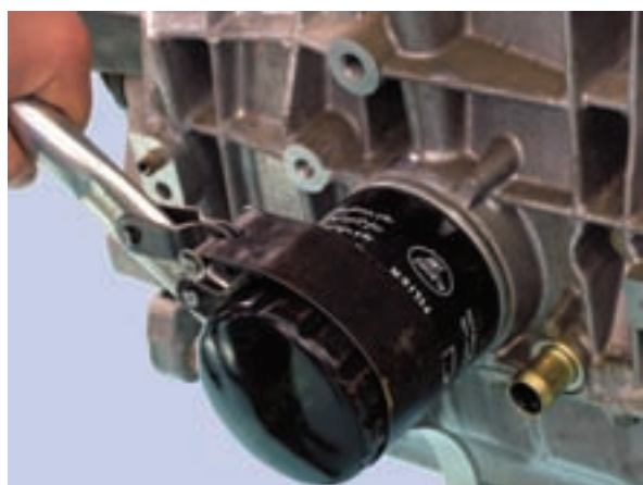
شکل ۲-۴۲ بازکردن فیلتر روغن
