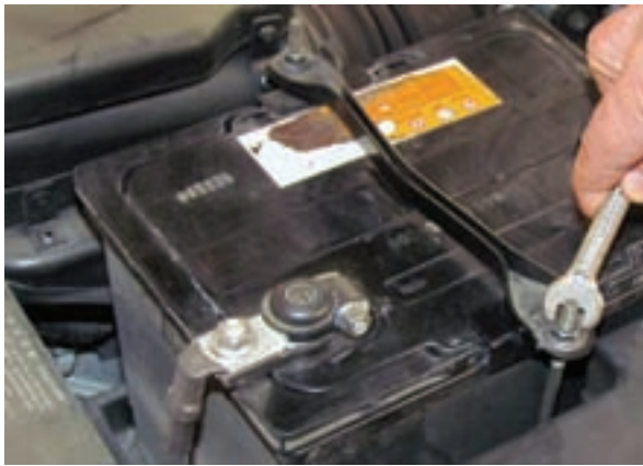
شکل ۲-۱۱۳ بستن بست نگهدارنده باتری
