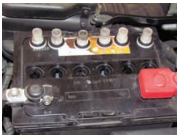
شکل ۲-۱۰۸ چیدمان درپوش‌ها و مراقبت از آنها
