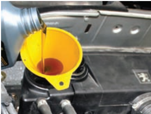
شکل ۲-۴۶ پرکردن موتور با روغن نو
