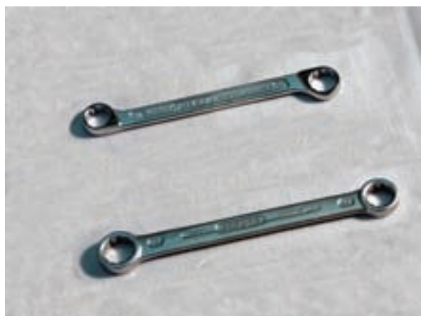
شکل ۱-۲۳ آچار رینگی سر کج و تخت
