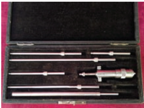
شکل ۱-۲۴۵ مجموعه میکرومتر داخل سنج
