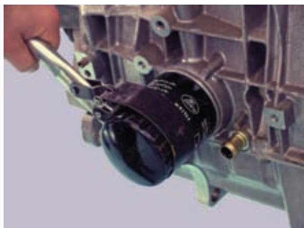
شکل ۲۱۵-۱ کاربرد آچار فیلتر روغن
