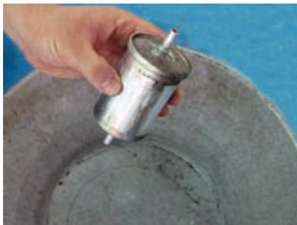
شکل ۲-۷۳ تخلیه بنزین داخل فیلتر بنزین
