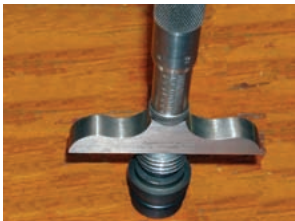
شکل ۲۵۷- کاربرد عمق سنج میکرومتری
