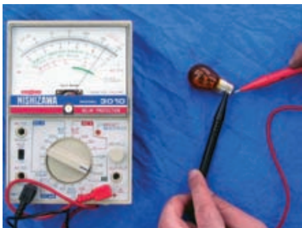
شکل ۱۵۷-۲ آزمایش لامپ چراغ راهنما
