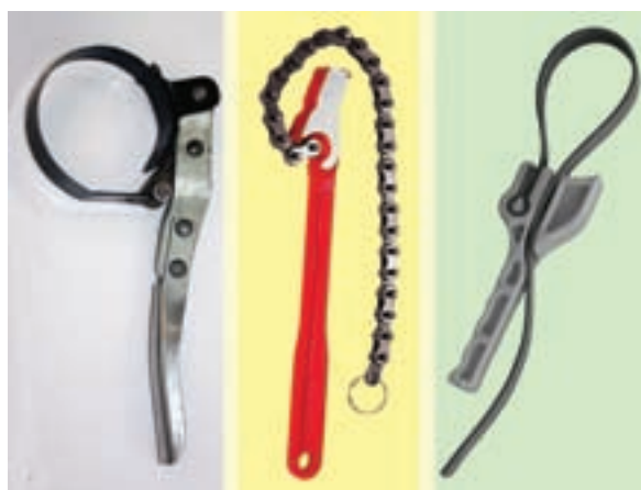
شکل ۲-۴۱ انواع آچار فیلتر روغن
