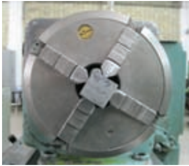
شکل ۲-۷ بستن قطعه کار با مقطع چهارگوش
