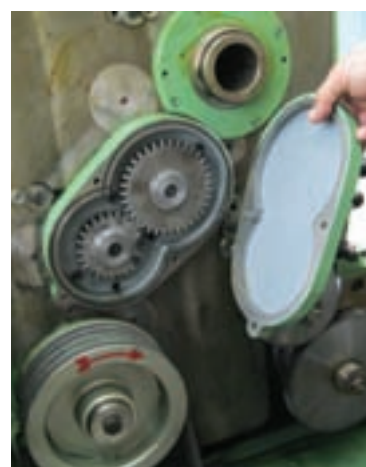
شکل ۱۳-۱ چرخ‌دنده‌های Z_1 و Z_2
