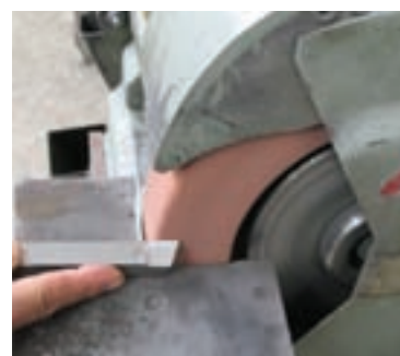
شکل ۴-۱۰ تیز کردن زاویه آزاد بغل
