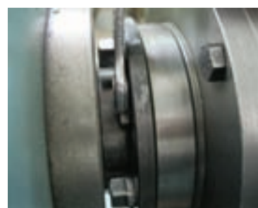
(b) باز کردن پیچ‌های تثبیت صفحه ضامن
