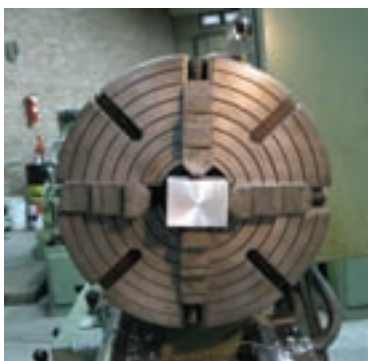
شکل ۲-۱۰ بستن قطعه کار با مقطع مستطیل شکل
