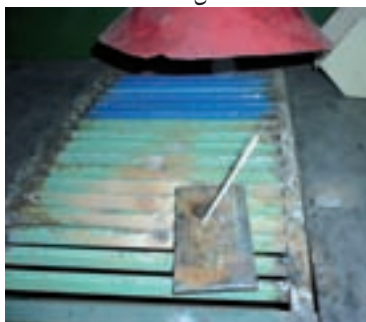
شکل ۴-۸b، الکتروود چسبیده به قطعه کار
