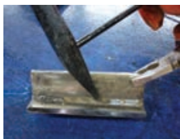
شکل ۳-۷ پاک کردن سرباره با مینی سنگ
