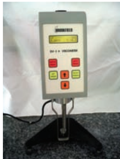
شکل ۲-۴۵- د: ویسکومتر چرخشی (بروکفیلد) دیجیتالی
