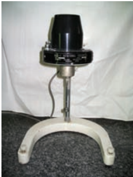
شکل ۲-۴۵- ج: ویسکومتر چرخشی (بروکفیلد) آنالوگ
