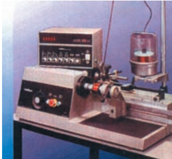
شکل ۱۲ دستگاه بوبین پیچ
