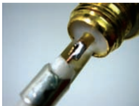
شکل ۱-۹۷- اتصال کابل کوآکسیال به BNC
