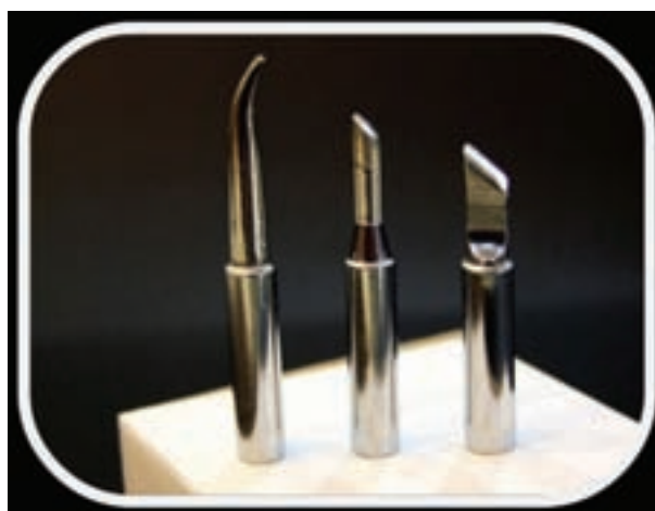
ب) سه نمونه دیگر از نوک هویه شکل ۳۷-۱- انواع نوک هویه
