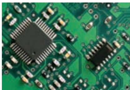
شکل ۳۱-۴ قطعات مونتاژ شده روی برد مدار چاپی
