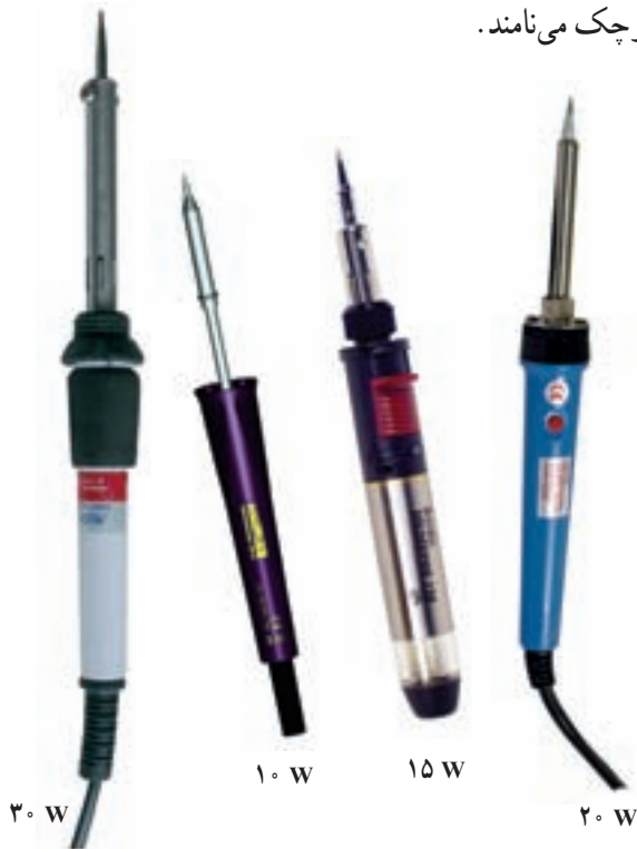
شکل ۱-۳۱- چند نمونه هویه با وات کم
