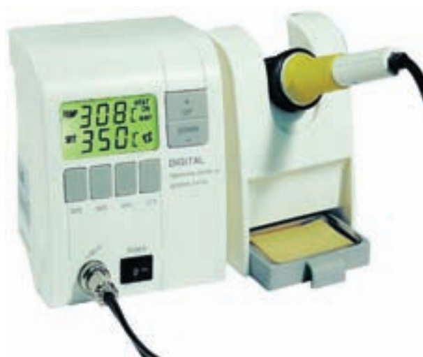
شکل ۳۵-۱- یک نمونه هویه پیش‌رفته و مدرن
