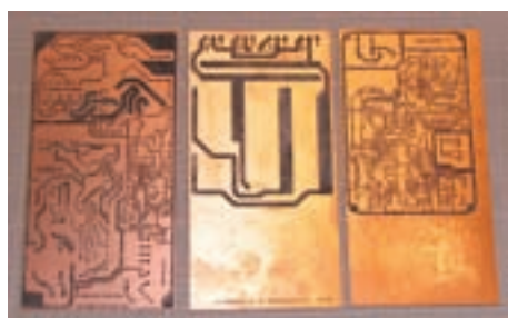
طراحی مدار چاپی و انتقال روی فیبر
