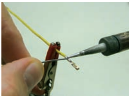
شکل ۱-۵۰- لحیم کاری به کمک گیره
