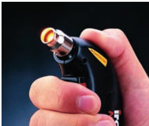
شکل ۱-۶۲- دستگاه گرم کن برای وارنیش حرارتی
