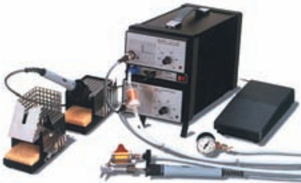
شکل ۱-۶۷- دستگاه قلع کش با کنترل حرارت الکترونیکی
