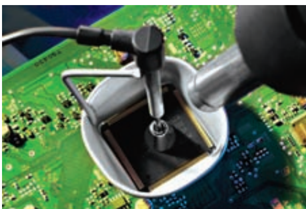
شکل ۹۰-۱- استفاده از هویه هوای گرم برای مونتاز و دمونتاز
