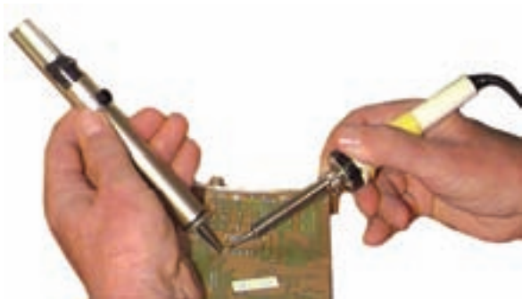
شکل ۱-۷۳- نمونه دیگری از کار قلع کش پیستونی
