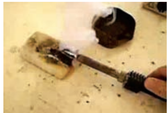
شکل ۳۸-۱- ساده ترین راه تمیز کردن نوک هویه
