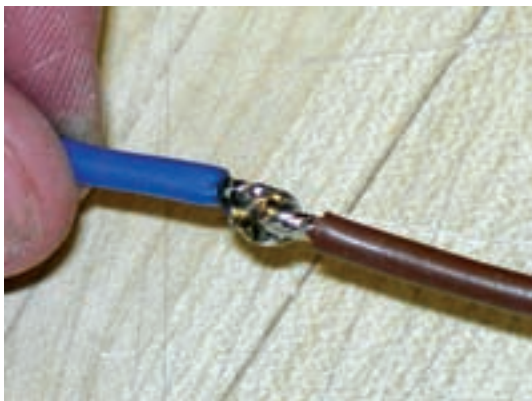
شکل ۱-۵۵- نمونه دیگری از لحیم کاری قابل قبول
