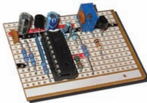
شکل ۱-۱۰۴- یک نمونه مدار کامل روی فیبر سوراخ‌دار
