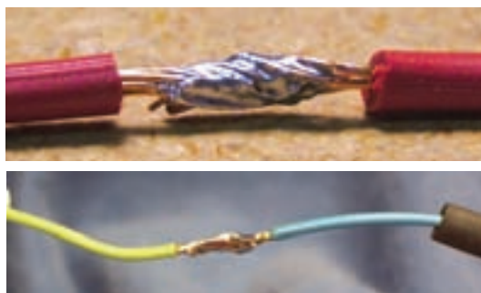
شکل ۱-۵۴- دو نمونه لحیم کاری قابل قبول
