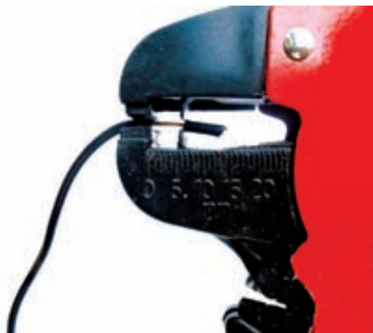
شکل ۱-۴۹- لخت کردن سیم
