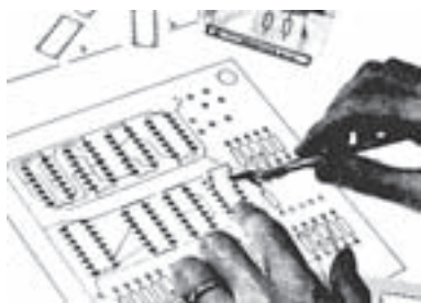
شکل ۲۹-۴- نحوه چسباندن لتراست مربوط به پایه قطعات
