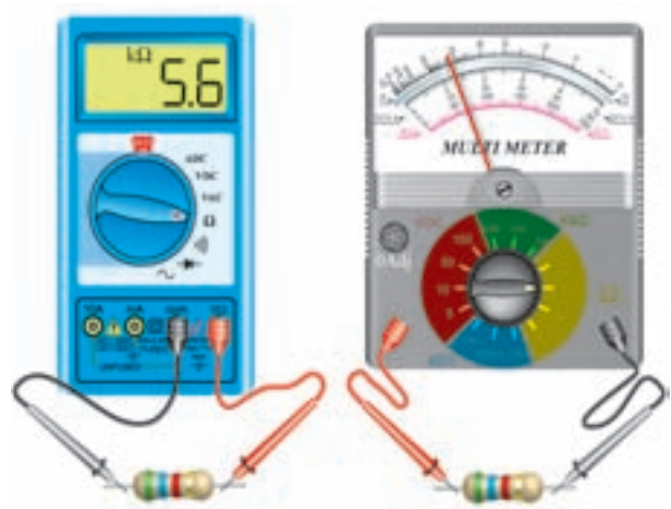
شکل ۷-۱- استفاده از حوزه کار صحیح دستگاه اندازه گیری
