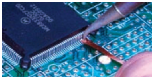
شکل ۱-۷۵- جدا کردن آی سی با فتیله لحیم
