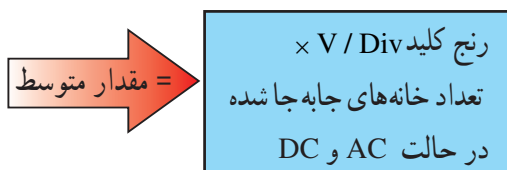
شکل ۳۰-۴ نحوه‌ی اندازه‌گیری ولتاژ AC سوار بر DC
