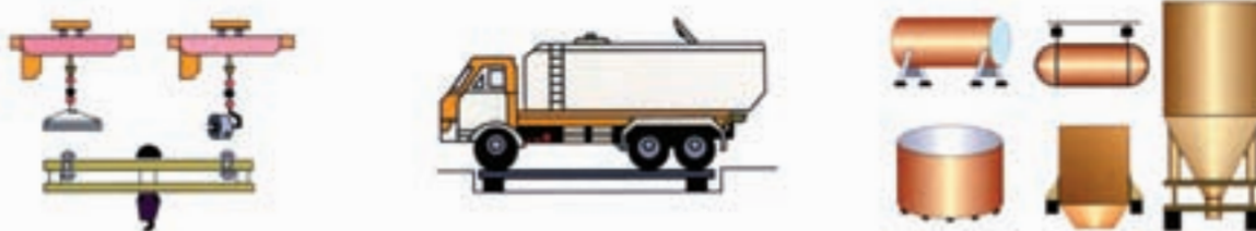
شکل ۱-۵۶- نحوه‌ی قرار گرفتن لودسل‌ها برای سیلو، باسکول و باسکول آویز
