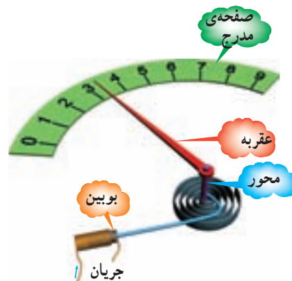
شکل ۵-۳۲ دستگاه اندازه‌گیری با هسته‌ی متحرک
