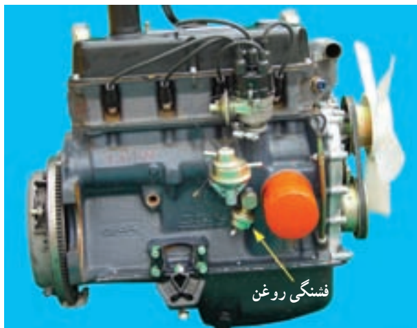
شکل ۱-۱۵- موتور اتومبیل و محل نصب شمع فشنگی یا سنسور روغن
