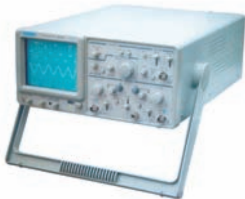
شکل ۴-۲۴- یک اسیلوسکوپ دو کاناله که به‌طور همزمان دو شکل موج را روی صفحه‌ی حساس خود نشان می‌دهد.
