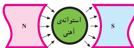
شکل ۵-۳ چگونگی ایجاد میدان مغناطیسی یک‌نواخت و شعاعی
