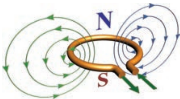
شکل ۲۸-۵ میدان مغناطیسی حاصل در یک حلقه
