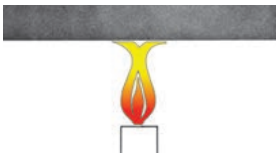
شکل ۱۵-۵- خنثی کردن اثر مغناطیسی یک آهن ربا به وسیله گرما
