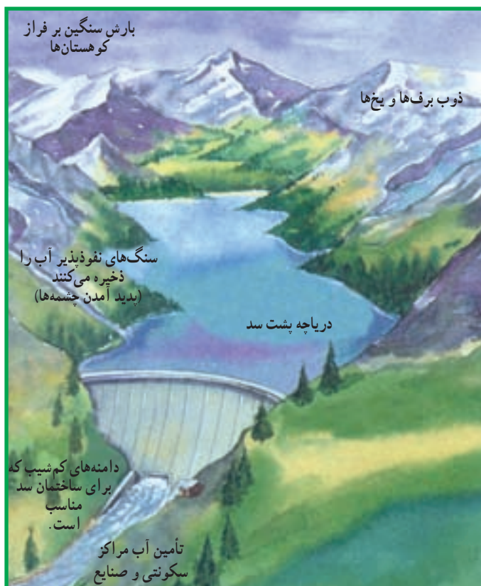
شکل ۳- مهار آب‌ها برای تولید برق در کوهستان
