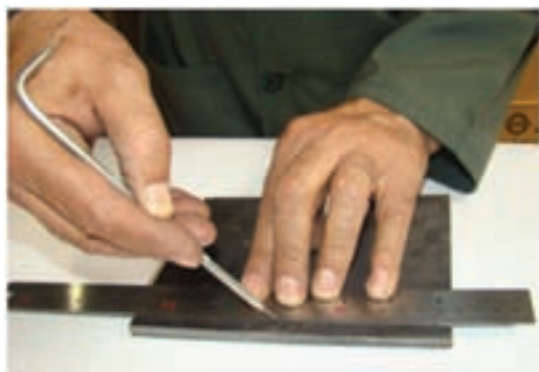
شکل ۲۹-۵ رسم خط با سوزن خط‌کش
