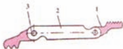
۱- تیغه نازک فولادی ۲- قاب محافظ ۳- بیج و مهره اتصال
