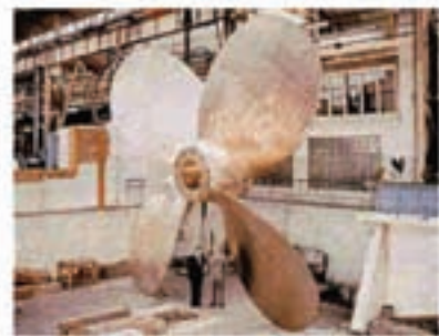
ساخت پروانه کشتی آلیاژی از مس
