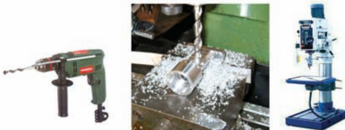
شکل ۲-۲۲ ماشین مته و سوراخ کردن یک قطعه با سرمته
