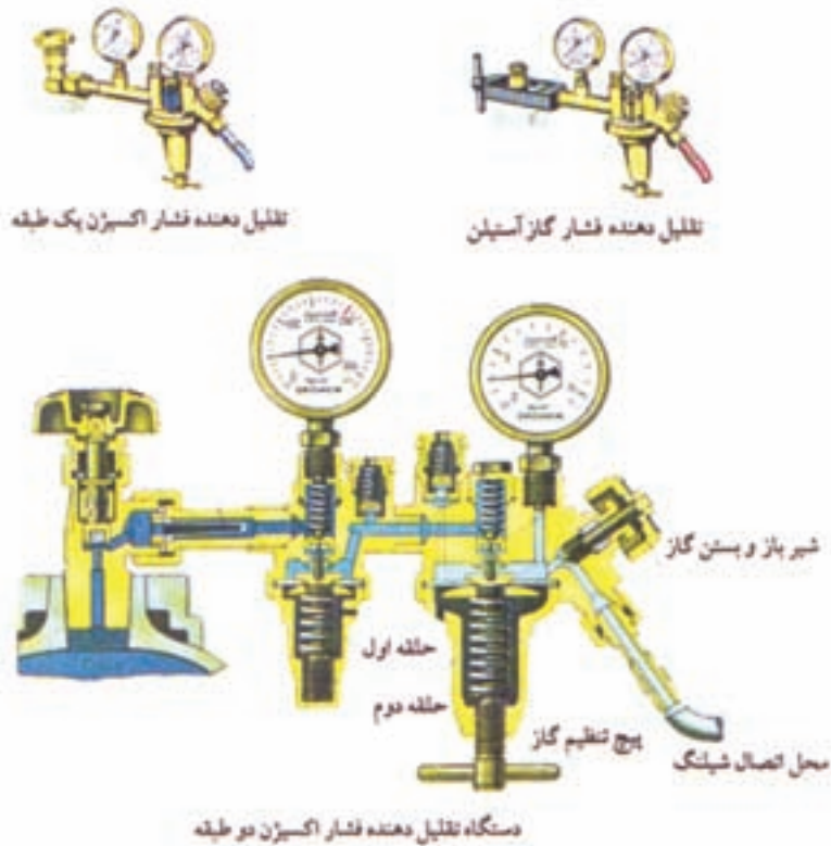
شکل ۵-۱۴ رگولاتورهای اکسیژن و استیلن
