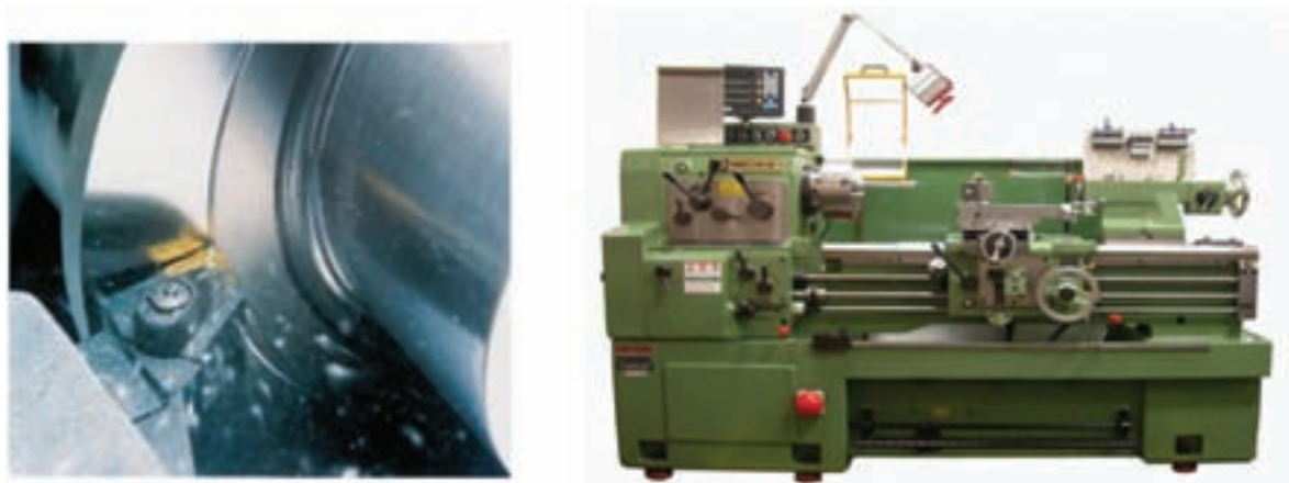
شکل ۱۹-۲ ماشین تراش کاری و عمل براده‌برداری
