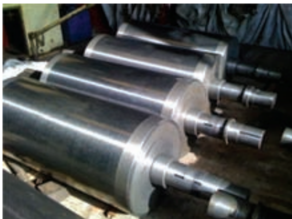
شکل ۸-۲ غلتک کارخانه نورد از جنس چدن سفید
