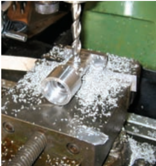
شکل ۴-۱ عملیات سوراخ کاری
