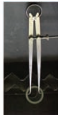
شکل ۲۵-۵ انتقال اندازه با پرگار کج و تعیین اندازه منتقل شده
