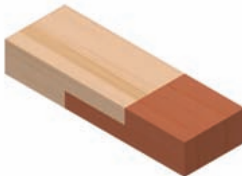
شکل ۹-۷۳- اتصال طولی نیم و نیم ساده.
