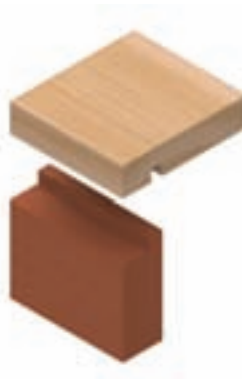
شکل ۹-۴۴- اتصال گوشه‌ی صفحات ساده، با کنشکاف و زبانه‌ی پخ‌خورده.
