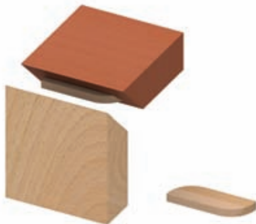
شکل ۹-۶۹- اتصال گوشه‌ی صفحات قلیف با زبانه‌ی پیش ساخته.
