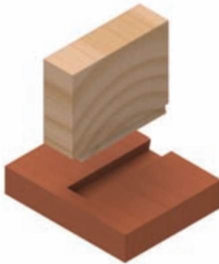
شکل ۹-۶۱- اتصال گوشه‌ی صفمات گرات - شکاف گرات و زبانه در جلو ۱ تا ۲ میلی‌متر باریک‌تر هستند.
