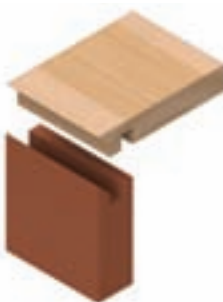
شکل ۹-۱۴۶- اتصال گوشه‌ی صفمات دو رو مخفی (فارسی)، با دو کنشکاف و دو زبانه.
