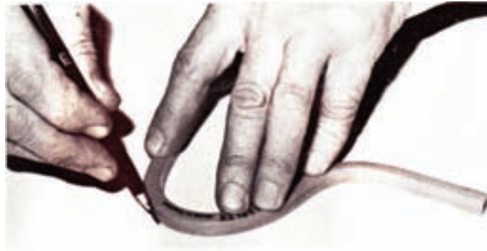
شکل ۲-۵۴- نمونه‌ی ترسیم خط منحنی توسط پیستوله‌ی ماری.
