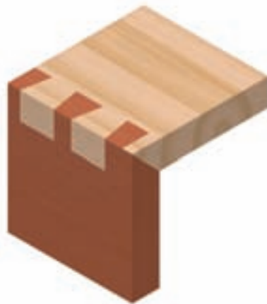
شکل ۹-۳۸- تصویر مجسم اتصال دم چلچله‌ی ساده با پَرِ فارِس.
