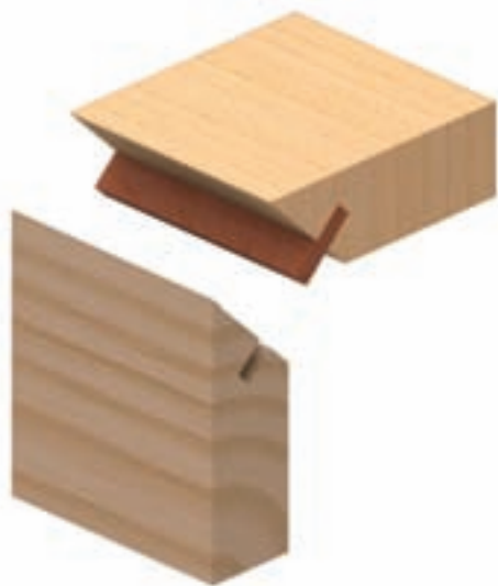
شکل ۹-۶۵- اتصال گوشه‌ی صفمات قلیف با زبانه بلند.
