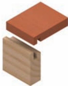
شکل ۹-۱۴۵- اتصال گوشه‌ی صفمات یک رو مخفی، با دو کنشکاف و دو زبانه.
