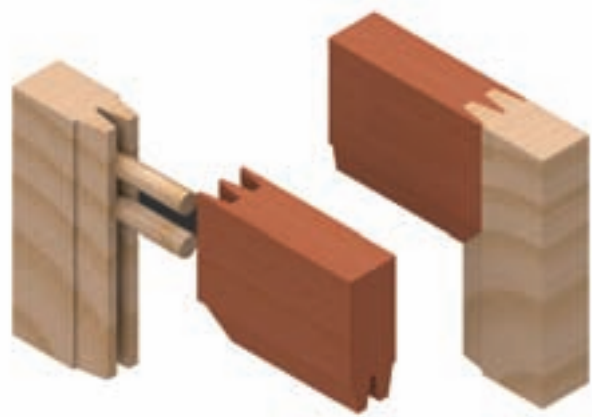
شکل ۹-۲۹- الف) اتصال گوشه‌ای دابل با پروفیل دوطرفه
