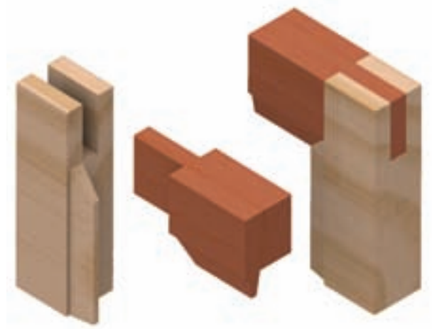
شکل ۹-۱۴- اتصال گوشه‌ای فاق و زبانه‌ی ساده با دوراهی و پیچ فارسی.
