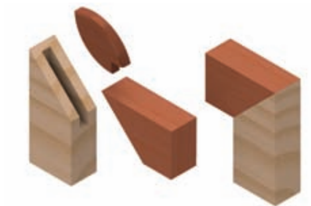
شکل ۹-۲۴- اتصال گوشه‌ای دو رو فارسی مففی، با زبانه‌ی جداگانه‌ی بیضی‌شکل.
