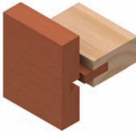
شکل ۹-۶۸- طریقه‌ی ترسیم اتصال گوشه‌ی صفمات قلیف با زبانه گونیایی.
