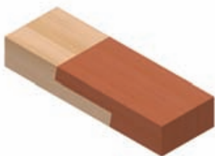
شکل ۹-۷۴- اتصال طولی نیم و نیم سرکج.
