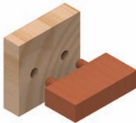
شکل ۹-۵۲- اتصال گوشه‌ی صفمات دویل با افتلاف سطح.
