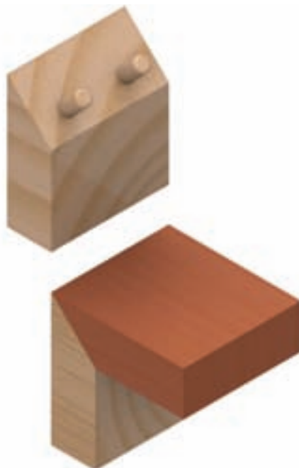
شکل ۹-۵۴- اتصال گوشه‌ی صفمات دویل فارسی.
