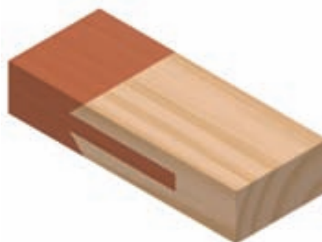
شکل ۹-۷۷- اتصال طولی فاق و زبانه‌ی سرکج.
