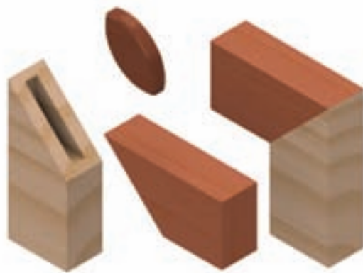
شکل ۹-۲۵- اتصال گوشه‌ای دو رو فارسی مففی با زبانه‌ی کوتاه بیضی‌شکل (اتصال بیسکویتی).
