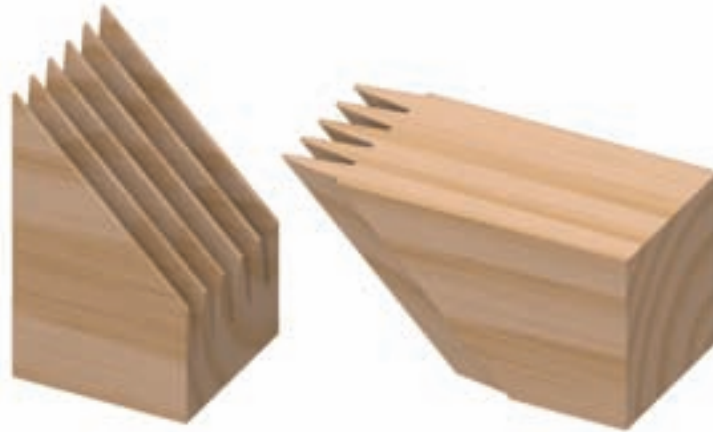
شکل ۹-۳۰- اتصال گوشه‌ای شانه، در سه اندازه‌ی مختلف
