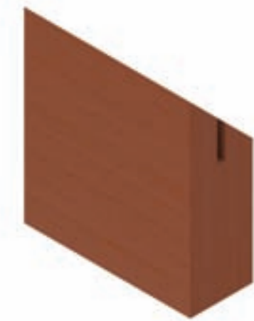
شکل ۹-۶۳- اتصال گوشه‌ی صفمات قلیف، با زبانه‌ی پیش سافته از مواد مصنوعی.
