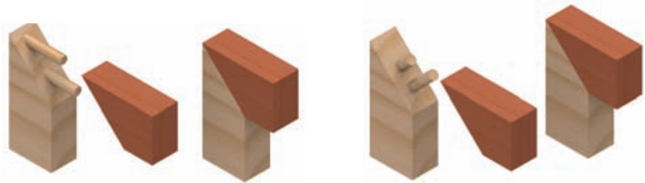
شکل ۹-۲۶- ب) طریقه‌ی ترسیم اتصال دابل. A- قرارگیری دابل‌ها در اتصالات با درز ساده. B- قرارگیری دابل مستقیم در اتصالات با درز فارسی. C- قرارگیری دابل گونیا‌یی در اتصالات با درز فارسی.
