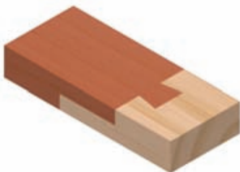
شکل ۹-۷۸- اتصال طولی نیم و نیم با دم چلپله‌ی یک یا دو طرفه.
