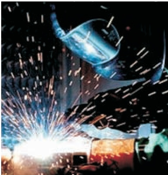
شکل ۲-۵ برشکاری با الکتروود دستی
