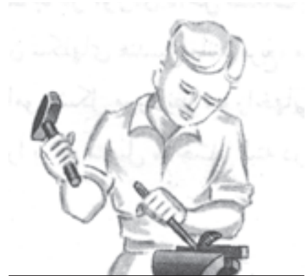
الف) قلم کاری نادرست
