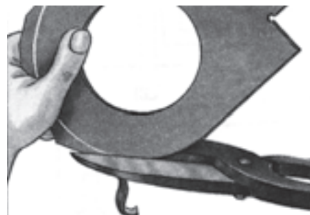
شکل ۳-۶ برشکاری خط‌های منحنی با قیچی تیغه صاف
