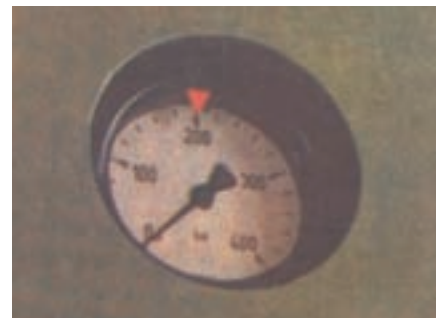
شکل ۲-۵۷ کنترل فشار روغن هیدرولیک
