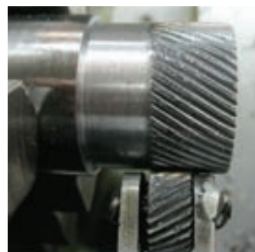
شکل ۹-۱۳ بعد از انجام آج‌زنی قطر قطعه افزایش می‌یابد
