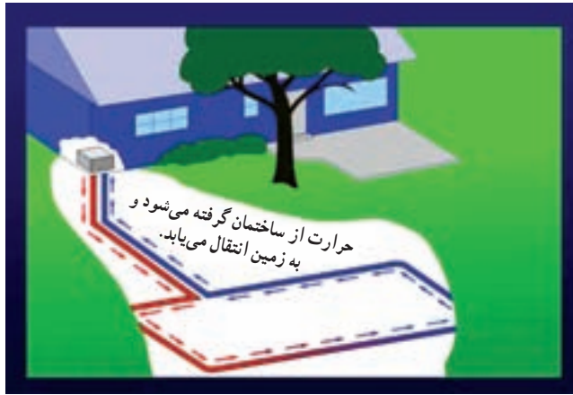
شکل ۷-۳ چگونگی کار پمپ حرارتی در تابستان
