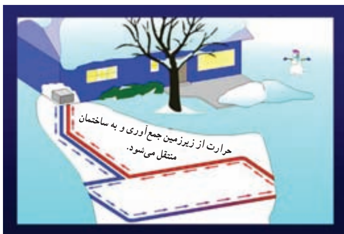
شکل ۶-۳ چگونگی کار پمپ حرارتی در زمستان
