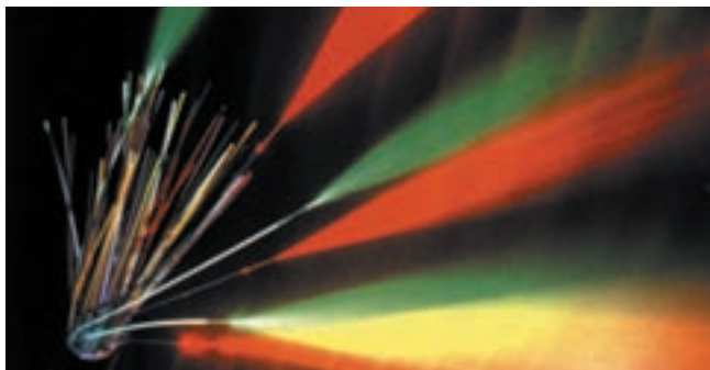
شکل ۱۳ در صنعت مخابرات رشته‌های نوری جایگزین بسیار مناسبی برای فلز مس به‌شمار می‌آیند.
