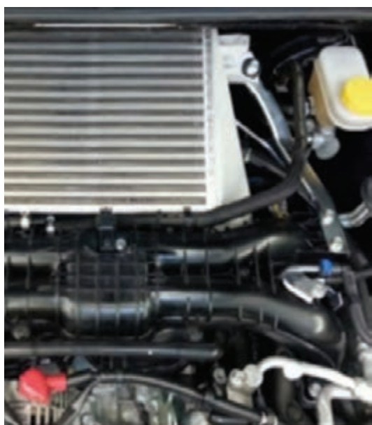
شکل ۳۵- افتر کولرهای استفاده شده در خودرو
