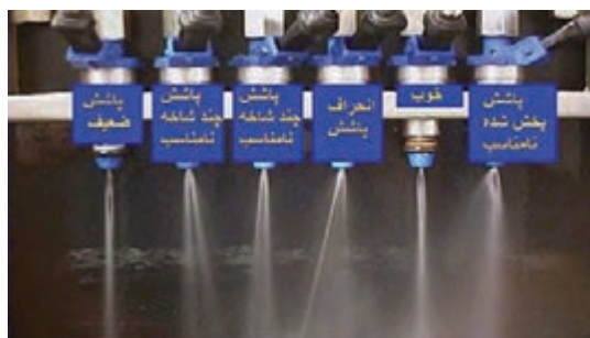
شکل ۷۷- انواع احتمالی پاشش سوخت در انژکتور
