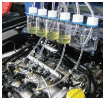
شکل ۴۰- تست اندازه گیری مقدار سوخت برگشتی انژکتورها
