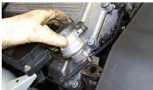
باز کردن شیر کنترل پمپ دمنده
