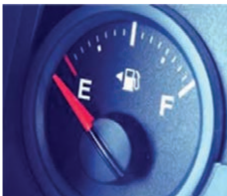
شکل ۹۱- نمایشگر سوخت آنالوگ (عقربه ای)
