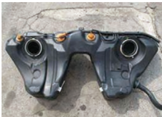
شکل ۷- مخزن سوخت با سوپاپ واژگونی
