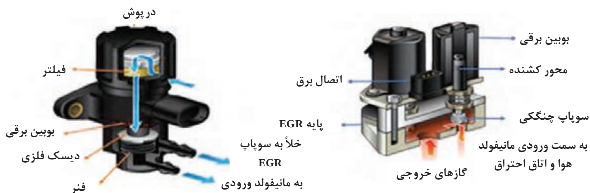
شکل ۱۶- شیر برقی EGR مدل بیرونی و داخلی
