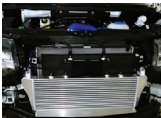
شکل ۳۴- اینتر کولرهای استفاده شده در خودرو
