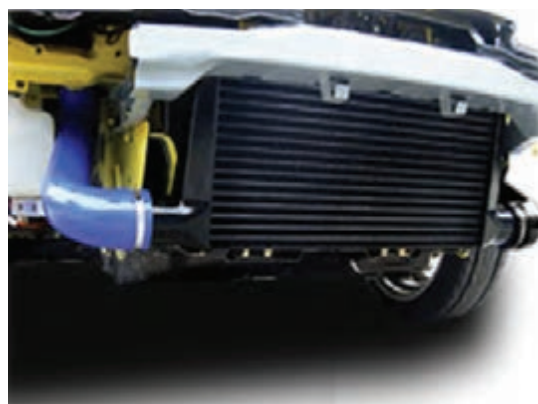
شکل ۳۴- اینتر کولرهای استفاده شده در خودرو
