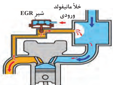
شکل ۱۹- مسیر عبور گازهای خروجی خلأی
