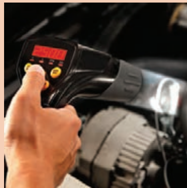
شکل ۲۱- روش کاربری چراغ تایمینگ
