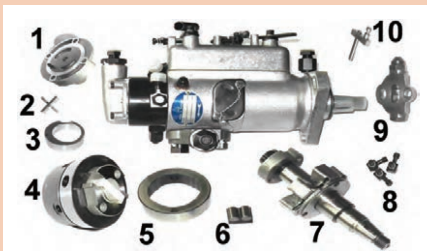
شکل ۲۱- پمپ انژکتور دوار (CAV) آمریکای شمالی معروف به پمپ آسیابایی
