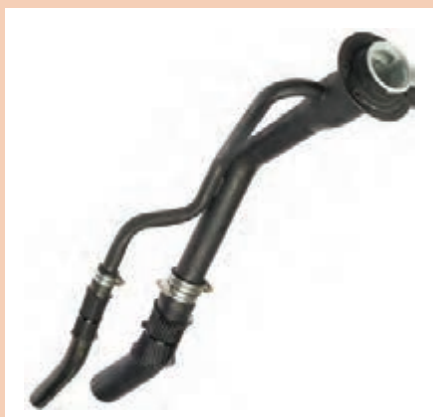
شکل ۳۷- لوله فلزی ورودی و مجرای کناری
