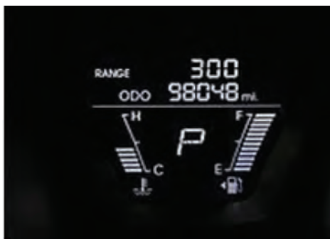
شکل ۹۲- نمایشگر سوخت دیجیتالی (میله ای)
