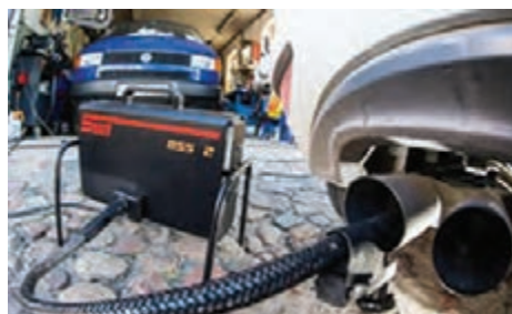
شکل ۵۴- قراردادن لوله دستگاه کنترل آلاینده‌گی درون لوله اگزوز
