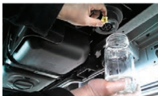
شکل ۷۷- روش تخلیه آب موجود در فیلتر سوخت دیزل
