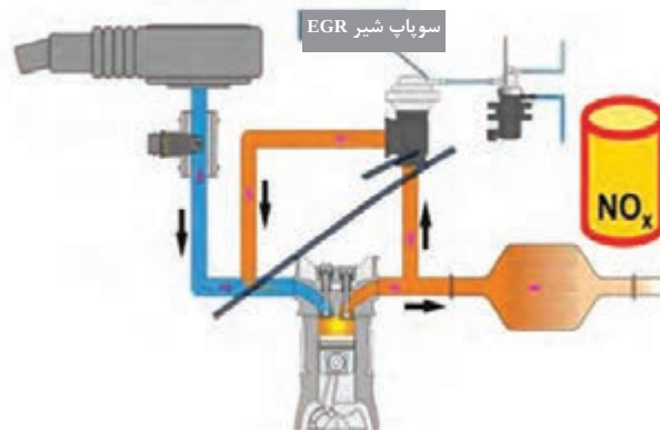
شکل ۱۵- سیستم EGR و مدار آن
