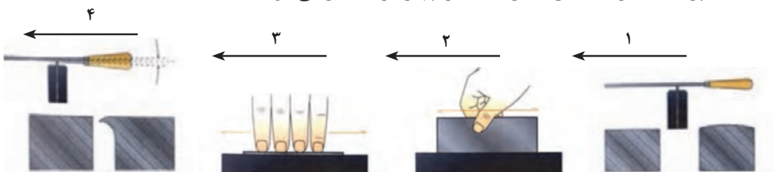
شکل ۱۱۷- مراحل تیزکردن لیسۀ
