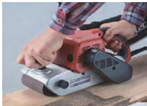
شکل ۴۸- سنباده کاری تخته‌های پهن
