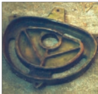
شکل ۱۸- صفحه بادامکی معیوب
