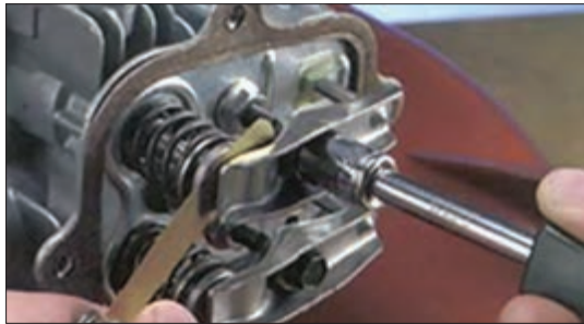
شکل ۳۵- فیلر کردن سوپاپ
