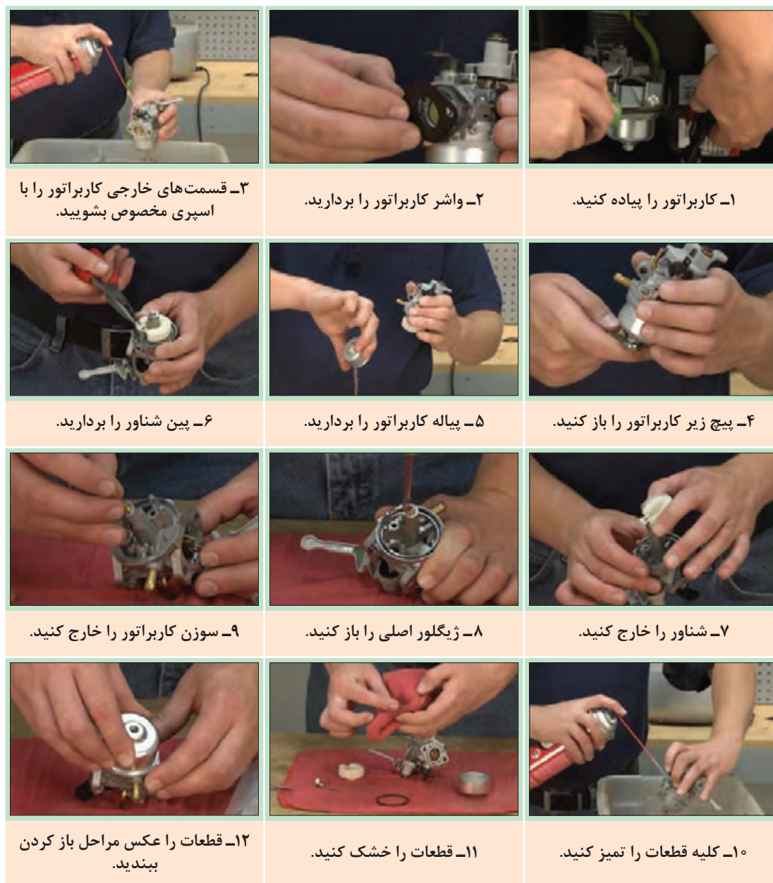
شکل ۲۵- باز کردن و تمیز کردن قطعات کاربراتور
