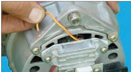
ب) اتصال بدنه کردن سیم متصل به زغال منفی
