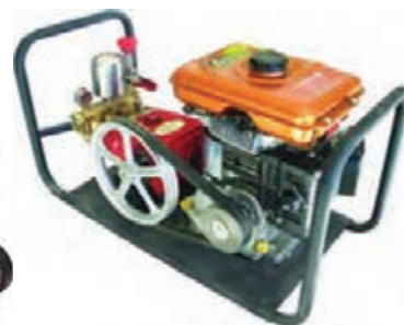
شکل ۱۹- انتقال قدرت در سم‌پاش‌های زنبه‌ای
