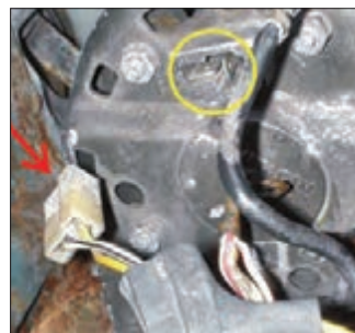
شکل ۲۶- جدا کردن کائوچویی سیم‌کشی لامپ شارژ
