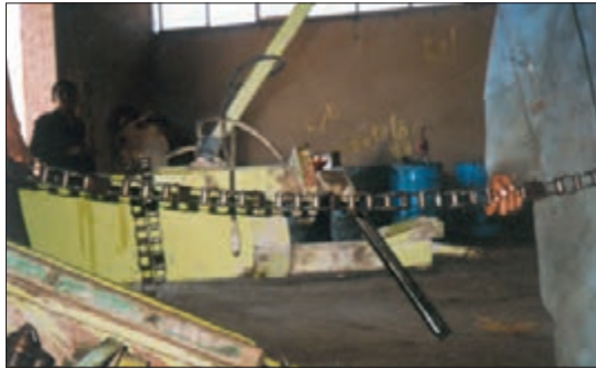
شکل ۱۸- آزمایش زنجیرهای هدایت‌کننده
