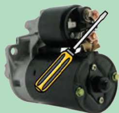
شکل ۴۳- اتصال کوتاه موتور استارتر
