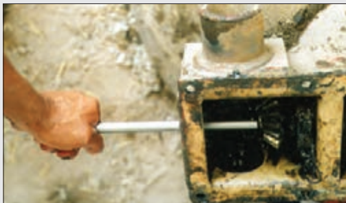
شکل ۲۷- ضربه از طرف درپوش توسط میله
