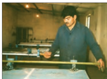
شکل ۱۱- صاف کردن محور انگشتی
