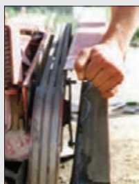
شکل ۸- برداشتن قاب تسمه‌ها
