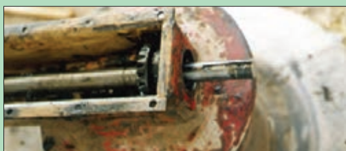
شکل ۲۸- خارج کردن محور افقی از محل درپوش
