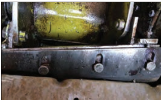
شکل ۴۴- پیچ و شیارهای رگلاژ تیغه متحرک
