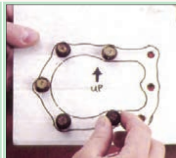
۷- شکل شماتیک سرسیلندر را روی یک تکه کارتن کشیده و محل پیچ‌ها را روی آن مشخص کنید.
