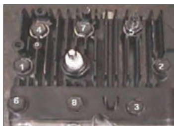
شکل ۳۴- ترتیب بستن پیچ‌های سرسیلندر
