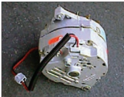
شکل ۱۸- آلترناتور مجهز به آفتامات الکترونیکی
