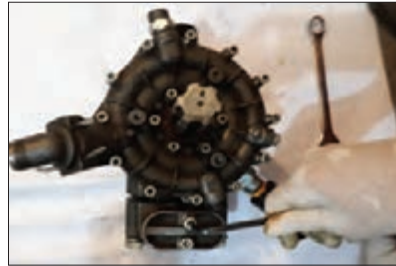
شکل ۴۸- باز کردن درپوش سوپاپ‌ها
