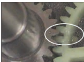
شکل ۳۳- علامت تایم کردن میل بادامک
