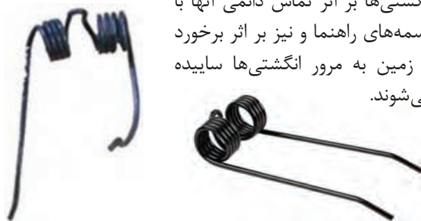
شکل ۴- تفاوت انگشتی سالم و انگشتی معیوب
