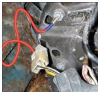
شکل ۲۷- آزمایش مدار لامپ شارژ
