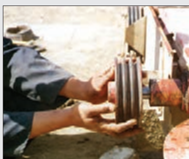
شکل ۱۱- برداشتن چرخ تسمه
