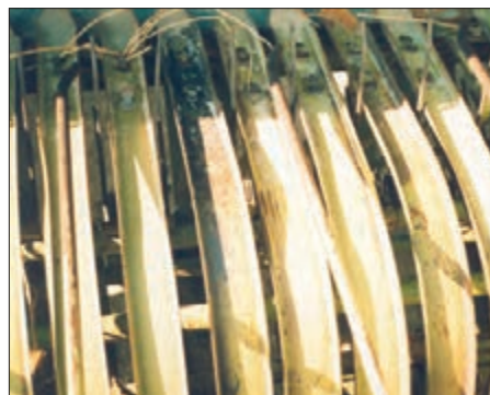
شکل ۶- ساییده شدن انگشتی‌ها به تسمه‌های راهنما
