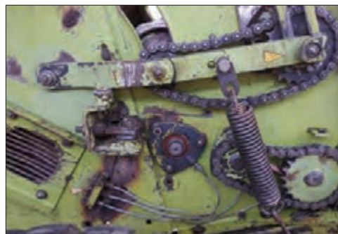
شکل ۳۷- فنر شناوری غلتک‌های بالایی
