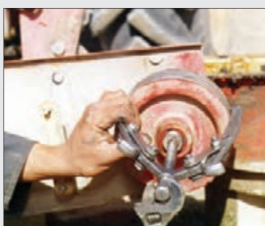
شکل ۱۰- خارج کردن چرخ تسمه
