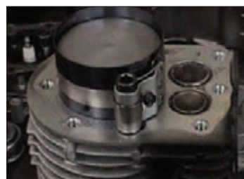
شکل ۳۲- جا زدن پیستون
