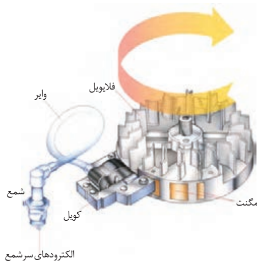
شکل ۷- طرز کار سیستم جرقه زنی
