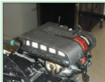
۴- در پوش فیلتر هوا را باز کنید.
