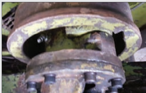
شکل ۴۸- پیچ‌های اتصال کلاچ به یوک چهارشاخه گاردان
