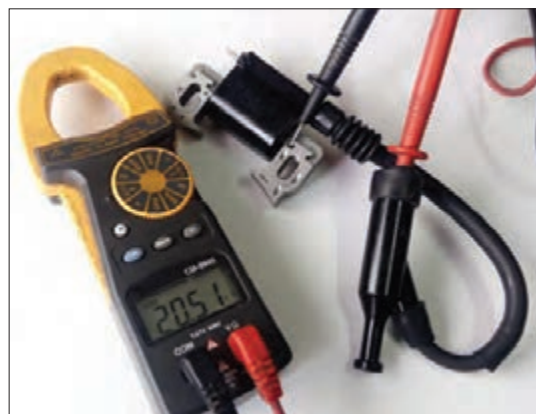
الف) مقاومت سیم پیچ ثانویه بین بدنه کوئل و سر شمع حدوداً ۲۵/۵ کیلو اهم
