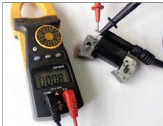
ب) مقاومت سیم پیچ اولیه (سیم متصل به سوئیچ) و بدنه کوئل حدوداً ۰/۸ اهم
