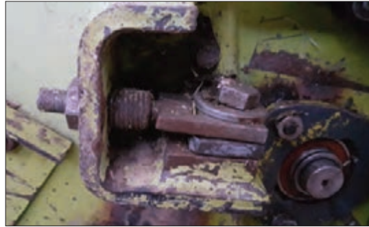
شکل ۴۲- پیچ تنظیم تیغه ثابت
