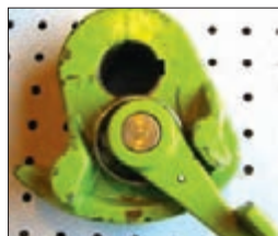
شکل ۷۰- ضامن کلاچ گره‌زن و موقعیت آن روی گره‌زن
