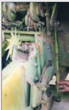
شکل ۶۵- برداشتن میله رابط
