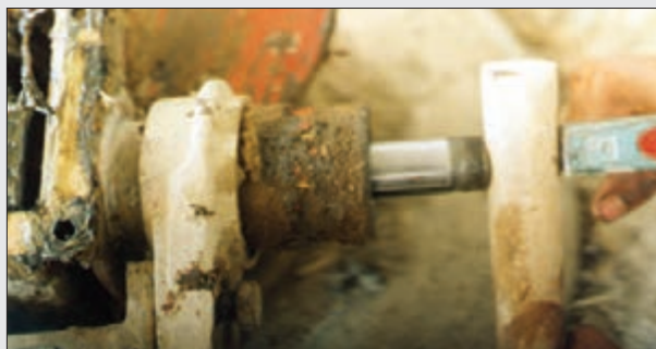
شکل ۲۳- خارج کردن محور ورودی
