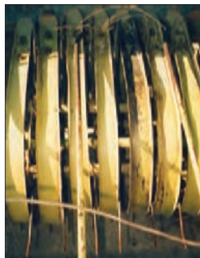
شکل ۲۲- تسمه ساییده و کج شده
