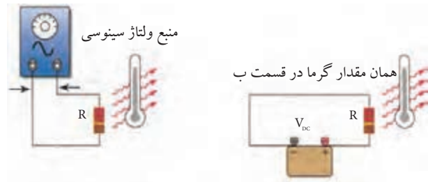
الف- مدار جریان مستقیم ب- مدار جریان متناوب
