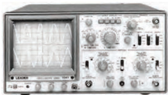
شکل ۶-۳۵ نمایش همزمان دو شکل موج توسط اسیلوسکوپ
