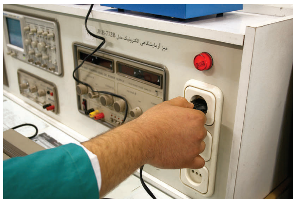
شکل ۱-۳۸ اتصال صحیح دو شاخه
