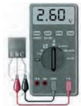
شکل ۴۹-۱۲ ترانزیستور معیوب (قطع)
