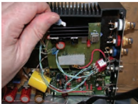
شکل ۷-۱۴ محل نصب هیت سینک
