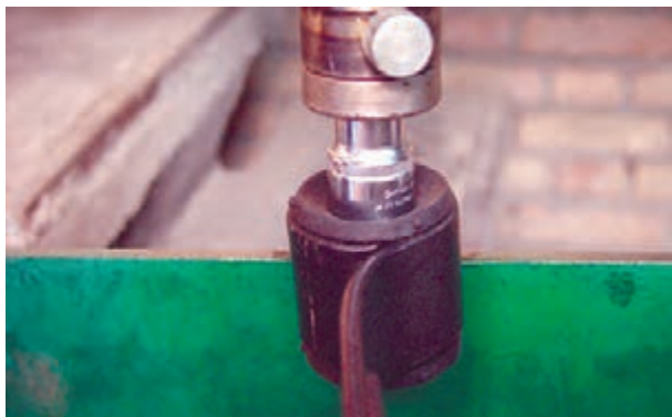
شکل ۳-۶۹- بوش لاستیکی فلزی محل اتصال شاه فنر
