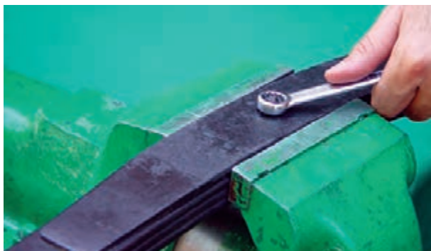
شکل ۳-۶۸- باز کردن پیچ مرکز فنرهای شمش
