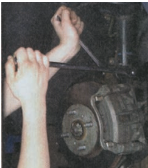
شکل ۳-۱۰۰ نصب مجموعه سیستم تعلیق روی خودرو
