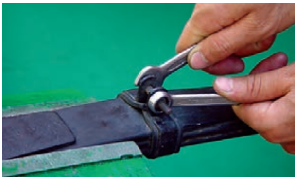
شکل ۳-۶۷- باز کردن بست‌های مجموعه فنر شمش
