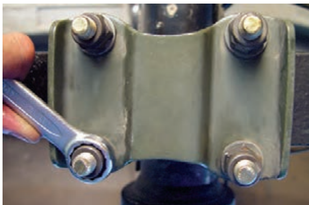
شکل ۳-۶۶- باز کردن مهره‌های کربی‌ها (پیچ‌های U شکل)
