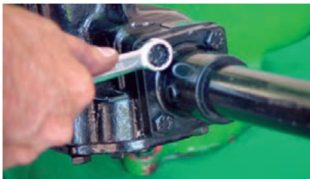
شکل ۲-۶۰ باز کردن پیچ‌های لوله فرمان
