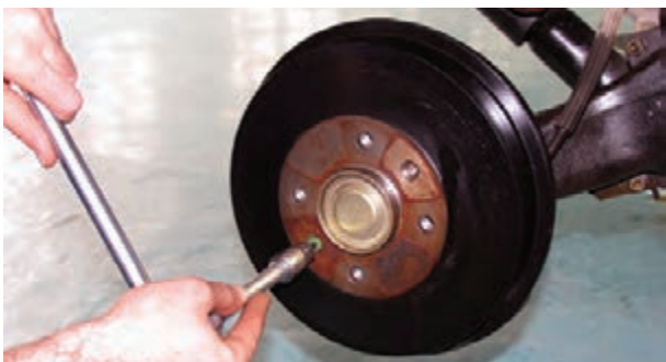
شکل ۱-۸۹ – باز کردن پیچ کاسه چرخ
