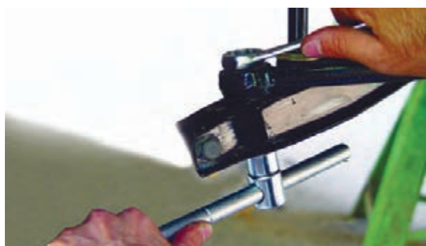
شکل ۳-۸۱- باز کردن میل تعادل از طبق
