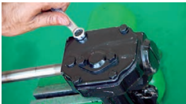
شکل ۲-۶۲ باز کردن درپوش بالایی جعبه فرمان
