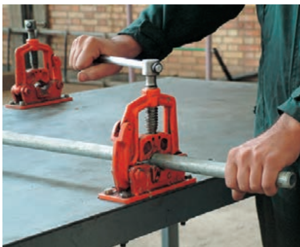
شکل ۱-۲۸- بستن لوله به گیره‌ی لوله
