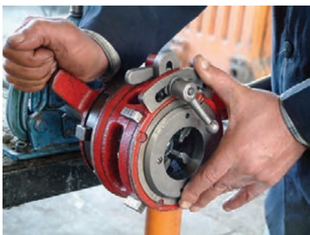
شکل ۴-۱۱۴- سفت کردن فلکه‌ی چهار نظام
