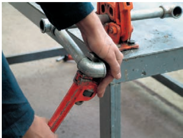
شکل ۱۰۵-۵- روش غلط سفت کردن مدار
