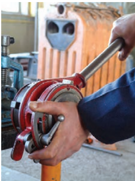
شکل ۴-۱۲۲- عمل درگیر کردن پارچه‌ها با سر لوله
