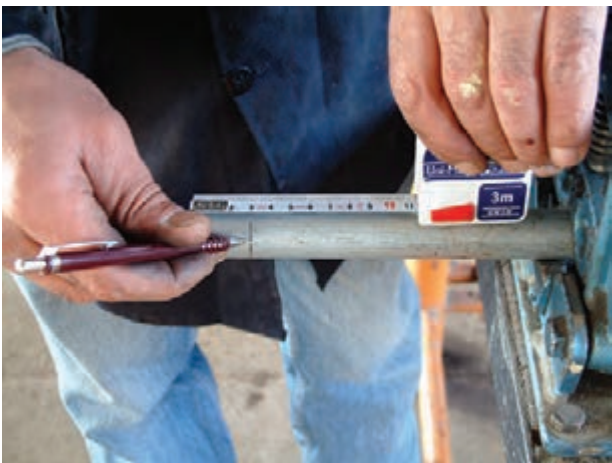
شکل ۵۳-۱- مشخص کردن محل برش
