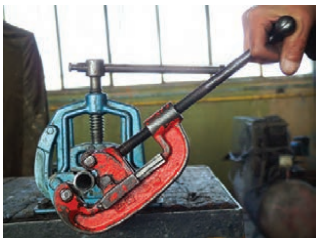
شکل ۱-۵۶- گرداندن لوله‌بُر به دور لوله
