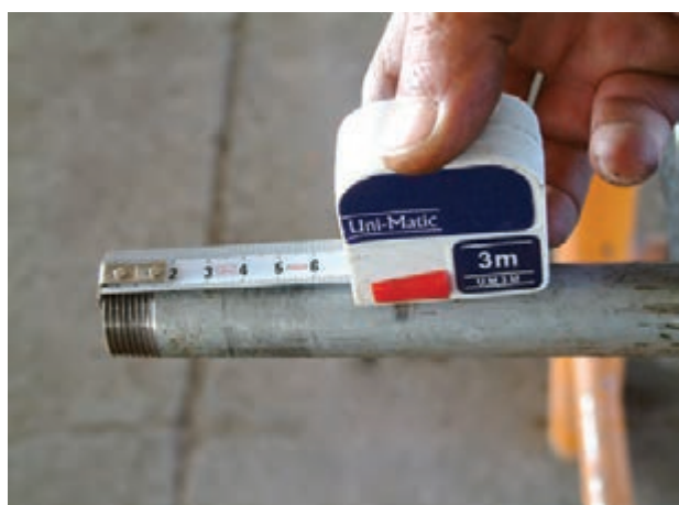
شکل ۱۲۸-۴- اندازه‌گیری لوله‌ی حدیده شده
