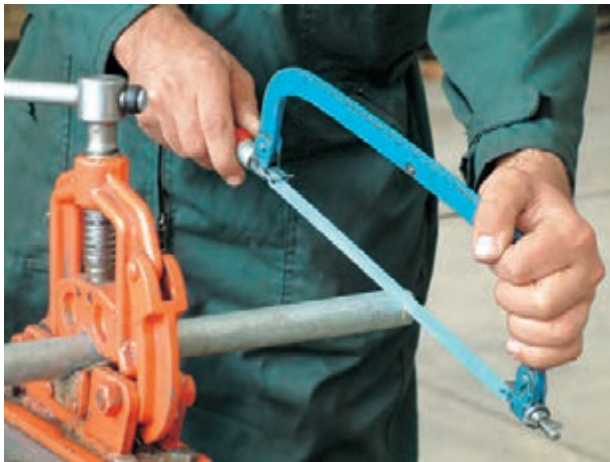
شکل ۵۰-۱- عدم رعایت فاصله‌ی مناسب از لب گیره
