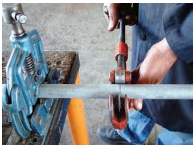
شکل ۱-۶۲- سفت کردن دسته‌ی لوله‌بر به اندازه‌ی لازم
