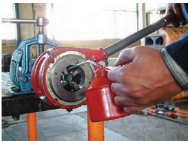
شکل ۴-۱۱۵- استفاده از روغن‌دان در جریان حدیده کاری
