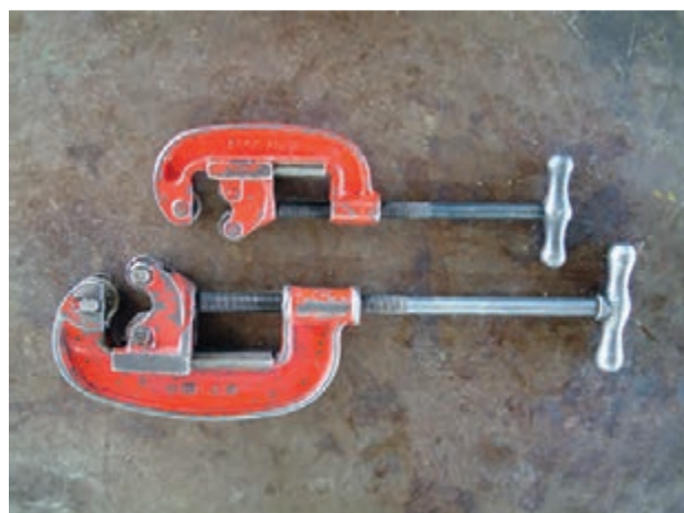
شکل ۱-۶۳- لوله‌بر در دو اندازه‌ی متفاوت
