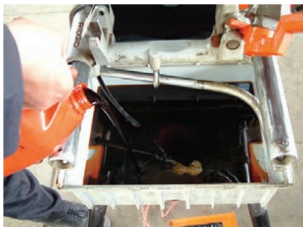
شکل ۴-۸۳- مخزن روغن حدیده‌ی ماشینی
