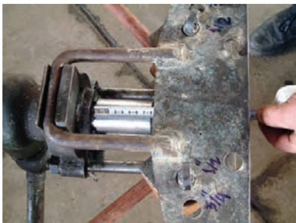
شکل ۳-۲۷- اندازه‌گیری طول پیستون خارج شده از سیلندر
