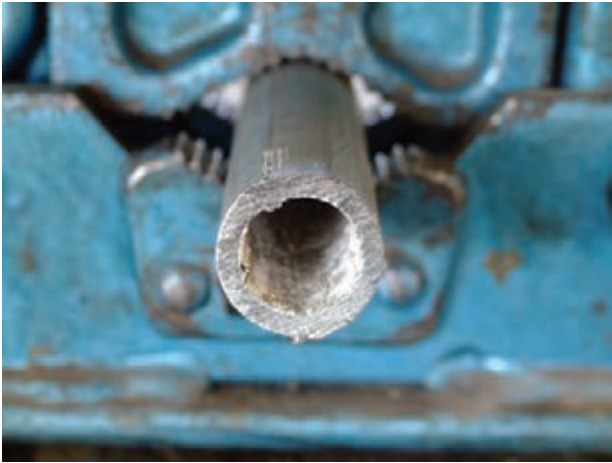
شکل ۵۲-۱- لوله ی بسته شده به گیره ی لوله
