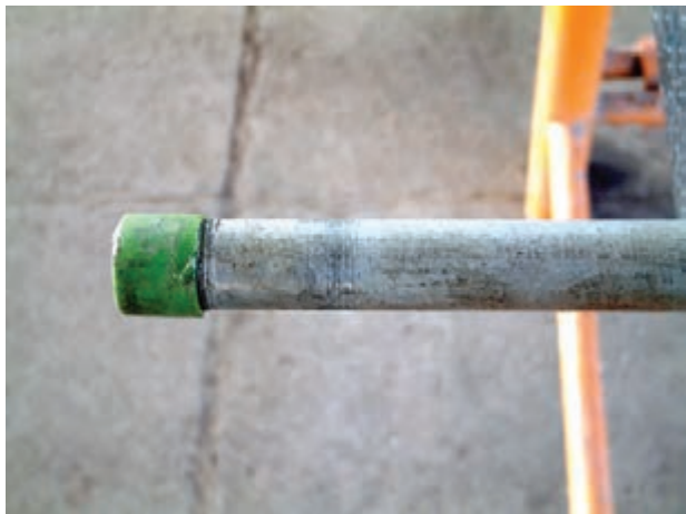
شکل ۱۶-۴ اتصال بوشن پلاستیکی به سردنده‌ی لوله
