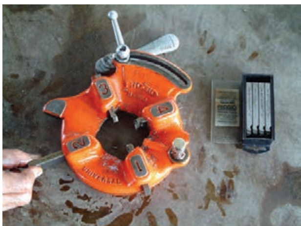
شکل ۴-۹۲ جا زدن پارچه‌ها در شيارهای تنه‌ی حديد
