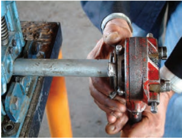
شکل ۴-۳۹ باز کردن فلکهای چهارنظام
