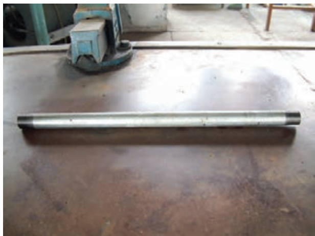
شکل ۱۴۱-۴- لوله‌ی دو سر دنده شده
