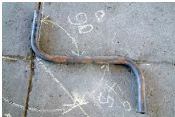
شکل ۳-۴۱- عدم دویدگی لوله‌ی دو خم
