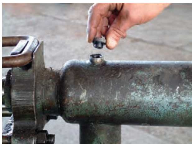
شکل ۱۵-۳ سرپوش مجرای ورودی روغن
