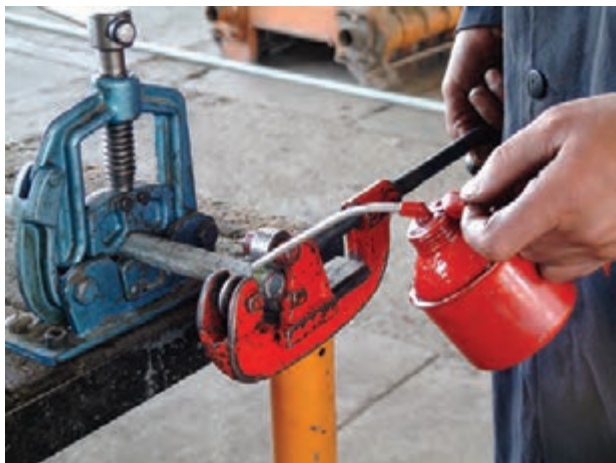
شکل ۱-۵۷- ریختن روغن در محل تماس
