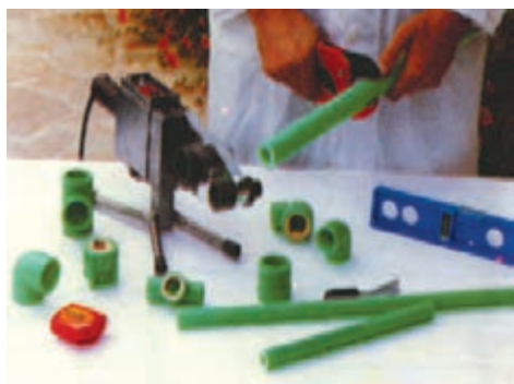
شکل ۲۷-۵- بریدن لوله به وسیله ی قیچی مخصوص
