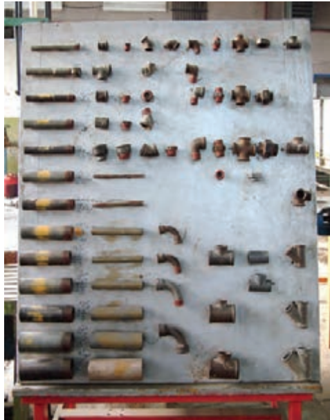
شکل ۳۵-۵- انواع لوله و فیتینگ‌های دنده‌ای
