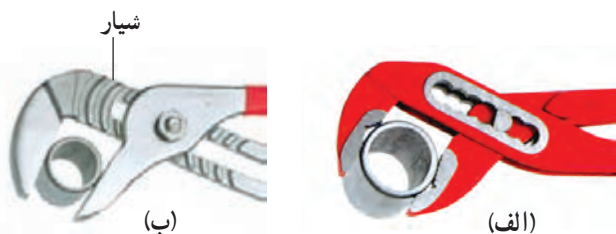
شکل ۵-۷۰- سوراخ‌ها و شیارهای متعدد آچارهای کلاغی
