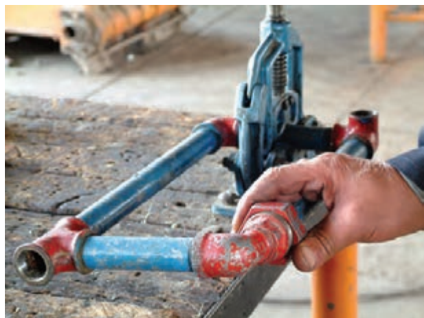
شکل ۵-۱۶۰- بستن مهره ماسوره به وسیله‌ی دست
