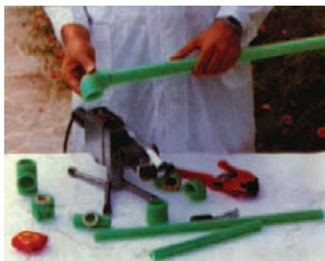
شکل ۲۹-۵- اتصال لوله و فیتینگ پلی‌پروپیلنی پس از خنک شدن
