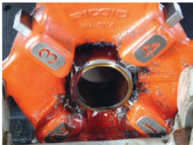
شکل ۴-۸۲- استفاده از روغن در موقع حدیده‌کاری
