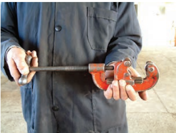
شکل ۵۴-۱- باز کردن دهانه ی لوله بُر
