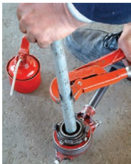
شکل ۱۱۹-۵- گرداندن لوله به وسیله ی آچار لوله گیر دو دسته در جهت حدیده شدن لوله
