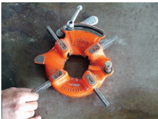
شکل ۴-۹۱ مرحله‌ی اول: ترتيب قرارگيري پارچه‌ها در شيارهای تنه‌ی حديد
