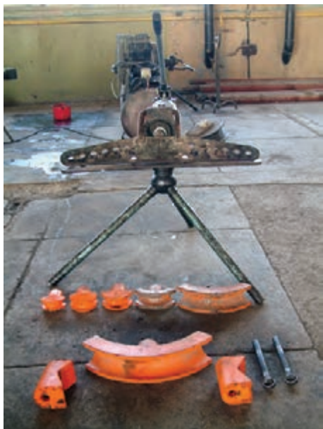
شکل ۱۳-۳ اجزای خم کن هیدرولیکی
