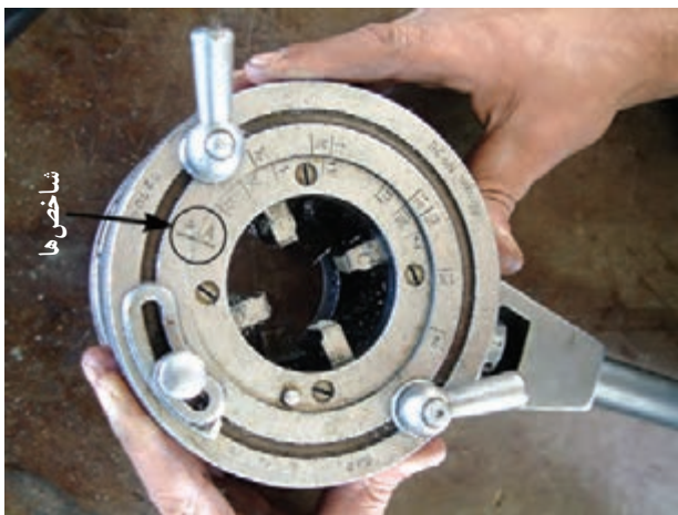
شکل ۴-۵۸- گرداندن رینگ متحرک و قرار دادن شاخص‌های A در یک راستا
