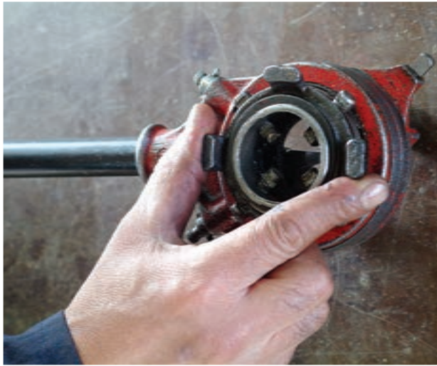
شکل ۴-۲۱- فلکه‌ی چهار نظام حدیده‌ی دستی دو پارچه
