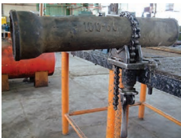
شکل ۱-۳۴- بستن لوله به گیره‌ی زنجیری
