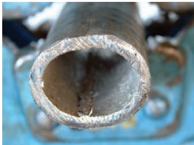
شکل ۱-۶۱- لوله‌ی دو پهن شده
