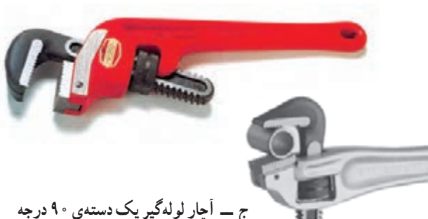
شکل ۵-۶۳- انواع آچار لوله‌گیر یک دسته
