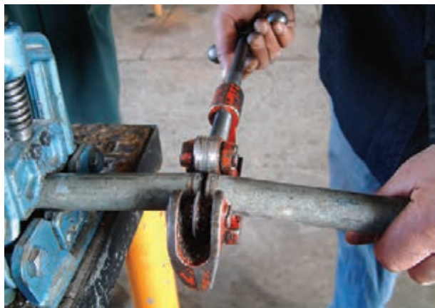
شکل ۳-۵۲- بریدن لوله‌ی محاسبه شده
