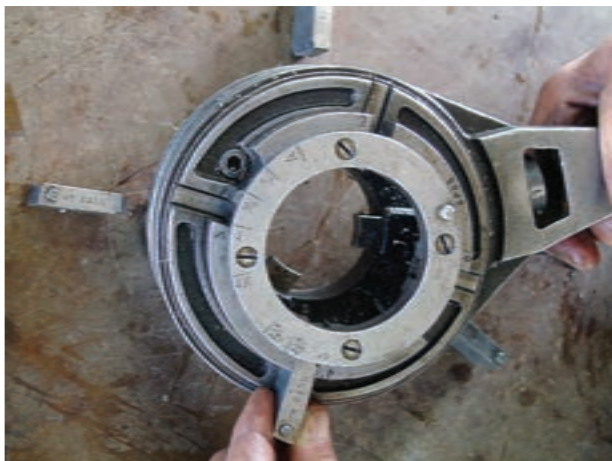
شکل ۴-۵۹- خارج کردن پارچه‌ها از حدیده
