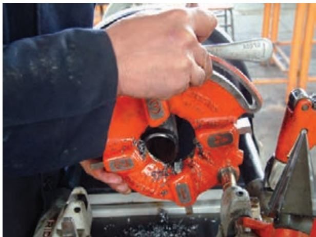
شکل ۴-۹۰ جدا کردن تنه‌ی حديد از دستگاه
