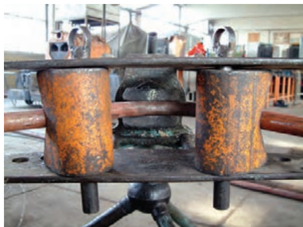
الف- باز کردن خم لوله‌ی خم شده
