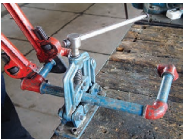
شکل ۵-۱۵۶- بستن ضلع سوم مدار به سهراهی
