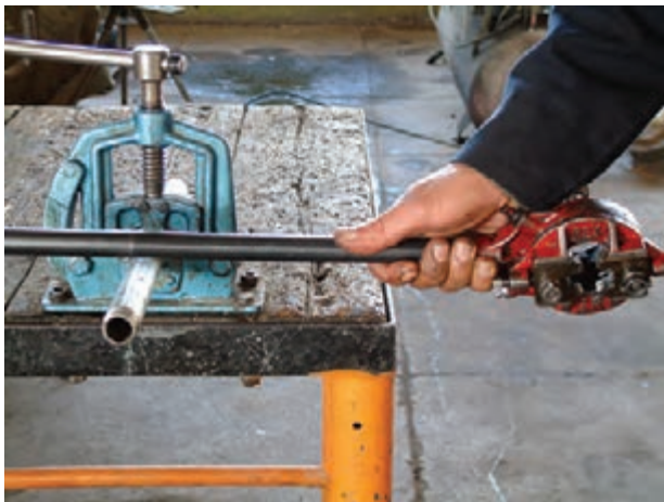
شکل ۴-۴۰ جدا کردن پلیسه‌ها از سر دنده
