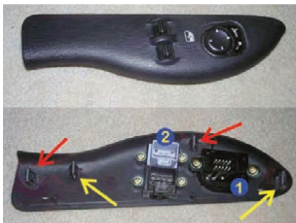
شکل ۱۸۱-۲ - قاب سوئیچ‌های روی پانل در سمت راننده در یک نوع خودرو
