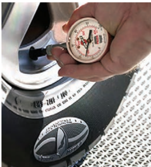
شکل ۱۵۸-۱- کنترل فشار باد تایر
