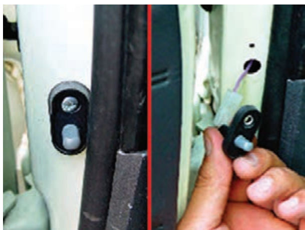
شکل ۱۹۲-۱- باز کردن سوئیچ لای در
