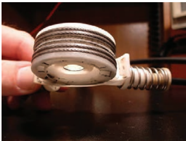
شکل ۲-۱۰۷- پولی اصلی مکانیزم شیشه بالابر یک نوع خودروی سواری
