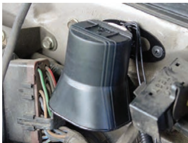
شکل ۵۸-۲ یک نوع آژیر سیستم دزدگیر خودرو
