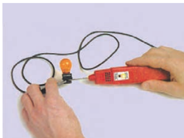
شکل ۱۸۲-۱- آزمایش لامپ چراغ راهنما
