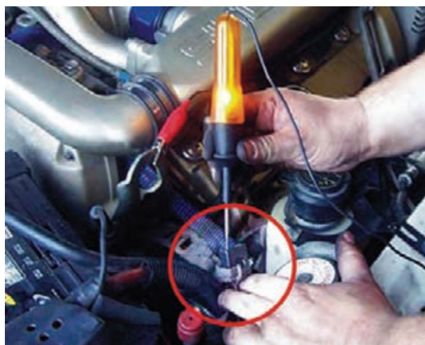
شکل ۱۴۵-۱ آزمایش برقراری جریان مدار چراغ‌های روشنایی
