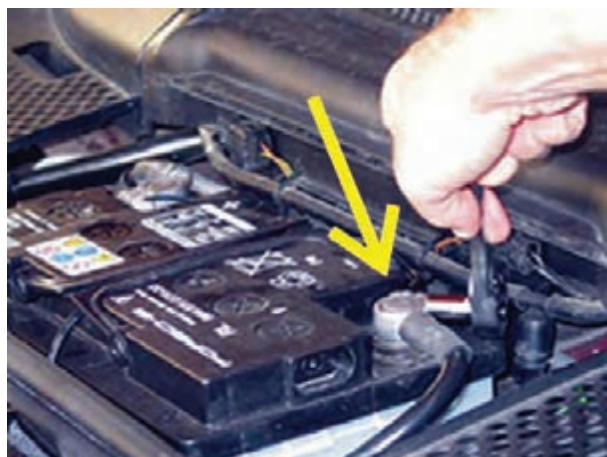
شکل ۱۴۱-۲ باز کردن کابل اتصال بدنه‌ی باتری
