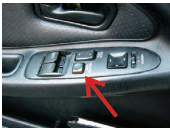
شکل ۱۳۷-۲- سوئیچ قفل کن سیستم شیشه بالابر
