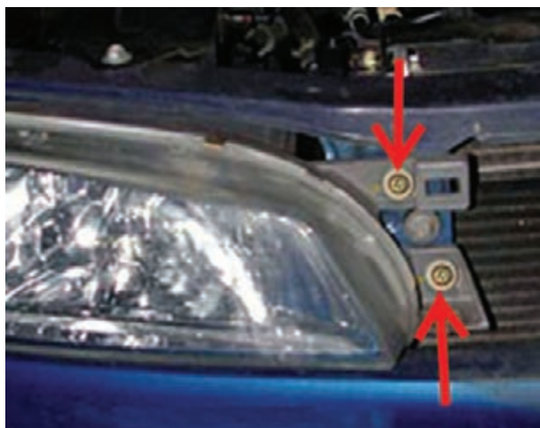
شکل ۱-۴۰- پیچ‌های نگه‌دارنده‌ی چراغ‌های بزرگ جلو
