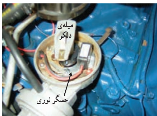
شکل ۱۴۵-۲ سه نمونه حسگر استفاده‌شده در سیستم جرقه‌زنی
