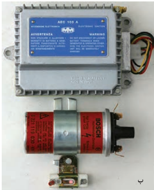
شکل ۲-۱۴۶- دو نمونه سیستم جرقه‌زنی قابل نصب روی انواع خودروها
