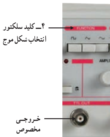
شکل ۲-۱۰۱ کلید سلکتور انتخاب شکل موج
