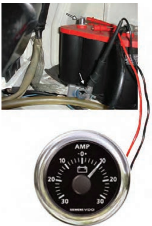
شکل ۱-۵۲ اتصال آمپر متر به صورت سری
