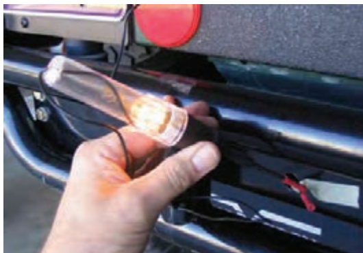
شکل ۸۶-۲ - استفاده از تستر لامپی
