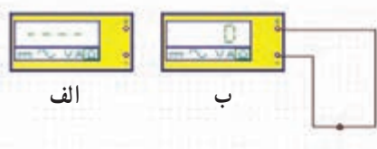
شکل ۲-۷۹ — آزمایش اطمینان از سلامت اهم متر
