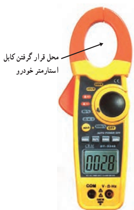
شکل ۲-۹۶- تصویر آمپر متر انبری برای اندازه‌گیری جریان‌های زیاد
